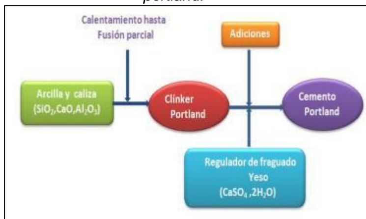
Figura 4. Procedimiento de la elaboración del cemento portland.
