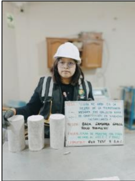
Fotografía N° 143: Testigos cilíndricos con adición del 1.00% fibra de nabo para la resistencia a la compresión de los 7 días de edad, según referencia de la norma NTP 339.034 / ASTM C39.
