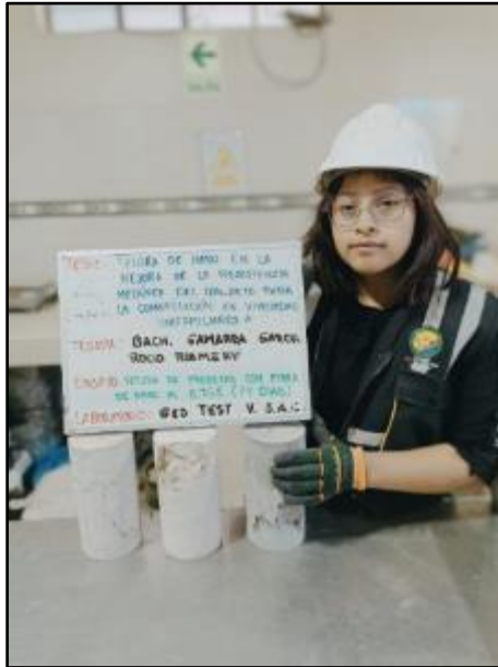
Fotografía N° 129: Testigos cilíndricos con adición del 0.75% fibra de nabo para la resistencia a la compresión de los 14 días de edad, según referencia de la norma NTP 339.034 / ASTM C39.
