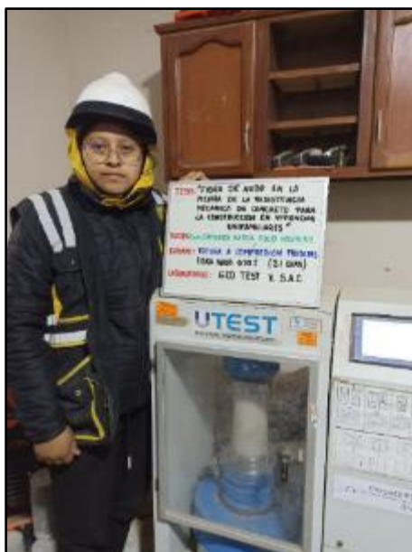
Fotografía N° 130: Testigos cilíndricos con adición del 0.75% fibra de nabo para la resistencia a la compresión de los 21 días de edad, según referencia de la norma NTP 339.034 / ASTM C39.
