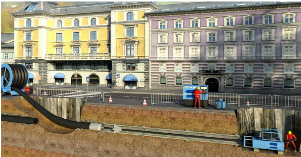
Figura 9. Ilustración del Proceso del Pipe Bursting
