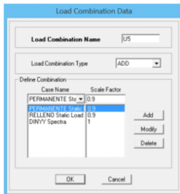
Figura 57 Quinta combinación de carga Fuente: Elaboración propia.
