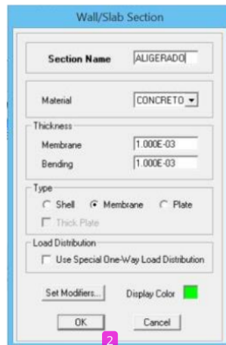
Figura 36 Losa aligerada Fuente: Elaboración propia.
