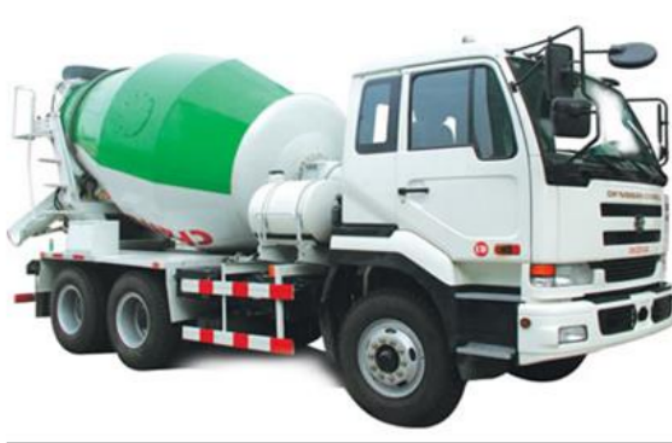
Figura 10- Camión mezcladora de concreto.
