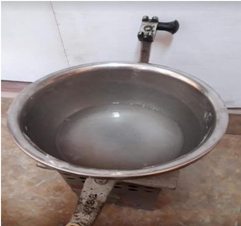
Aplicación del impermeabilizante jabonado de alumbre en la Muestra 02
