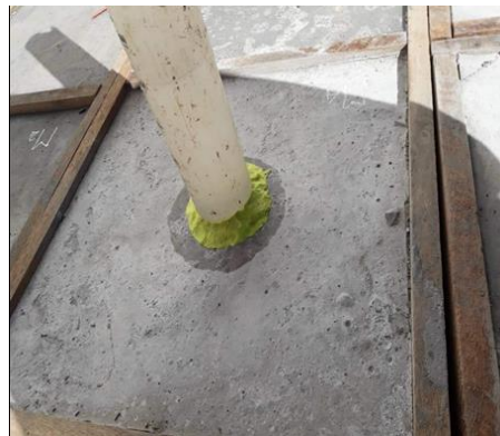
Proceso del ensayo de permeabilidad Muestra 03.
