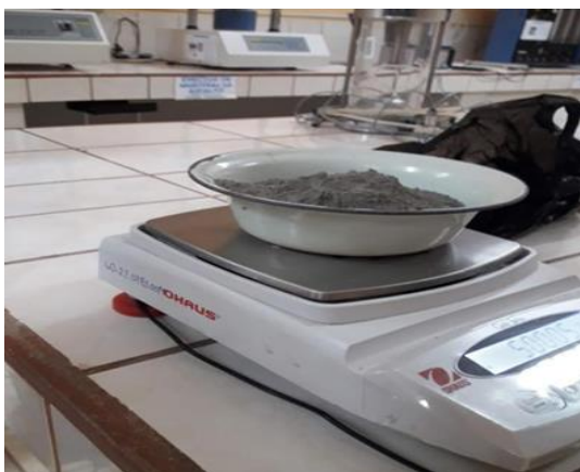
Pesado de cemento
