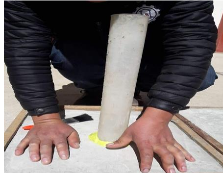
Inicio del ensayo de permeabilidad Muestra 01.
