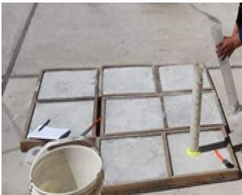
Aplicación de agua para el ensayo de permeabilidad.
