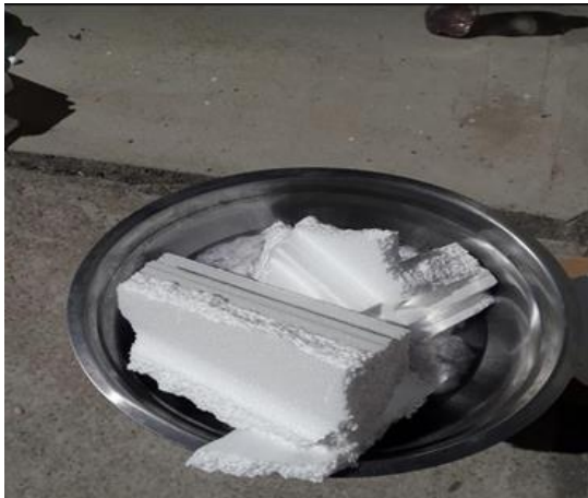
Proceso de disolución del unicel en gasolina.
