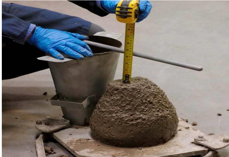
Figura 8 Ensayo de asentamiento con el cono de abrams Fuente: Elaboración propia.
