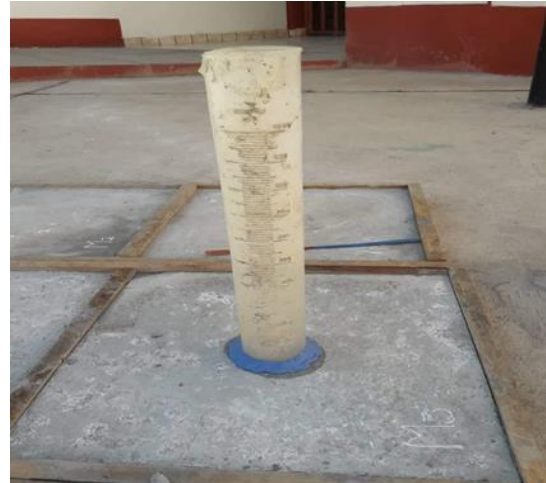
Proceso del ensayo de permeabilidad Muestra 05.
