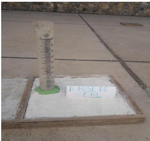
Ensayo de permeabilidad después de la aplicación del impermeabilizante a base de cal
