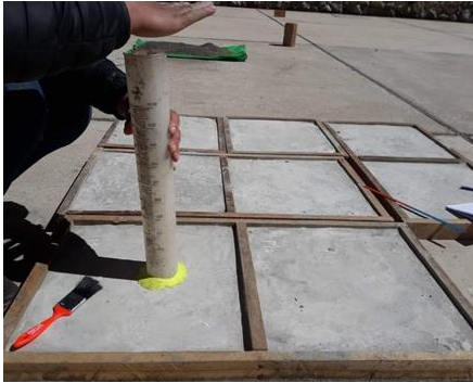
Colocación para el ensayo de permeabilidad Muestra 02.
