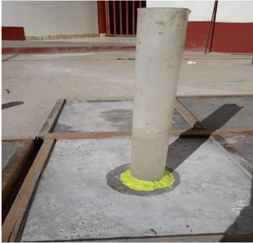
Proceso del ensayo de permeabilidad Muestra 04.
