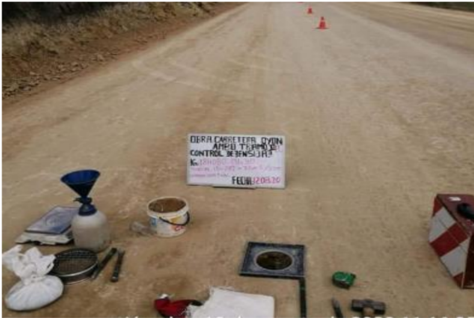
Foto N°34. Conformación de base. Control de Deensidad de Campo.
