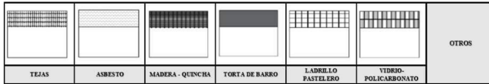
Figura 38: Tipo de material en cubierta
