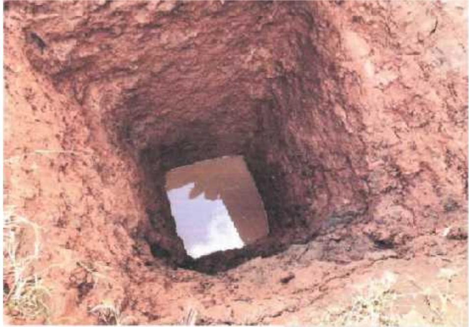
Figura 21 Excavación de la calicata C - 01
