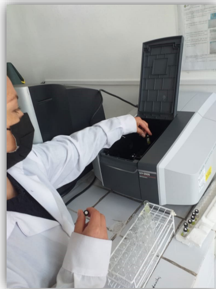
Imagen 08: En la imagen se observa la lectura de método DPPH con la dilución en el espectrofotómetro de las hojas de Marrubium Vulgare L. “Coronilla”, en el laboratorio de la Universidad Nacional del Centro del Perú, Huancayo, Junín.
