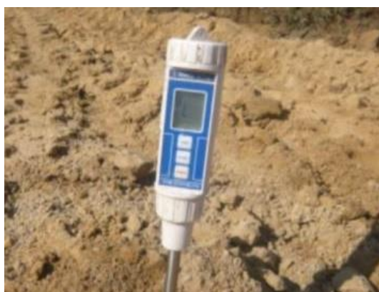
Figura 13: Medición de humedad del suelo de subrasante
