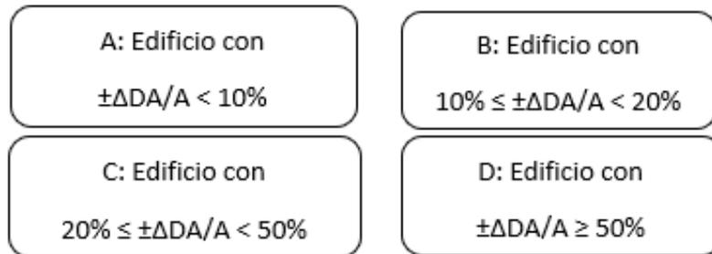
**Figura 22. Rangos de calificación del parámetro 7, albañilería.**
