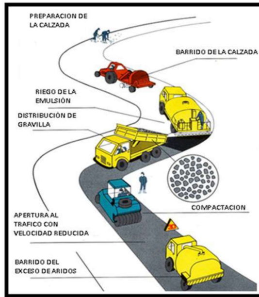
Figura 7 - Esquemática las operaciones de construcción de un tratamiento superficial simple.
