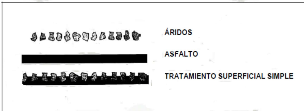
Figura 5 - Esquema de un tratamiento superficial simple.
