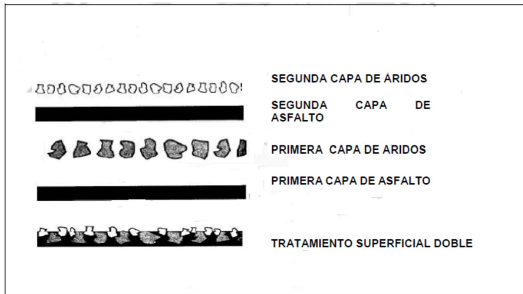
Figura 6 - Esquema de un tratamiento superficial doble.
