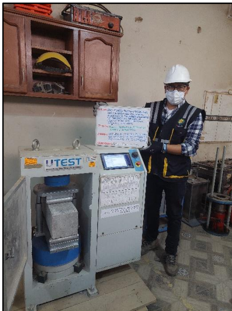
Fotografía N° 86: Testigos cilíndricos incorporados el 2% de escombro reciclado para la resistencia a la flexión de los 28 días de edad, según referencia de la norma NTP 339.034 / ASTM C39.
