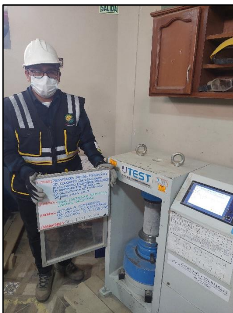
Fotografía N° 78: Testigos cilíndricos incorporados el 6% de escombro reciclado para la resistencia a la compresión de los 28 días de edad, según referencia de la norma NTP 339.034 / ASTM C39.
