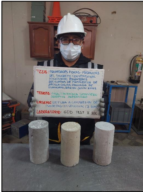
Fotografía N° 57: Testigos cilíndricos convencionales para la resistencia a la compresión de los 7 días de edad, según referencia de la norma NTP 339.034 / ASTM C39.
