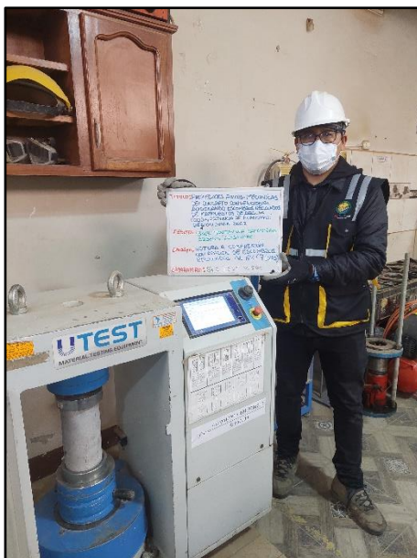
Fotografía N° 74: Testigos cilíndricos incorporados el 6% de escombro reciclado para la resistencia a la compresión de los 7 días de edad, según referencia de la norma NTP 339.034 / ASTM C39.
