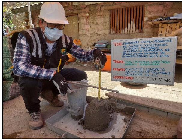
Fotografía N° 28: Medición del asentamiento del concreto fresco con 2% de escombros reciclado. Según NTP 339.035.
