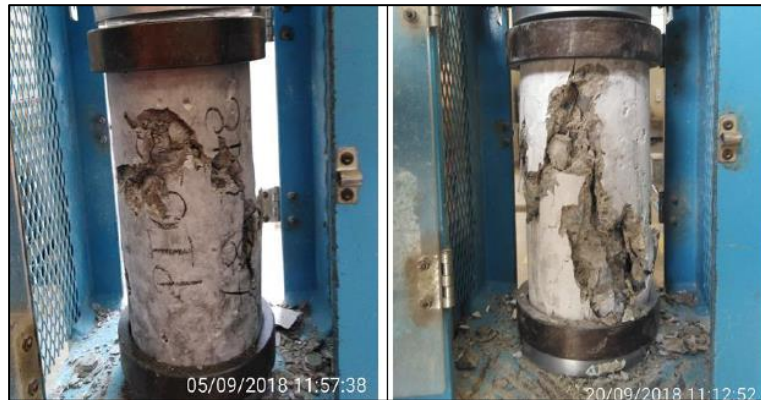
Figura N° 13. Resistencia a la compresión
