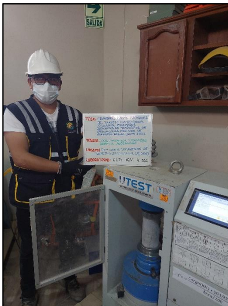
Fotografía N° 58: Testigos cilíndricos convencionales para la resistencia a la compresión de los 14 días de edad, según referencia de la Norma NTP 339.034 / ASTM C39
