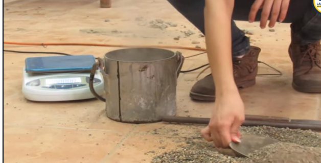
Figura N° 17. Peso unitario del agregado fino
