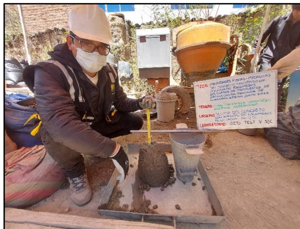
Fotografía N° 40: Medición del asentamiento del concreto fresco con 4% de escombro reciclado, Según NTP 339.035.
