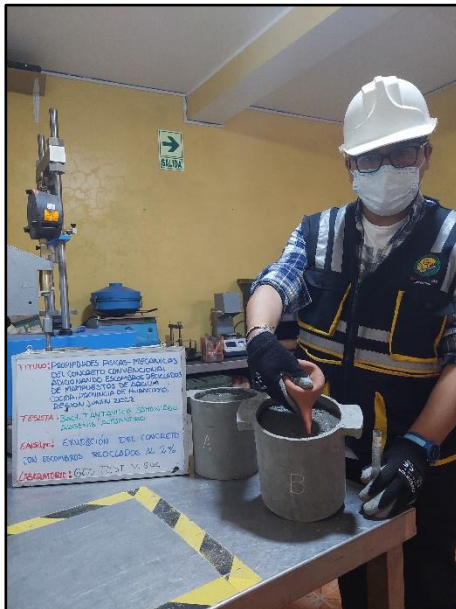
Fotografía N° 30: Control de la exudación del concreto con 2% de escombros reciclados, según referencia de la norma NTP 339.077.
