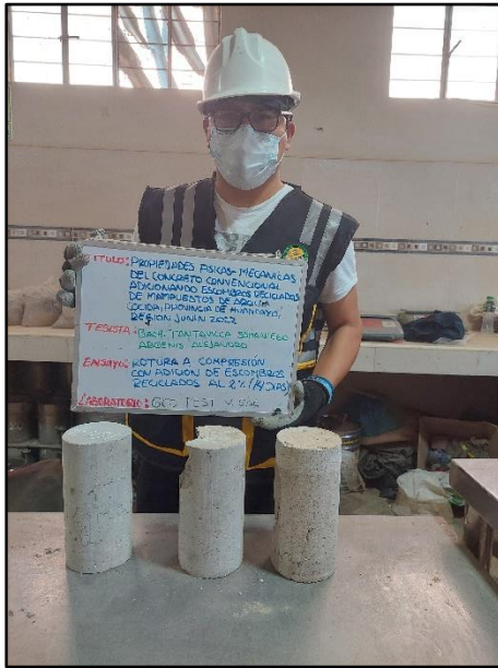
Fotografía N° 65: Testigos cilíndricos incorporados el 2% de escombros reciclados para la resistencia a la compresión de los 14 días de edad, según referencia de la norma NTP 339.034 / ASTM C39.
