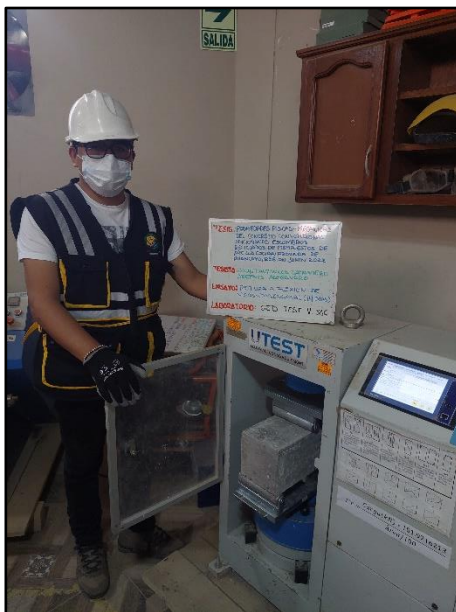
Fotografía N° 80: Testigos verticales convencionales para la resistencia a flexión de los 14 días de edad, según referencia de la norma NTP 339.034 / ASTM C39.
