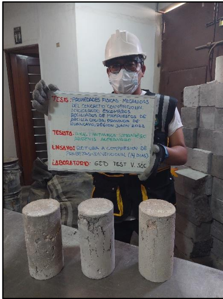
Fotografía N° 59: Testigos cilíndricos convencionales para la resistencia a la compresión de los 14 días de edad, según referencia de la Norma NTP 339.034 / ASTM C39.
