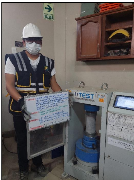
Fotografía N° 76: Testigos cilíndricos incorporados el 6% de escombro reciclado para la resistencia a la compresión de los 14 días de edad, según referencia de la norma NTP 339.034 / ASTM C39.
