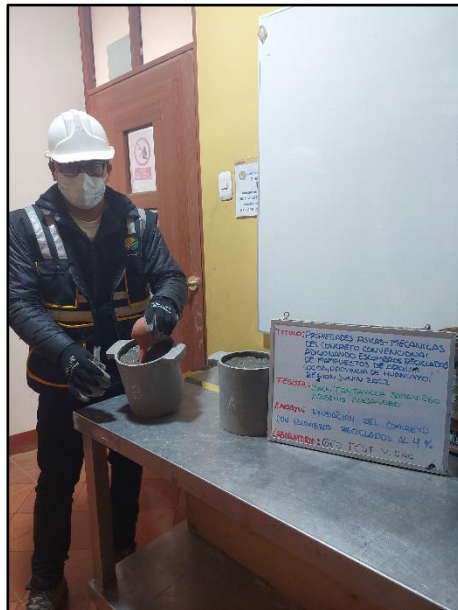
Fotografía N° 43: Control de la exudación del concreto con 4% de escombro reciclado, según referencia de la norma NTP 339.077.
