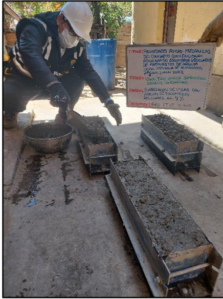
Fotografía N° 45: Elaboración de testigos rectangulares con adición del 4 de escombros reciclados para sus respectivos tipos de ensayos, según referencia de la norma NTP 339.034 / ASTM C39.
