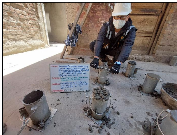
Fotografía N° 44: Elaboración de testigos cilíndricos con adición 4% de escombro reciclado para sus respectivos tipos de ensayos, según referencia de la norma NTP 339.034/ ASTM C39.
