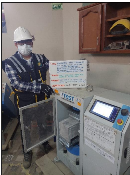
Fotografía N° 82: Testigos verticales convencionales para la resistencia a flexión de los 28 días de edad, según referencia de la norma NTP 339.034 / ASTM C39.
