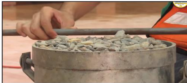
Figura N° 16. Peso unitario del agregado grueso suelto
