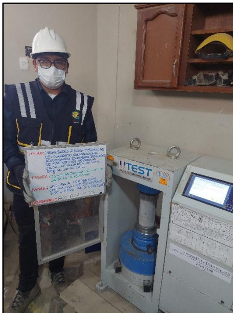
Fotografía N° 66: Testigos cilíndricos incorporados el 2% de escombros reciclados para la resistencia a la compresión de los 28 días de edad, según referencia de la norma NTP 339.034 / ASTM C39.
