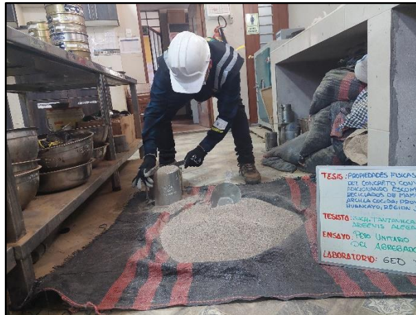
Fotografía N° 7: Determinación del Peso unitario compactado y el porcentaje de los vacíos del agregado grueso , según referencia de la norma NTP 400.017.
