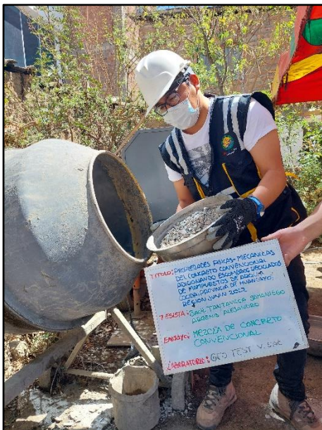
Fotografía N° 12: Vista de materiales tales como el agregado grueso para la elaboración del concreto convencional, según referencia de la norma NTP 339.183.
