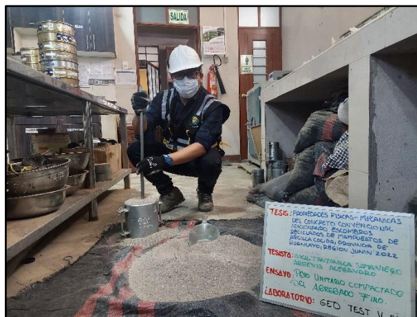
Fotografía N° 8: Determinación del Peso unitario suelto y el porcentaje de los vacíos del agregado fino , Según referencia de la norma NTP 400.017.
