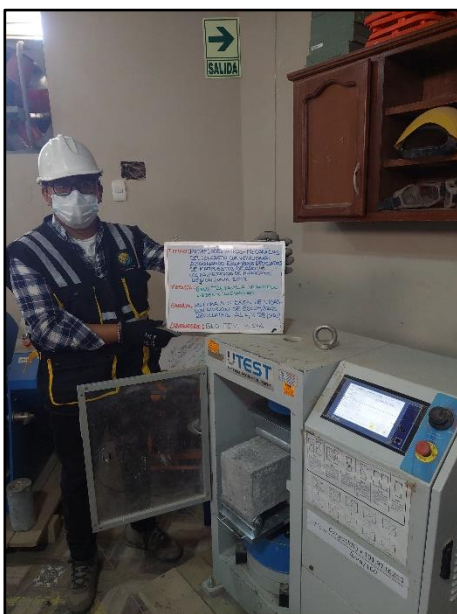
Fotografía N° 90: Testigos cilíndricos incorporados el 4% de escombro reciclado para la resistencia a la flexión de los 28 días de edad, según referencia de la norma NTP 339.034 / ASTM C39.
