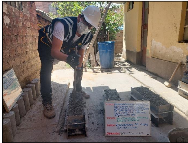
Fotografía N° 21: Elaboración de testigos rectangulares convencionales para sus respectivos tipos de ensayos, según referencia de la norma NTP 339.034/ ASTM C39.
