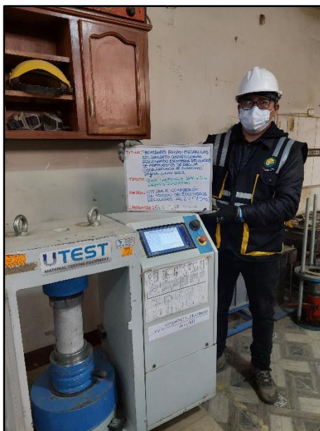
Fotografía N° 62: Testigos cilíndricos incorporados al 2% de escombro reciclado para la resistencia a la compresión de los 7 días de edad, según referencia de la norma NTP 339.034 / ASTM C39.
