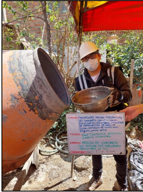
Fotografía N° 37: Vista de materiales tales como el agua para la elaboración del concreto con 4% de escombro reciclado, según referencia de la norma NTP 339.183.
