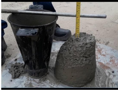
Figura N° 10. Ensayo de asentamiento
