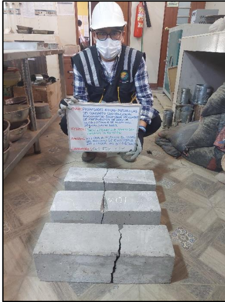
Fotografía N° 95: Testigos cilíndricos incorporados el 6% de escombros reciclado para la resistencia a la flexión de los 28 días de edad, según referencia de la norma NTP 339.034 / ASTM C39.
