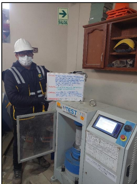
Fotografía N° 68: Testigos cilíndricos incorporados el 4% de escombro reciclado para la resistencia a la compresión de los 7 días de edad, según referencia de la norma NTP 339.034/ ASTM C39.
