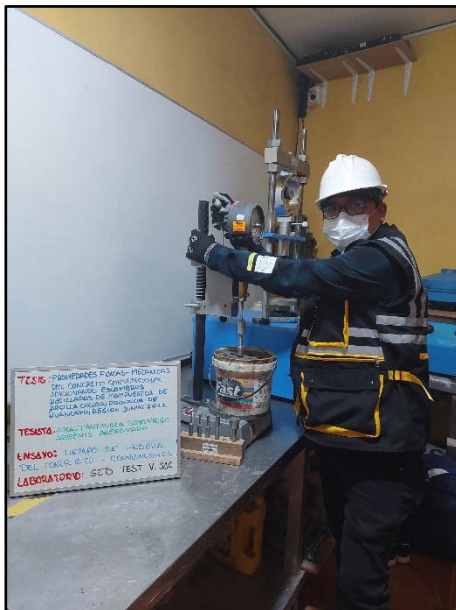
Fotografía N° 18: Control de penetración de diferentes diámetros de agujas para la verificación de tiempo para el fraguado convencional, según referencia de la norma NTP 400.037.
