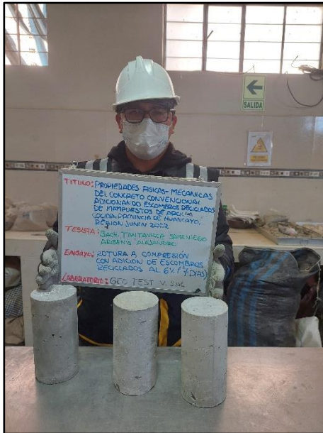
Fotografía N° 75: Testigos cilíndricos incorporados el 6% de escombro reciclado para la resistencia a la compresión de los 7 días de edad, según referencia de la norma NTP 339.034 / ASTM C39.
