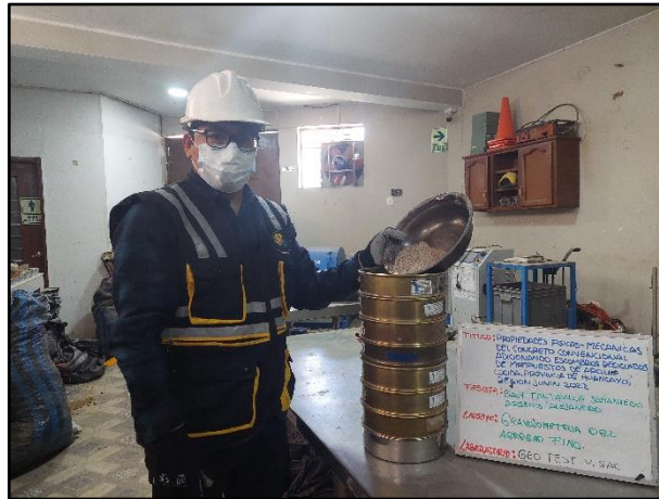
Fotografía N°1: Ensayo de análisis granulométrico del agregado fino, según referencia de la norma NTP 400.012.
