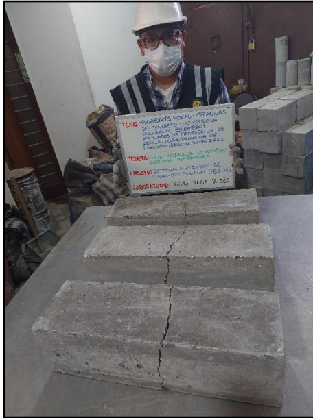
Fotografía N° 83: Testigos cilíndricos convencionales para la resistencia a flexión de los 28 días de edad, según referencia de la norma NTP 339.034 / ASTM C39.
