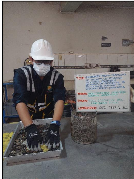
Fotografía N° 5: Realización del ensayo para determinar el Método de ensayo normalizado para peso específico y absorción del agregado grueso, según referencia de la norma NTP 400.022.
