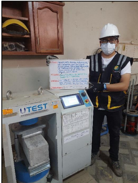
Fotografía N° 92: Testigos cilíndricos incorporados el 6% de escombros reciclados para la resistencia a la flexión de los 14 días de edad, según referencia de la norma NTP 339.034 / ASTM C39.
