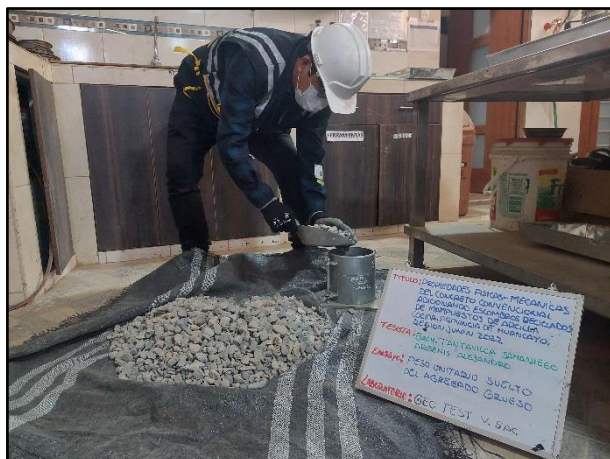
Fotografía N° 9: Determinación del Peso unitario compactado y el porcentaje de los vacíos del agregado grueso , según referencia de la norma NTP 400.017.
