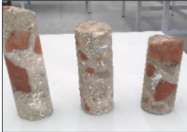
Figura N° 8. Extracción de núcleos de mampostería cocida
