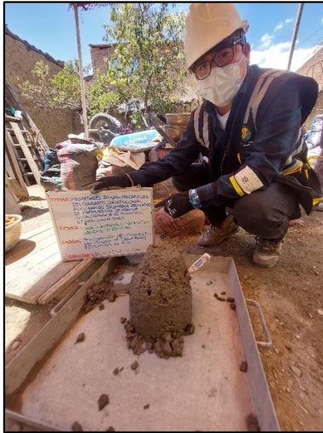
Fotografía N° 51: Medición de la temperatura del concreto saliendo de la mezcladora con adición del 6% de escombros reciclados, según referencia de la norma NTP 339.184.
