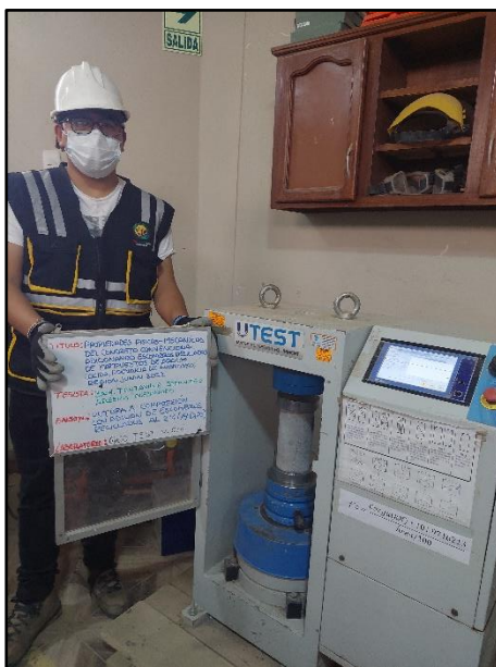
Fotografía N° 64: Testigos cilíndricos incorporados 2% de escombros reciclados para la resistencia a la compresión de los 14 días de edad, según referencia de la norma NTP 339.034 / ASTM C39.
