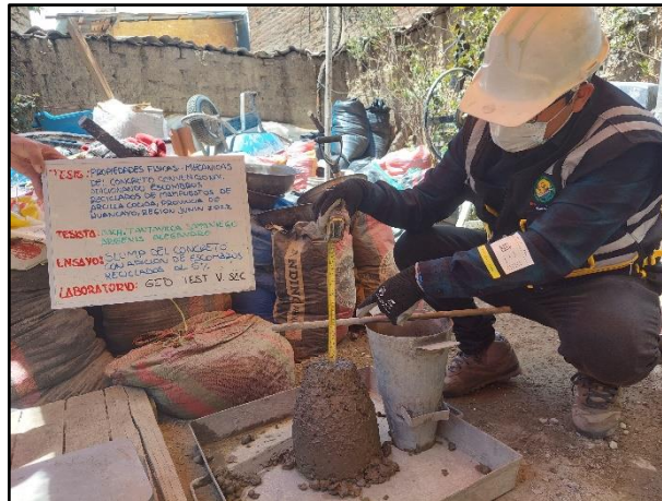
Fotografía N° 52: Medición del asentamiento del concreto fresco con adición del 6% de escombros reciclados. Según NTP 339.035.
