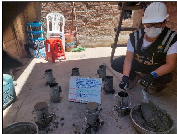
Fotografía N° 20: Elaboración de testigos cilíndricos convencional para sus respectivos tipos de ensayos, según referencia de la norma NTP 339.034 / ASTM C39.
