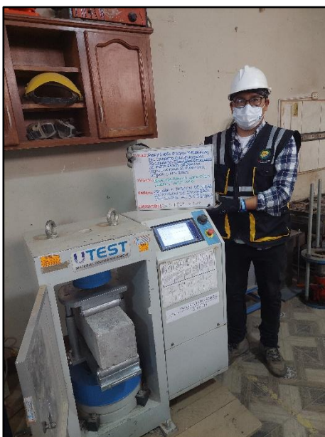
Fotografía N° 94: Testigos cilíndricos incorporados el 6% de escombro reciclado para la resistencia a la flexión de los 28 días de edad, según referencia de la norma NTP 339.034 / ASTM C39.
