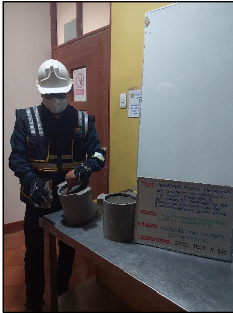
Fotografía N° 17: Control de la exudación del concreto convencional, según referencia de la norma NTP 339.077.
