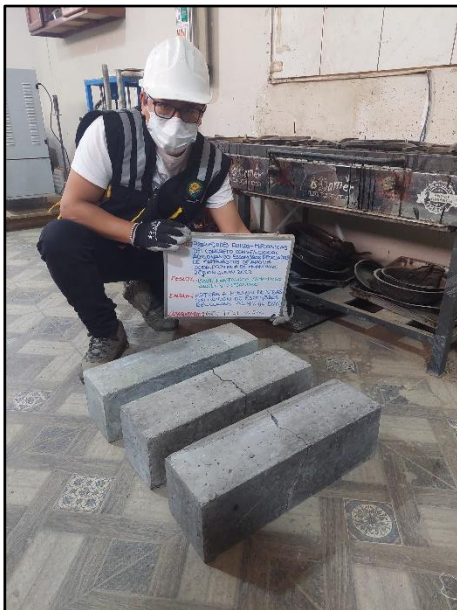
Fotografía N° 89: Testigos cilíndricos incorporados el 4% de escombro reciclado para la resistencia a la flexión de los 14 días de edad, según referencia de la norma NTP 339.034 / ASTM C39.
