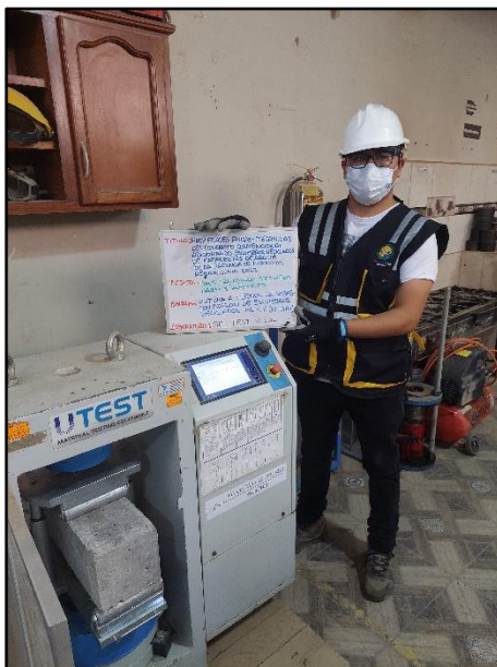
Fotografía N° 88: Testigos cilíndricos incorporados el 4% de escombro reciclado para la resistencia a la flexión de los 14 días de edad, según referencia de la norma NTP 339.034 / ASTM C39.
