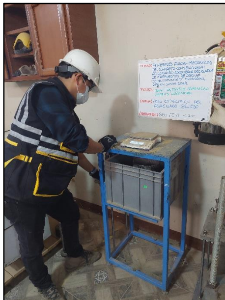
Fotografía N° 6: Peso del agregado sumergido en la canastilla normalizado, con la temperatura del agua de 23°C, según referencia de la norma NTP 400.022.
