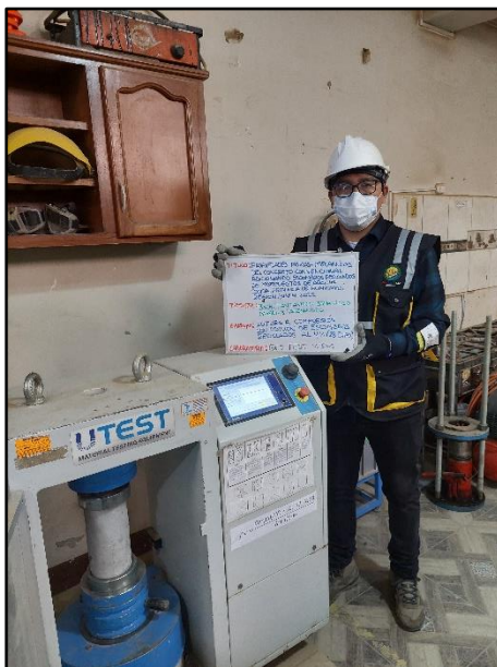
Fotografía N° 72: Testigos cilíndricos incorporados el 4% de escombro reciclado para la resistencia a la compresión de los 28 días de edad, según referencia de la norma NTP 339.034/ ASTM C39.
