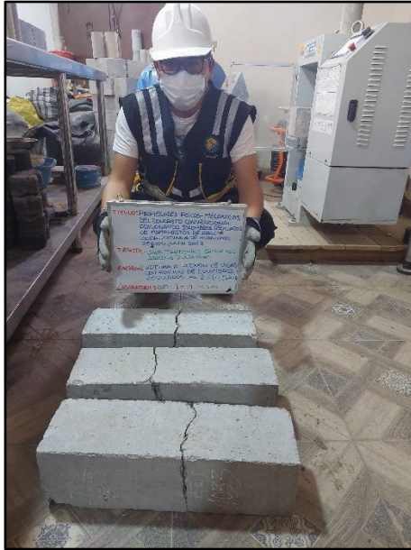
Fotografía N° 85: Testigos cilíndricos incorporados el 2% de escombro reciclado para la resistencia a la flexión de los 14 días de edad, según referencia de la norma NTP 339.034 / ASTM C39.
