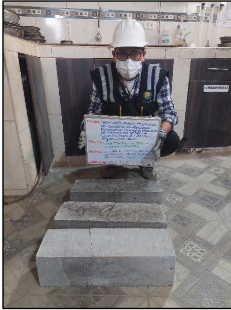
Fotografía N° 91: Testigos cilíndricos incorporados el 4% de escombros reciclados para la resistencia a la flexión de los 28 días de edad, según referencia de la norma NTP 339.034 / ASTM C39.
