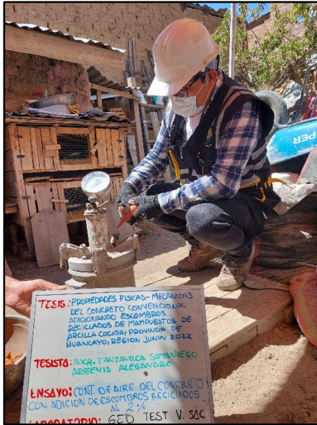
Fotografía N° 29: Control del contenido de aire del concreto fresco con 2% de escombros reciclados por el método de presión. Según NTP 339.083.
