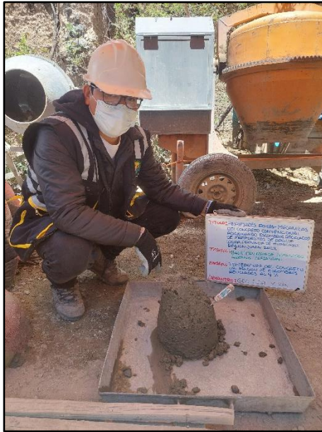
Fotografía N° 39: Medición de la temperatura del concreto saliendo de la mezcladora con 4% de escombro reciclado, según referencia de la norma NTP 339.184.
