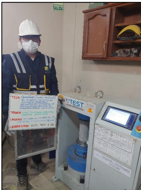
Fotografía N° 60: Testigos cilíndricos incorporados el 2% de escombros reciclados para la resistencia a la compresión de los 28 días de edad, según referencia de la norma NTP 339.034 / ASTM C39.
