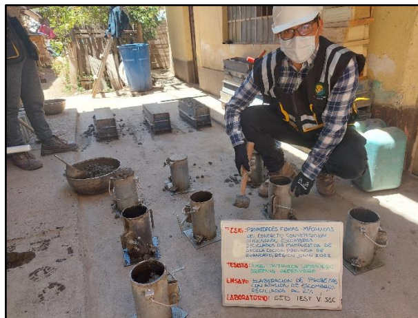
Fotografía N° 32: Elaboración de testigos cilíndricos con 2% de escombro reciclado para sus respectivos tipos de ensayos, según referencia de la norma NTP 339.034 / ASTM C39.
