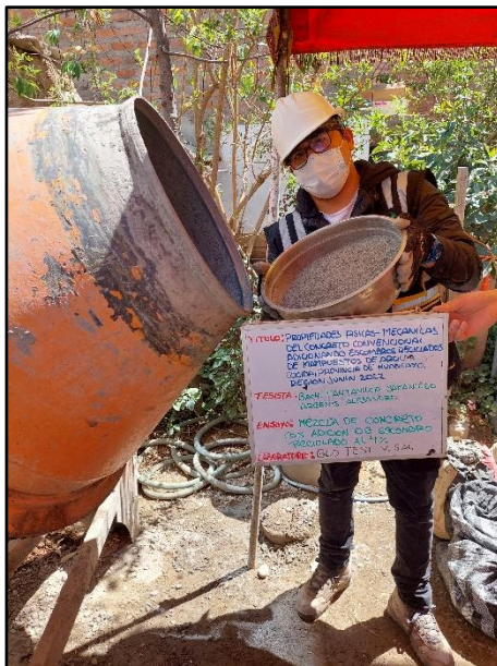
Fotografía N° 34: Vista de materiales tales como el cemento para la elaboración del concreto con 4% de escombro reciclado, según referencia de la norma NTP 339.183.
