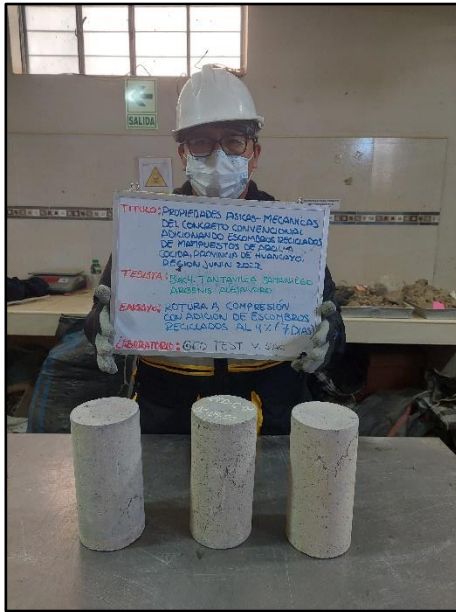
Fotografía N° 69: Testigos cilíndricos incorporados el 4% de escombro reciclado para la resistencia a la compresión de los 7 días de edad, según referencia de la norma NTP 339.034 / ASTM C39.
