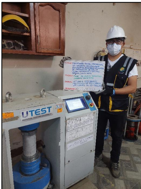
Fotografía N° 70: Testigos cilíndricos incorporados el 4% de escombro reciclado para la resistencia a la compresión de los 14 días de edad, según referencia de la norma NTP 339.034 / ASTM C39.
