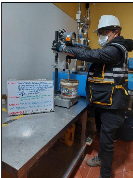
Fotografía N° 42: Control de penetración de diferentes diámetros de agujas para la verificación de tiempo para el fraguado con 4% de escombros reciclados, según referencia de la norma NTP 400.037.
