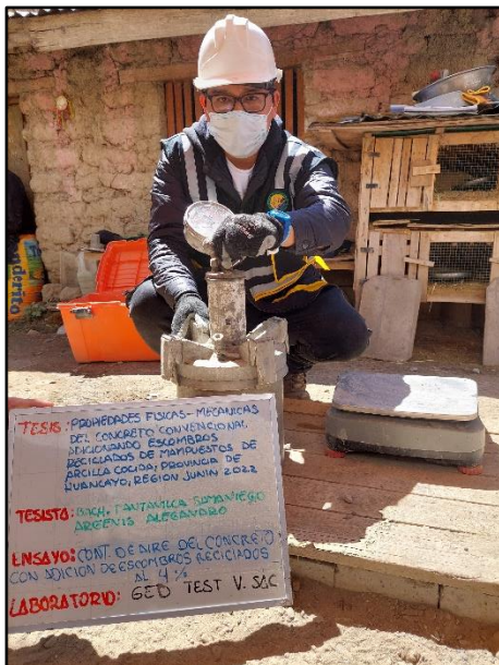
Fotografía N° 41: Control del contenido de aire del concreto fresco con 4% de escombros reciclados por el método de presión. Según NTP 339.083.
