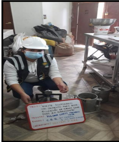
Fotografía 10, Fotografía 11. Ensayo de CBR con ADICION DEL 2% de cemento y 0.4 ml. De aceite sulfonado.
