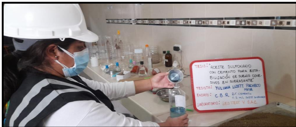
Fotografía 8, Fotografía 9. Ensayo de CBR con ADICION DEL 2% de cemento y 0.3 ml. De aceite sulfonado.
