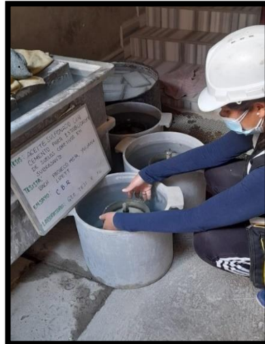
Fotografía 6, Fotografía 7. Ensayo de CBR CONVENCIONAL de acuerdo a la NTP 339.145-CBR
