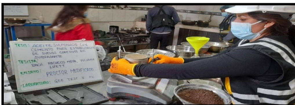
Fotografía 5, Desarrollo del ensayo de PROCTOR MODIFICADO CONVENCIONAL de acuerdo a la NTP339.141 1999
