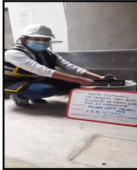
Fotografía 10, Fotografía 11. Ensayo de CBR con ADICION DEL 2% de cemento y 0.4 ml. De aceite sulfonado.
