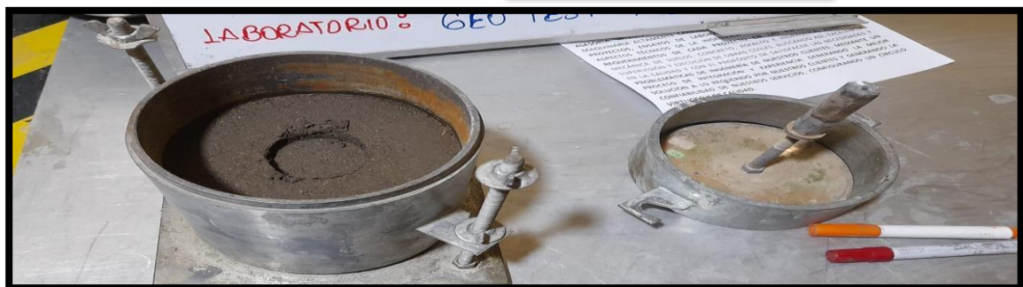
Fotografía 12, Fotografía 13, Fotografía 14. Ensayo de CBR con ADICION DEL 2% de cemento y 0.5 ml. De aceite sulfonado.
