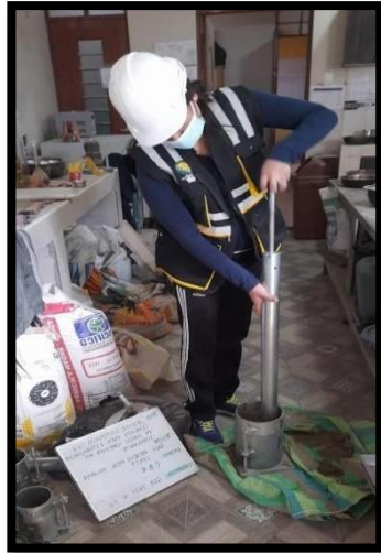
Fotografía 6, Fotografía 7. Ensayo de CBR CONVENCIONAL de acuerdo a la NTP 339.145-CBR
