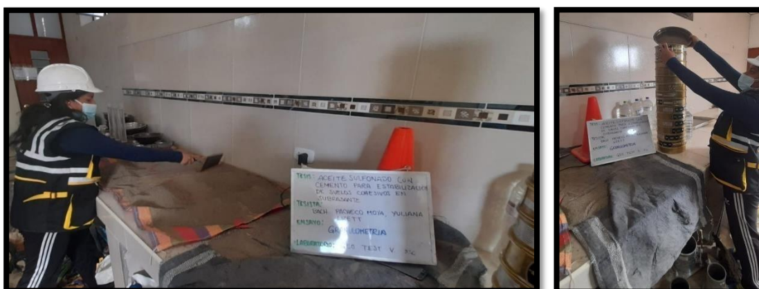
Fotografía 3, Fotografía 4. Análisis granulométrico de suelos según NTP: 339.128
