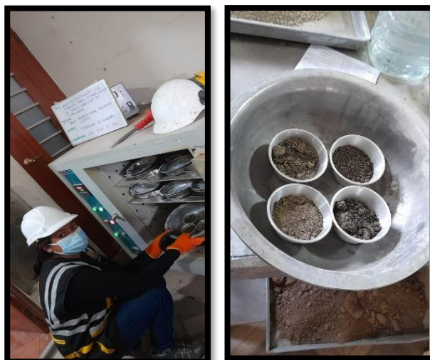
Fotografía 1, Fotografía 2: Determinación del contenido de Humedad de suelos NTP 339.127
