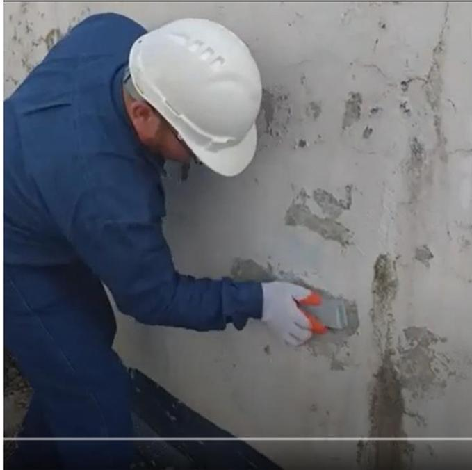
Figura 8 Puliendo el área de ensayo
