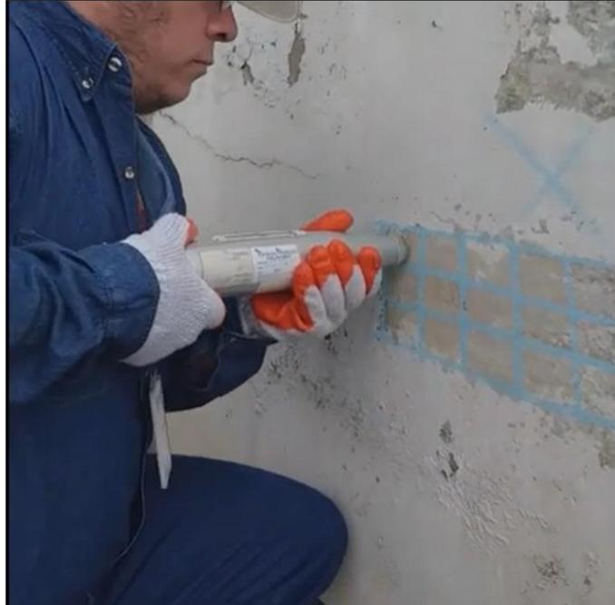
Figura 10 Realizando el impacto con el esclerómetro
