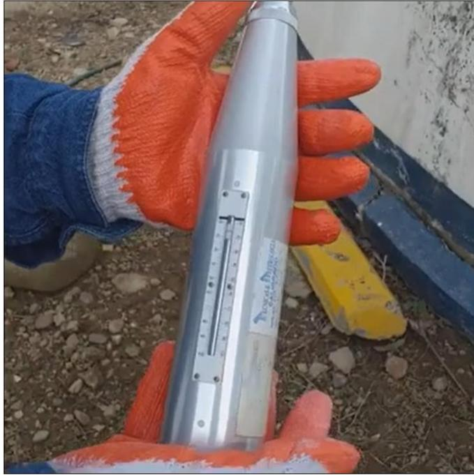
Figura 12 Esclerómetro PCE-HT-75 utilizado en esta investigación
