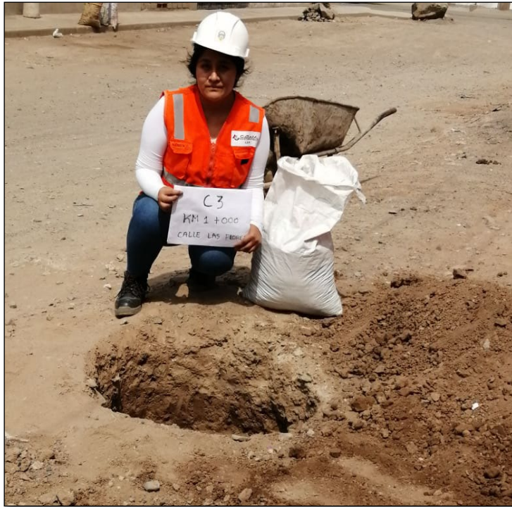
Fotografía 3: Extracción de muestra del progresivo km 1+000
