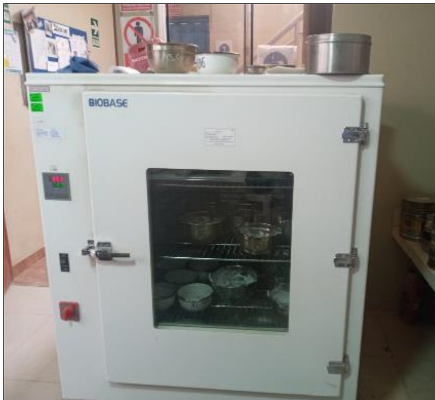
Fotografía 6. Secado de muestra en el horno.
