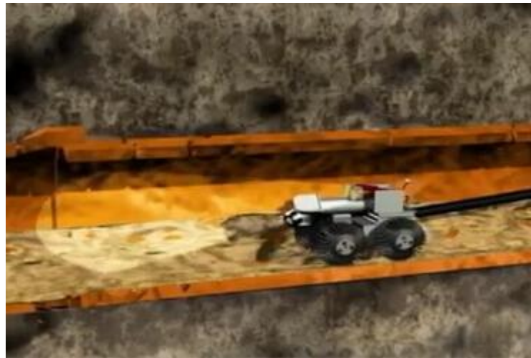
Figura 53 Video Inspección CCTV
