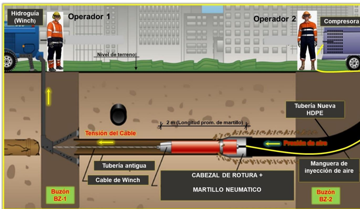
Figura 8 Esquema método cracking dinámico
