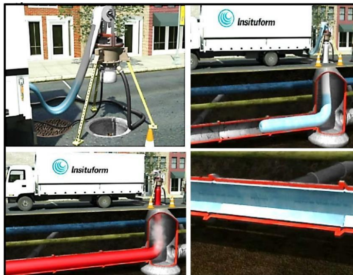
Figura 10 Esquema método tubería polimerizada in situ
