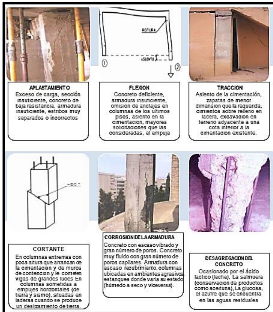
Figura 1 Fallas comunes en columnas Fuente: Modificado de (Torrealva, D., 2007)
