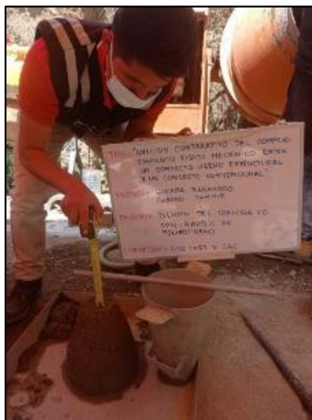
Fotografía N° 30: Medición del asentamiento del concreto con adición de poliestireno expandido al 0.025%. Según NTP 339.035.
