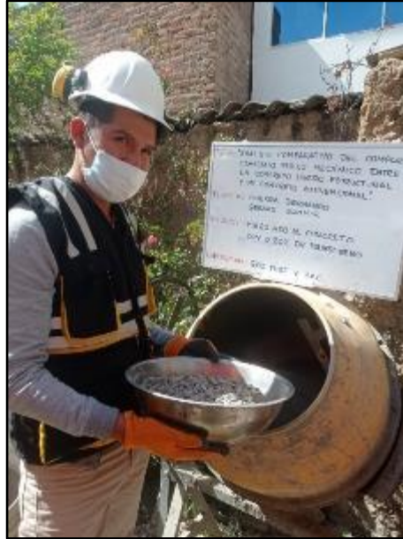
Fotografía N° 59: Vista de materiales tales como agregado grueso para la elaboración del concreto con adición de poliestireno expandido al 0.20%. Según NTP 339.183.
