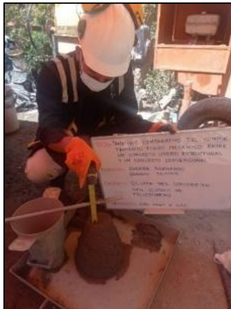
Fotografía N° 42: Medición del asentamiento del concreto con adición de poliestireno expandido al 0.05%. Según NTP 339.035.
