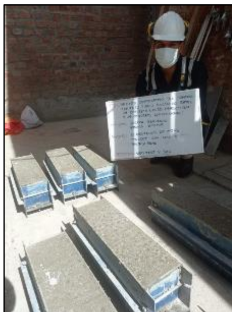
Fotografía N° 58: Elaboración de vigas de concreto con adición de poliestireno expandido al 0.10%. Según NTP 339.183.
