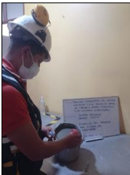
Fotografía N° 32: Control de la exudación del concreto con adición de poliestireno expandido al 0.025%. Según NTP 339.077
