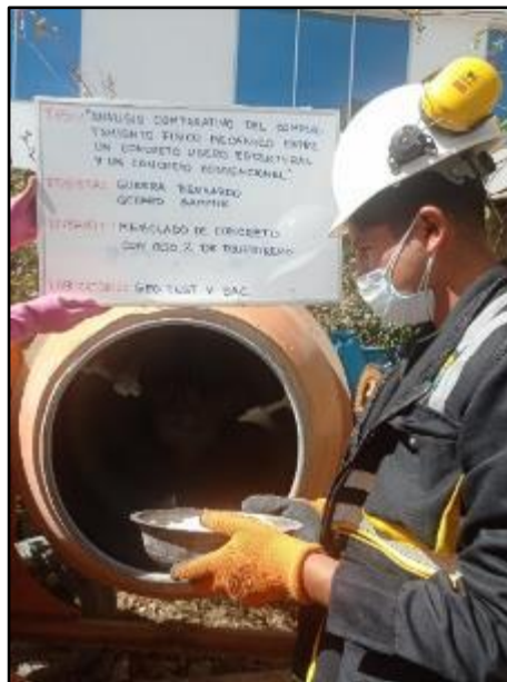
Fotografía N° 40: Vista de materiales tales como poliestireno expandido al 0.050%. Según NTP 339.183
