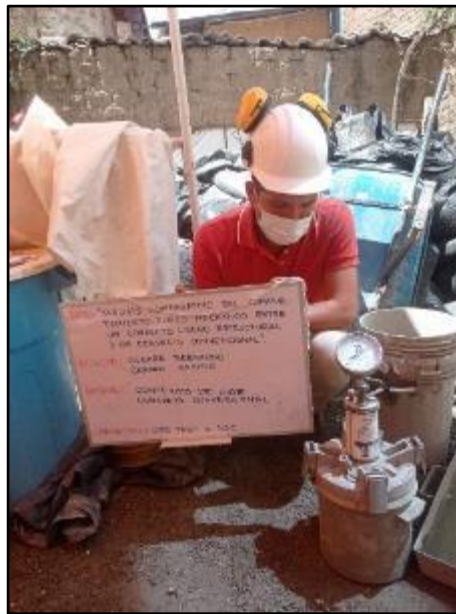
Fotografía N° 19: Control del contenido de aire del concreto fresco convencional por el método de presión. Según NTP 339.083.
