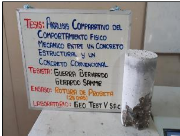
Fotografía N° 73: Tipo de falla del ensayo resistencia a la compresión de probetas del concreto convencional a los 28 días de edad. Según NTP 339.034.
