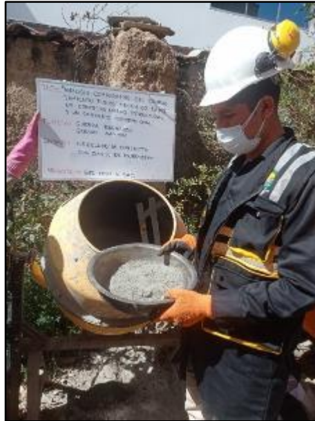
Fotografía N° 49: Vista de materiales tales como cemento para la elaboración del concreto con adición de poliestireno expandido al 0.10%. Según NTP 339.183.
