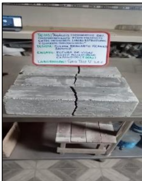
Fotografía N° 89: Mediciones de las caras fracturadas para ubicar la línea de fractura del ensayo resistencia a la flexión de vigas del concreto con adición del 0.025% a los 7 días de edad. Según NTP 339.078.
