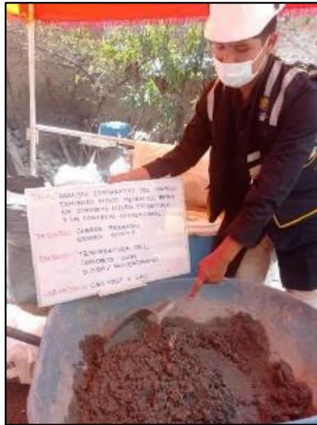
Fotografía N° 41: Medición de la temperatura del concreto con adición de poliestireno expandido al 0.05%. Según NTP 339.184
