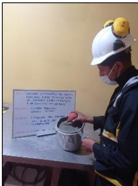
Fotografía N° 55: Control de la exudación del concreto con adición de poliestireno expandido al 0.10%. Según NTP 339.077
