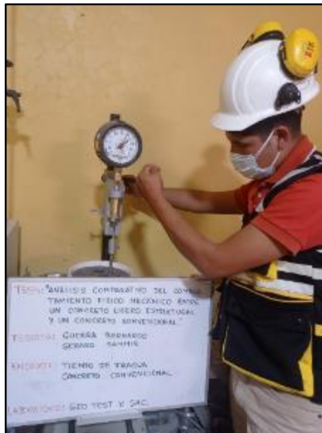
Fotografía N° 21: Lectura del tiempo de fraguado del concreto convencional. Según NTP 339.082.
