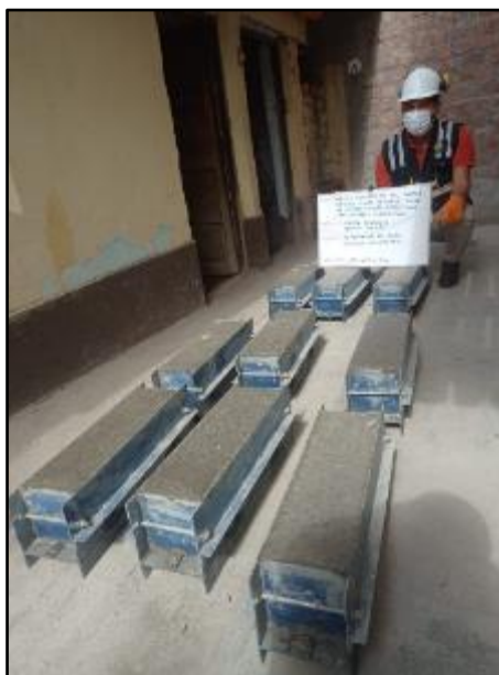
Fotografía N° 23: Elaboración de vigas de concreto convencional. Según NTP 339.183.
