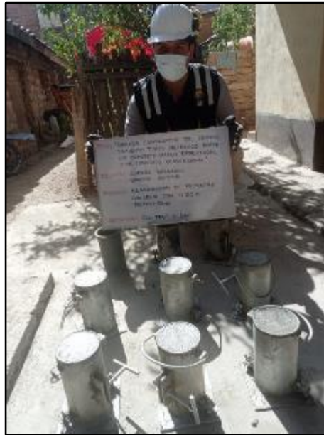
Fotografía N° 69: Elaboración de probetas cilíndricas de concreto con adición de poliestireno expandido al 0.20%. Según NTP 339.183.
