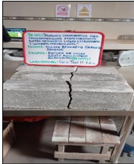
Fotografía N° 91: Mediciones de una de las caras fracturadas para ubicar la línea de fractura del ensayo resistencia a la flexión de vigas del concreto con adición del 0.025% a los 28 días de edad. Según NTP 339.078.
