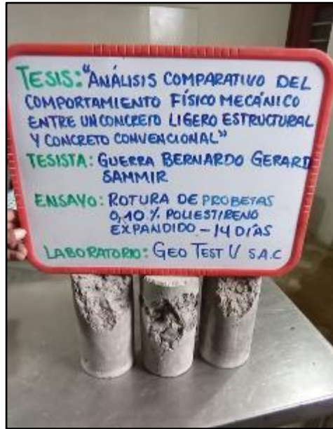
Fotografía N° 81: Tipo de falla del ensayo resistencia a la compresión de probetas del concreto con la adición de 0.10% de poliestireno expandido a los 14 días de edad. Según NTP 339.034
