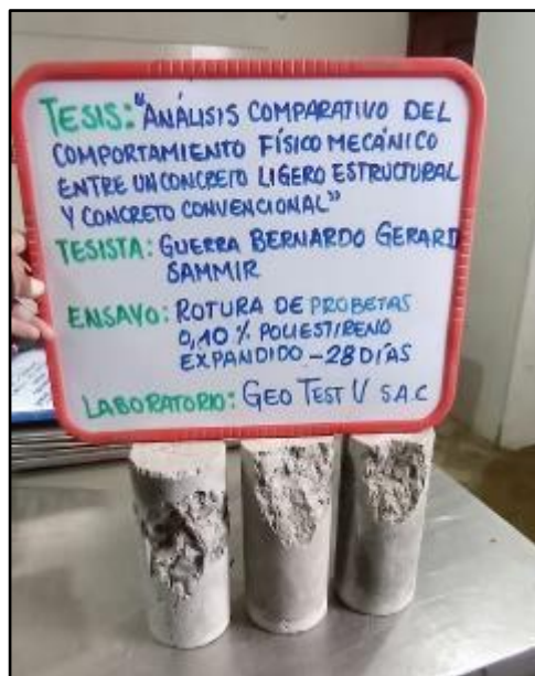
Fotografía N° 82: Tipo de falla del ensayo resistencia a la compresión de probetas del concreto con la adición de 0.10% de poliestireno expandido a los 28 días de edad. Según NTP 339.034.
