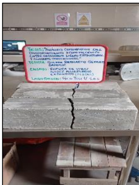
Fotografía N° 90: Mediciones de una de las caras fracturadas para ubicar la línea de fractura del ensayo resistencia a la flexión de vigas del concreto con adición del 0.025% a los 14 días de edad. Según NTP 339.078.
