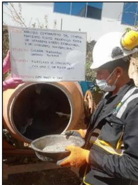
Fotografía N° 38: Vista de materiales tales como cemento para la elaboración del concreto con adición de poliestireno expandido al 0.050%. Según NTP 339.183.
