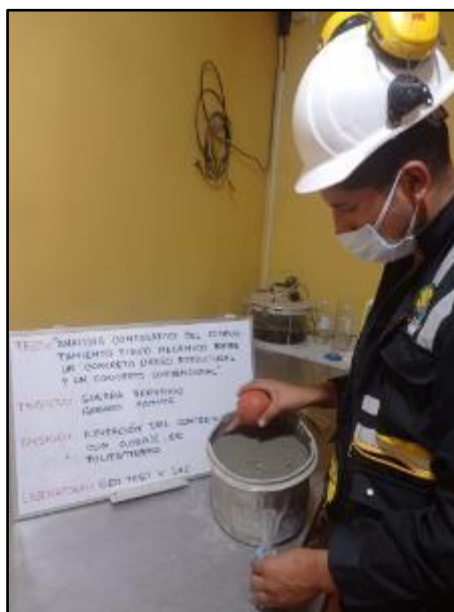
Fotografía N° 44: Control de la exudación del concreto con adición de poliestireno expandido al 0.05%. Según NTP 339.077.
