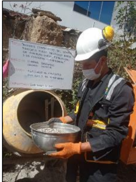
Fotografía N° 47: Vista de materiales tales como agregado grueso para la elaboración del concreto con adición de poliestireno expandido al 0.10%. Según NTP 339.183.
