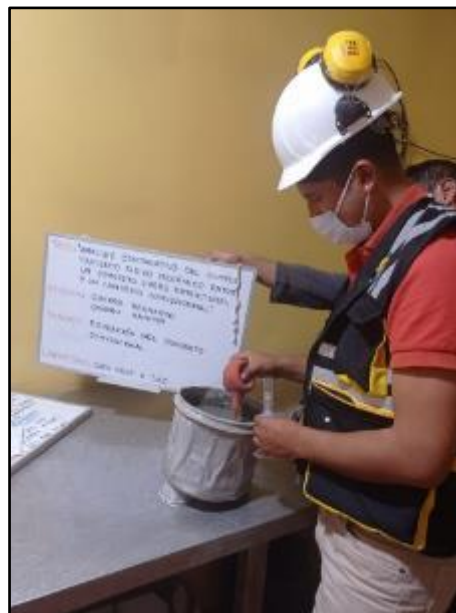
Fotografía N° 20: Control de la exudación del concreto convencional. Según NTP 339.077.
