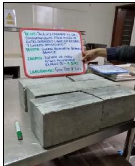
Fotografía N° 92: Mediciones de las caras fracturadas para ubicar la línea de fractura del ensayo resistencia a la flexión de vigas del concreto con adición del 0.05% a los 7 días de edad. Según NTP 339.078.
