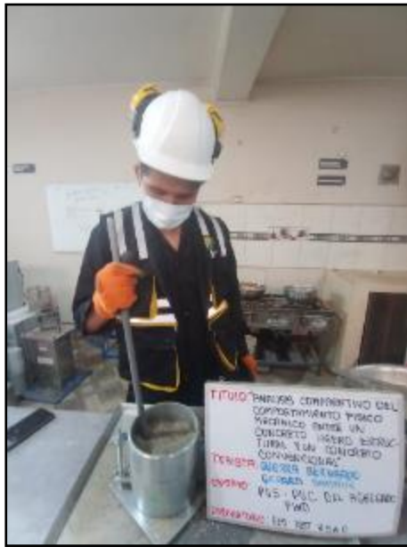
Fotografía N° 5: Ensayo de peso unitario y cantidad de vacíos del agregado fino. Según la NTP 400.017
