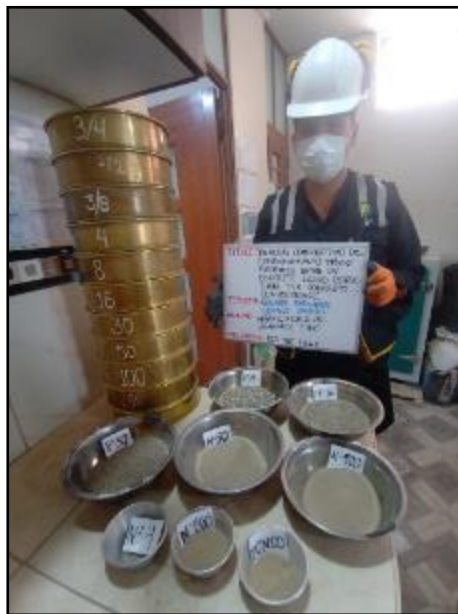
Fotografía N° 1: Ensayo de análisis granulométrico del agregado fino. Según NTP 400.012.
