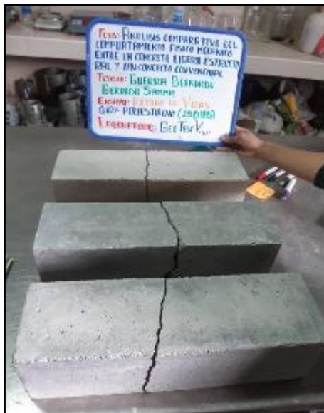
Fotografía N° 97: Mediciones de una de las caras fracturadas para ubicar la línea de fractura del ensayo resistencia a la flexión de vigas del concreto con adición del 0.10% a los 28 días de edad. Según NTP 339.078.
