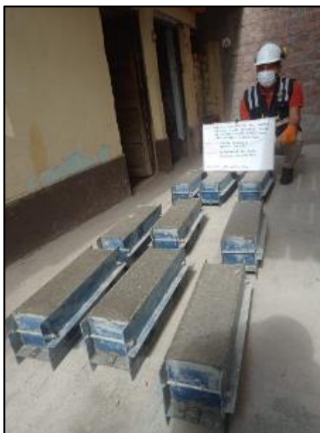
Fotografía N° 35: Elaboración de vigas de concreto con adición de poliestireno expandido al 0.025%. Según NTP 339.183.
