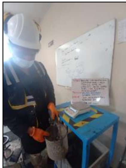
Fotografía N° 4: Colocado de la muestra saturada con superficie seca en la cesta de alambre para determinar su peso en agua a una temperatura 23°C. Según NTP 400.021.
