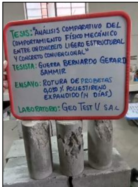
Fotografía N° 78: Tipo de falla del ensayo resistencia a la compresión de probetas del concreto con la adición de 0.050% de poliestireno expandido a los 14 días de edad. Según NTP 339.034.
