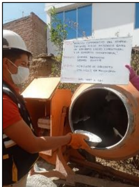
Fotografía N° 28: Vista de materiales tales como poliestireno expandido para la elaboración del concreto con adición de poliestireno expandido al 0.025%. Según NTP 339.183.
