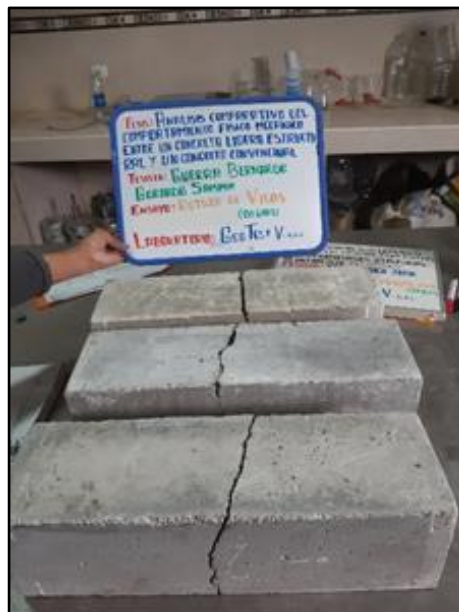
Fotografía N° 86: Mediciones de las caras fracturadas para ubicar la línea de fractura del ensayo resistencia a la flexión de vigas del concreto convencional a los 7 días de edad. Según NTP 339.078.
