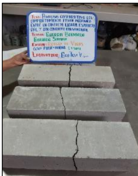
Fotografía N° 98: Mediciones de las caras fracturadas para ubicar la línea de fractura del ensayo resistencia a la flexión de vigas del concreto con adición del 0.20% a los 7 días de edad. Según NTP 339.078.
