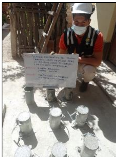
Fotografía N° 34: Elaboración de probetas cilíndricas de concreto con adición de poliestireno expandido al 0.025%. Según NTP 339.183
