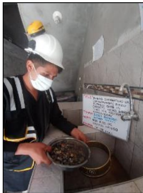
Fotografía N° 10: Ensayo del material más fino que pasa por el tamiz N°200 del agregado grueso. Según NTP 400.018.
