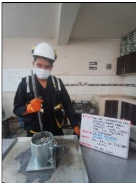
Fotografía N° 6: Ensayo de peso unitario y cantidad de vacíos del agregado grueso. Según la NTP 400.017.
