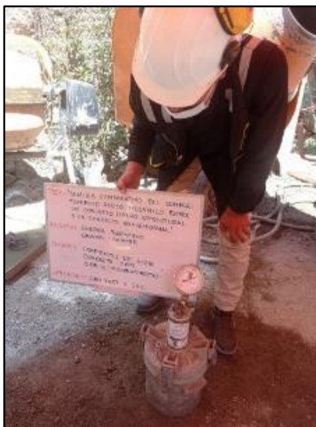
Fotografía N° 43: Control del contenido de aire del concreto con adición de poliestireno expandido al 0.05% por el método de presión. Según NTP 339.083.
