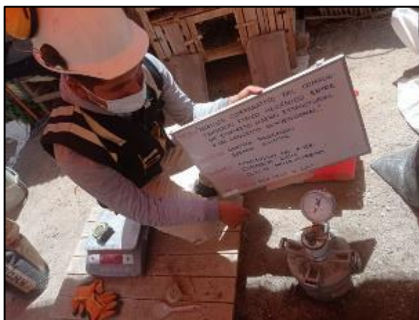
Fotografía N° 66: Control del contenido de aire del concreto con adición de poliestireno expandido al 0.20% por el método de presión. Según NTP 339.083.
