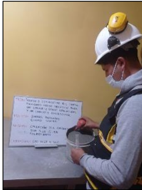
Fotografía N° 67: Control de la exudación del concreto con adición de poliestireno expandido al 0.20%. Según NTP 339.077.
