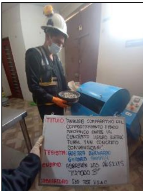
Fotografía N° 8: Colocado de la muestra de ensayo y la carga en la máquina de Los Ángeles, que, rota a una velocidad entre 33 rpm, por 500 revoluciones. Según NTP 400.019.
