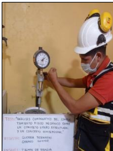
Fotografía N° 33: Lectura del tiempo de fraguado del concreto con adición de poliestireno expandido al 0.025%. Según NTP 339.082.
