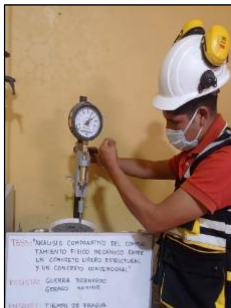
Fotografía N° 68: Lectura del tiempo de fraguado del concreto con adición de poliestireno expandido al 0.20%. Según NTP 339.082.
