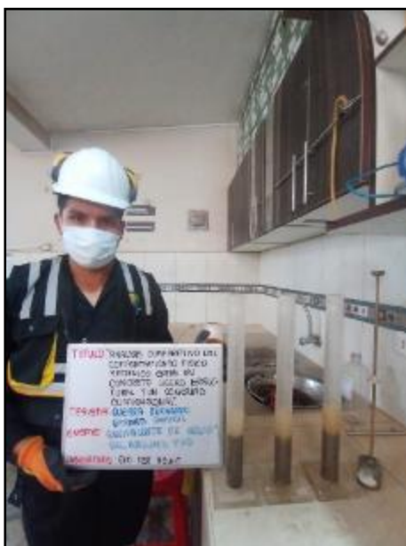
Fotografía N° 7: Ensayo de equivalente de arena o proporción relativa del contenido de polvo fino nocivo, en los suelos o agregados finos. Según NTP 339.146.
