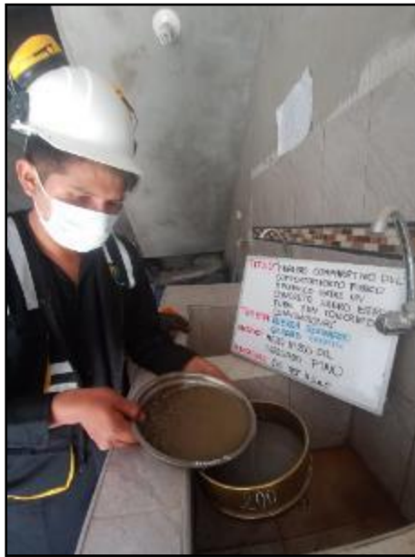
Fotografía N° 9: Ensayo del material más fino que pasa por el tamiz N°200 del agregado fino. Según NTP 400.018.
