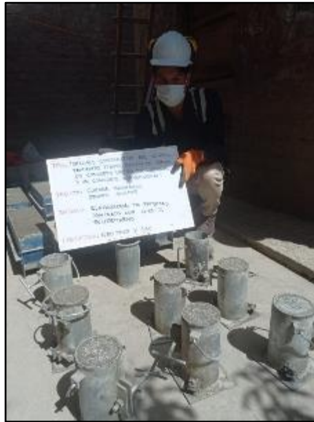
Fotografía N° 57: Elaboración de probetas cilíndricas de concreto con adición de poliestireno expandido al 0.10%. Según NTP 339.183.
