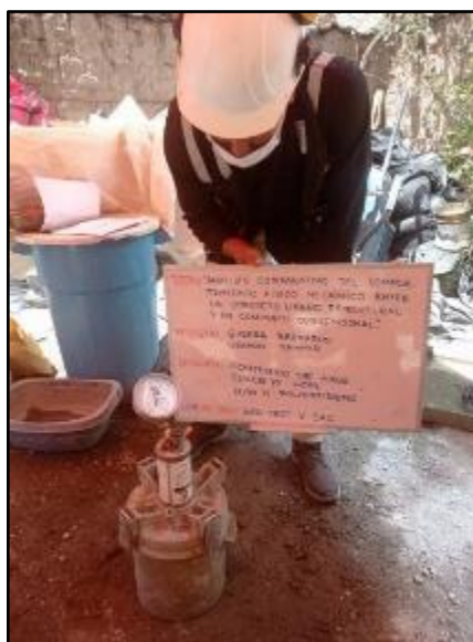
Fotografía N° 54: Control del contenido de aire del concreto con adición de poliestireno expandido al 0.10% por el método de presión. Según NTP 339.083.
