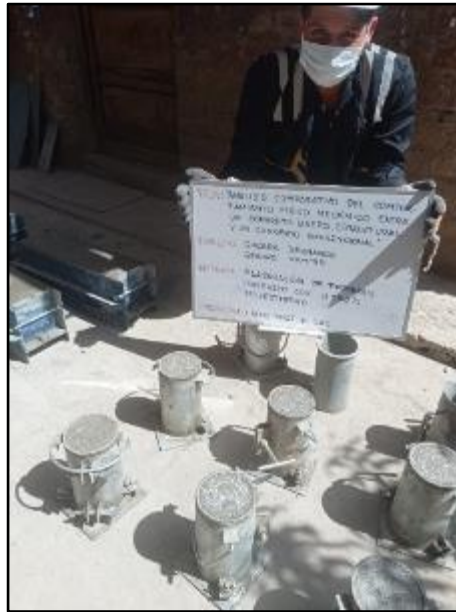
Fotografía N° 45: Elaboración de probetas cilíndricas de concreto con adición de poliestireno expandido al 0.05%. Según NTP 339.183.
