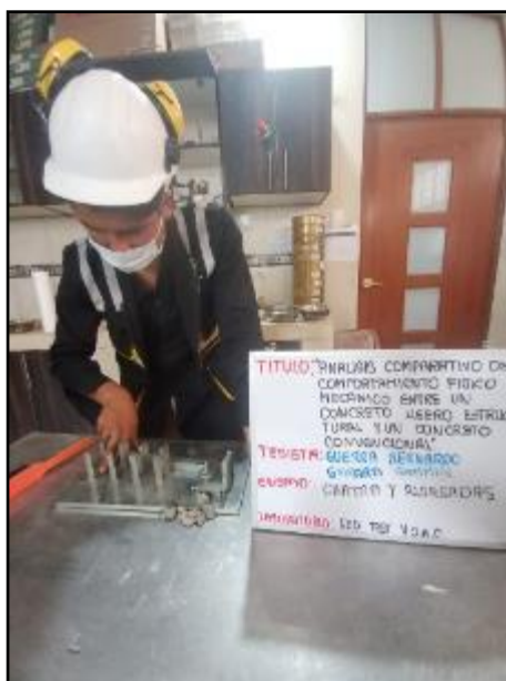
Fotografía N° 12: Ensayo de los porcentajes de partículas chatas o alargadas en el agregado grueso, mediante los tamices 3/4", 1/2", y 3/8". Según NTP 400.040.
