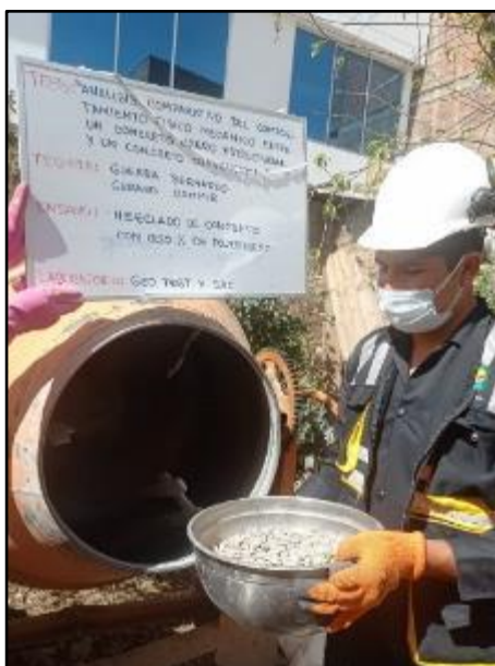
Fotografía N° 36: Vista de materiales tales como agregado grueso para la elaboración del concreto con adición de poliestireno expandido al 0.05%. Según NTP 339.183.
