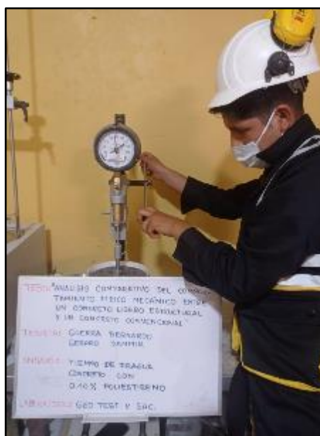
Fotografía N° 56: Lectura del tiempo de fraguado del concreto con adición de poliestireno expandido al 0.10%. Según NTP 339.082.
