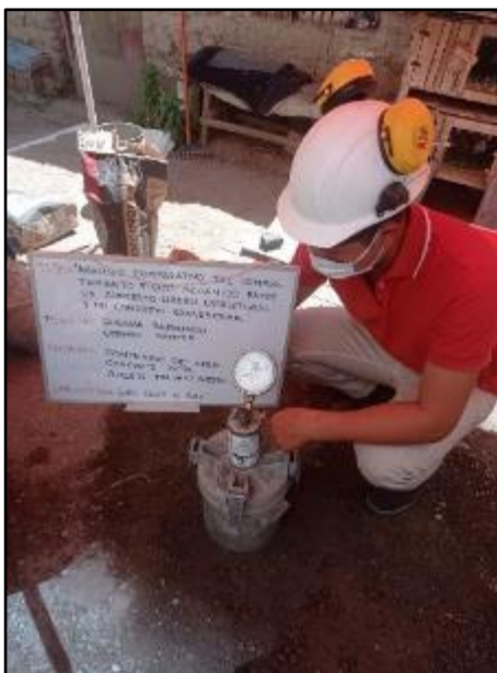
Fotografía N° 31: Control del contenido de aire del concreto con adición de poliestireno expandido al 0.025% por el método de presión. Según NTP 339.083.
