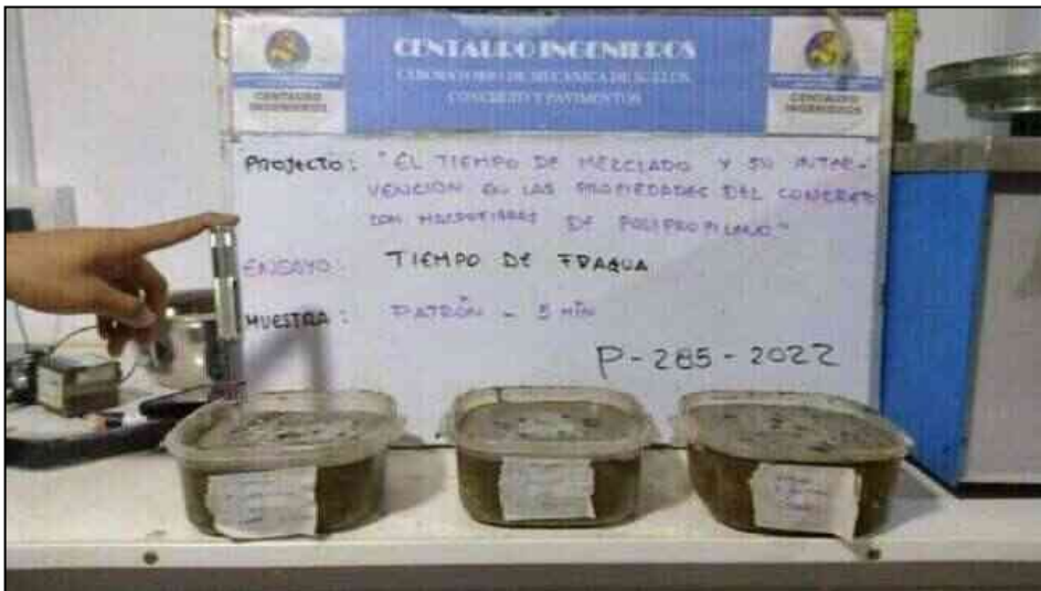
Fotografía 14. Medición del tiempo de fragua del concreto sin macrofibras, mezclado durante 5 minutos.
