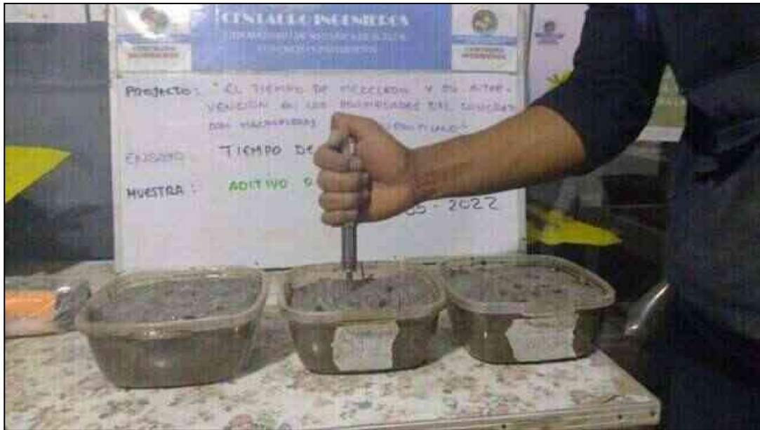
Fotografía 18. Medición del tiempo de fragua del concreto con macrofibras, mezclado durante 5 minutos.
