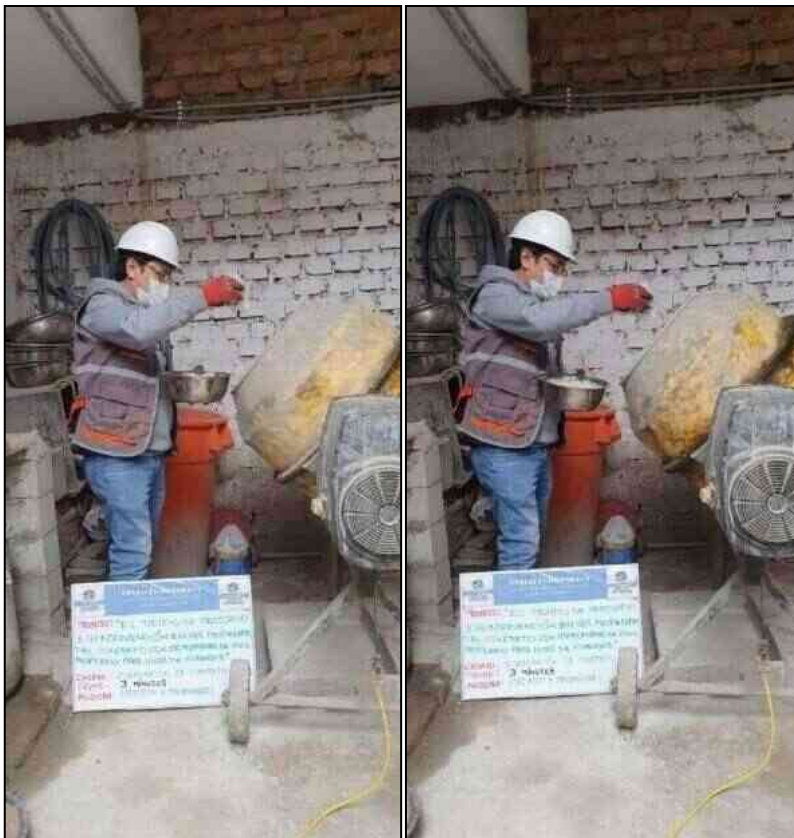
Fotografía 10. Preparación de las mezclas de concreto para un tiempo de mezclado de 3 minutos.
