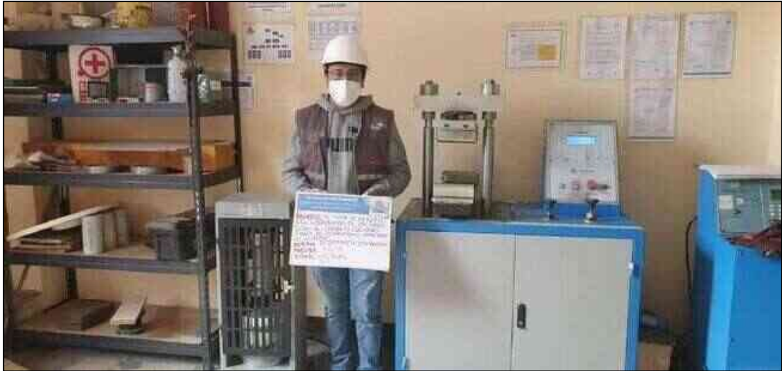
Fotografía 25. Roturado de probetas a los 28 días de edad.
