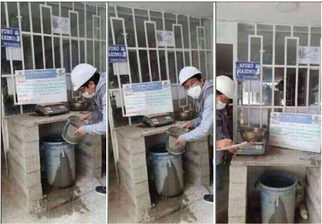
Fotografía 6. Determinación del peso específico del agregado grueso.
