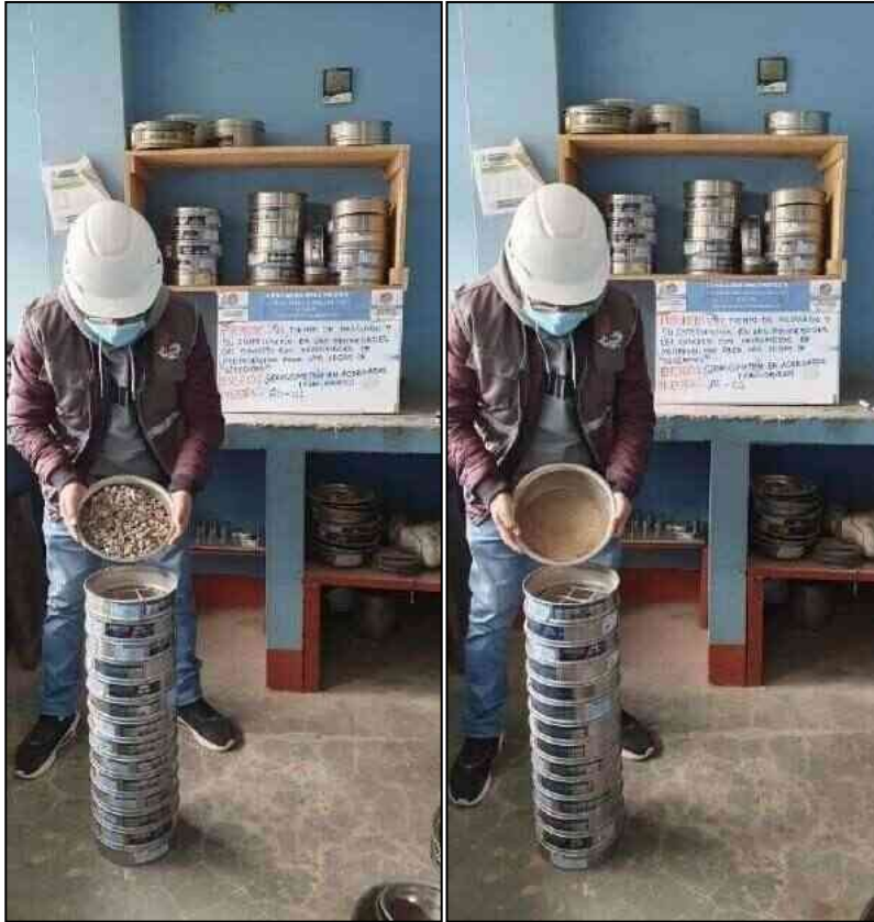
Fotografía 1. Análisis granulométrico del agregado grueso y fino.
