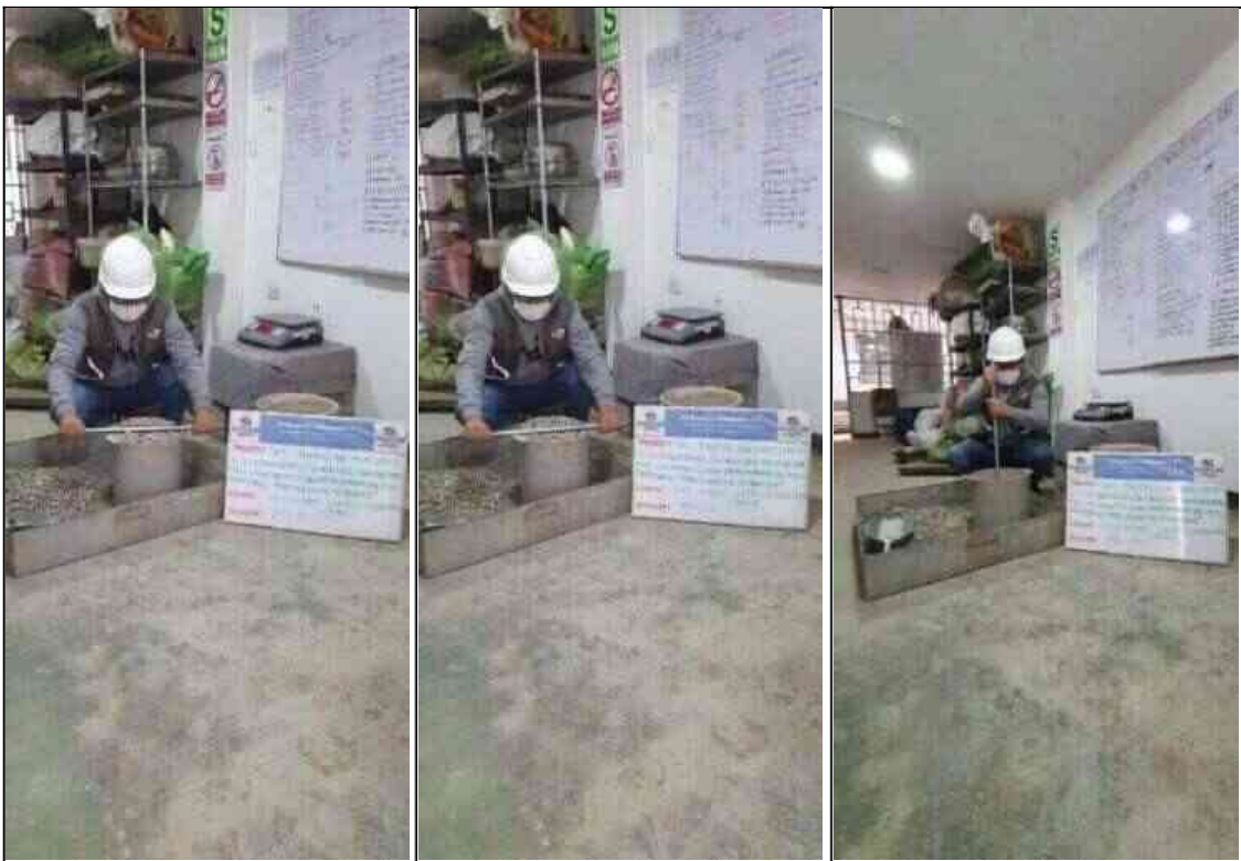
Fotografía 8. Peso unitario suelto y compactado del agregado grueso.
