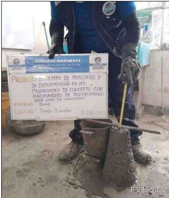
Fotografía 20. Medición del asentamiento del concreto mezclado durante 3 minutos.
