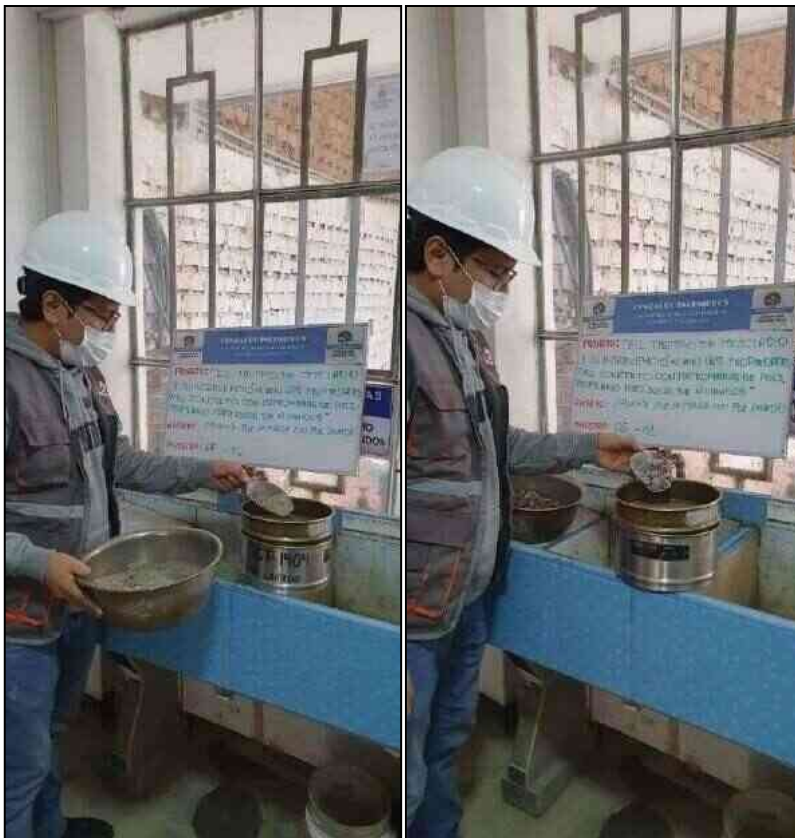
Fotografía 2. Determinación de los materiales menores a la malla N° 200 tanto en el agregado grueso y fino.
