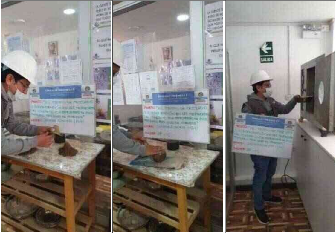
Fotografía 5. Determinación de la gravedad específica de los agregados finos.
