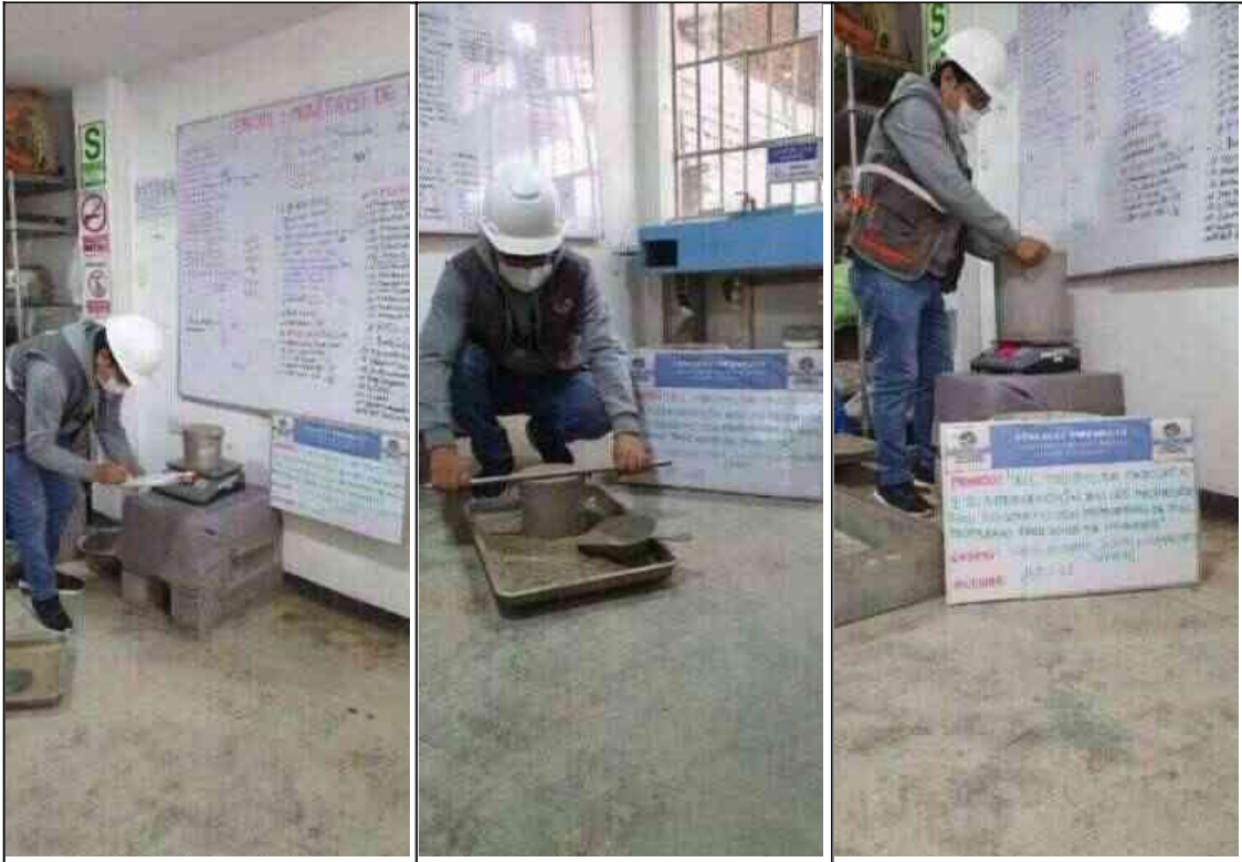
Fotografía 7. Peso unitario suelto y compactado del agregado fino.
