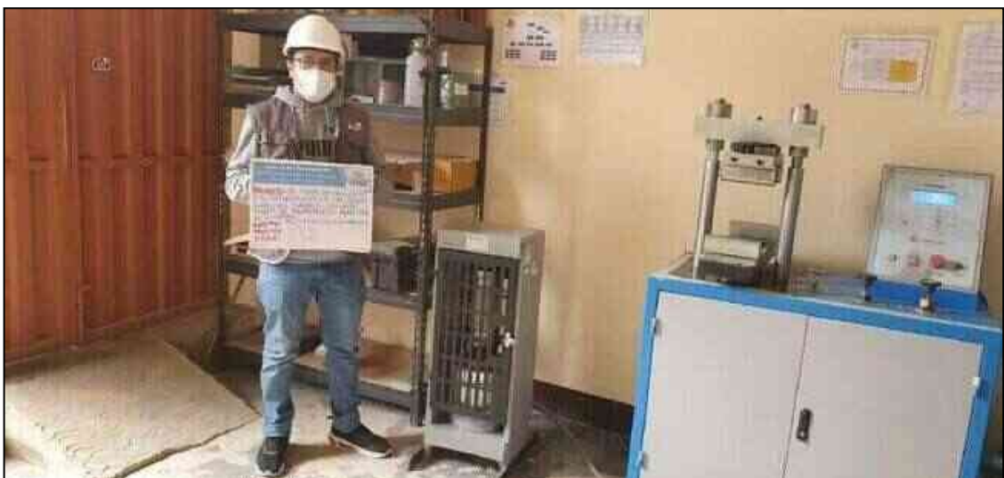
Fotografía 24. Roturado de probetas a los 14 días de edad.
