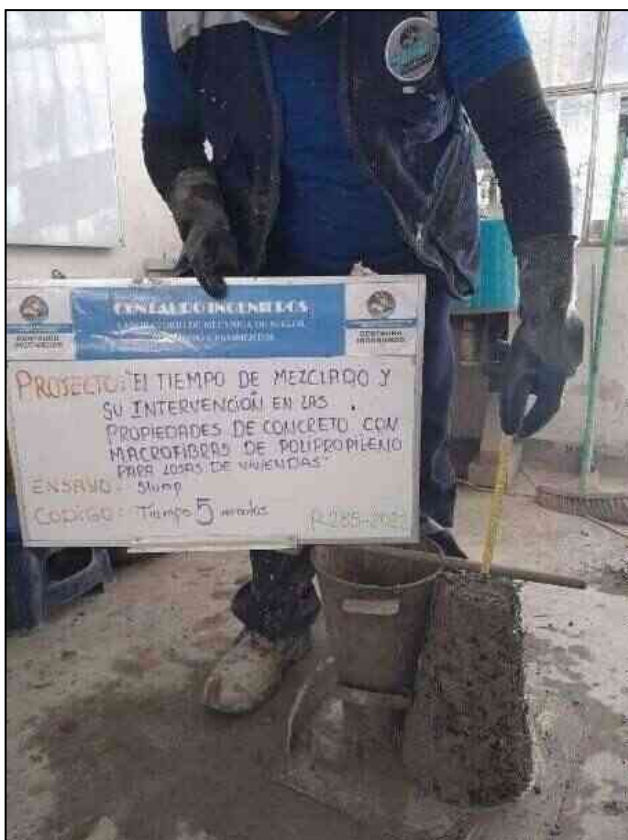
Fotografía 21. Medición del asentamiento del concreto mezclado durante 5 minutos.
