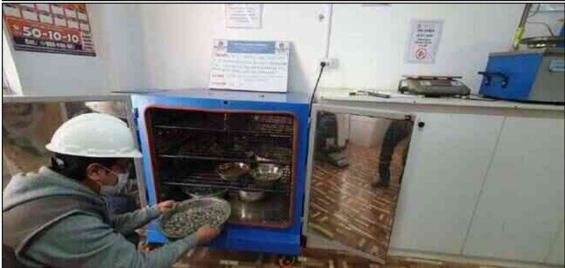
Fotografía 4. Secado del agregado fino y grueso para determinación de su contenido de humedad.
