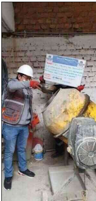
Fotografía 12. Preparación de las mezclas de concreto con macrofibras para un tiempo de mezclado de 10 minutos.
