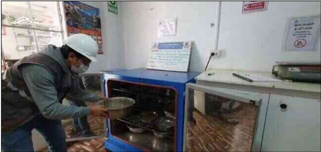
Fotografía 3. Determinación de la humedad del agregado grueso y fino.
