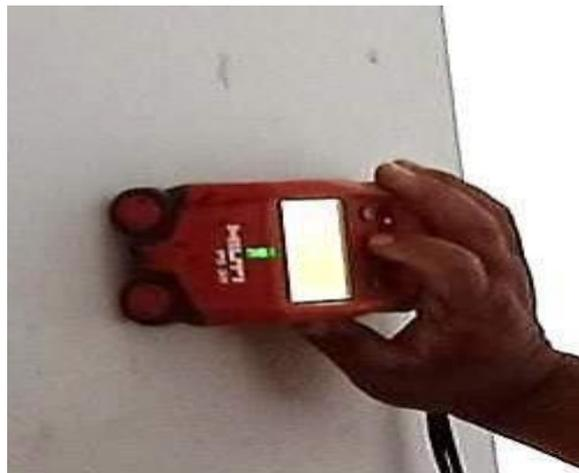
*Figura 17:* Scanner en columnas y vigas
