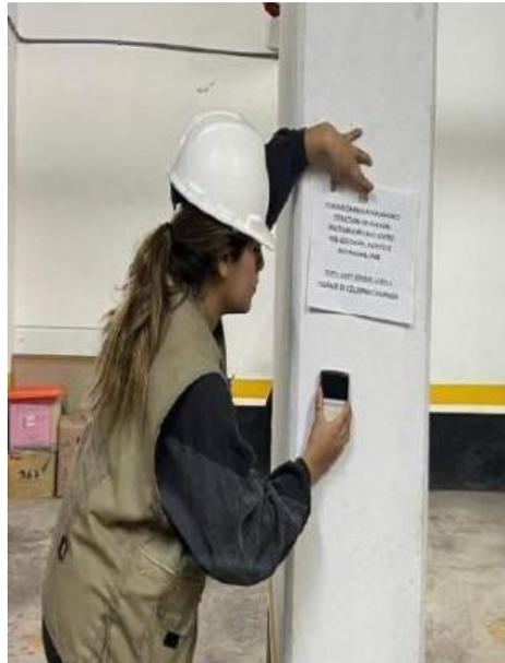
*Fotografía N° 1:* Identificación de aceros en las columnas con escáner
