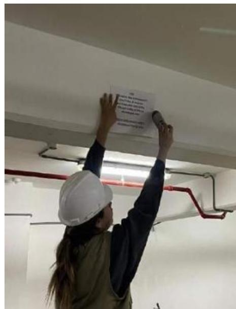
*Fotografía N° 6:* Se realiza para obtener la resistencia de concreto endurecido real
