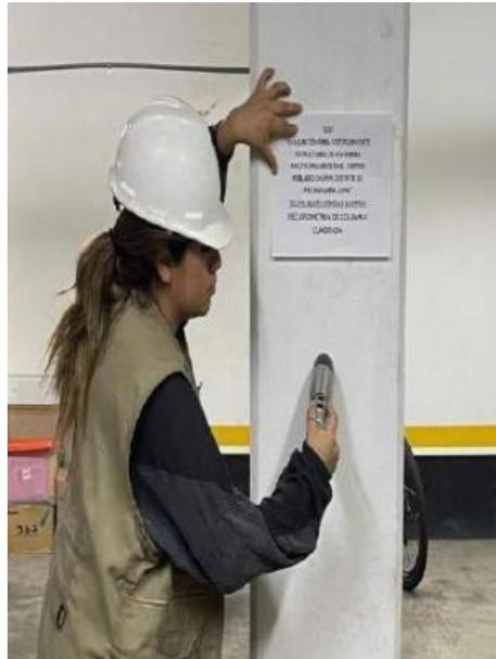
*Fotografía N° 3:* Para obtener la resistencia de concreto endurecido real
