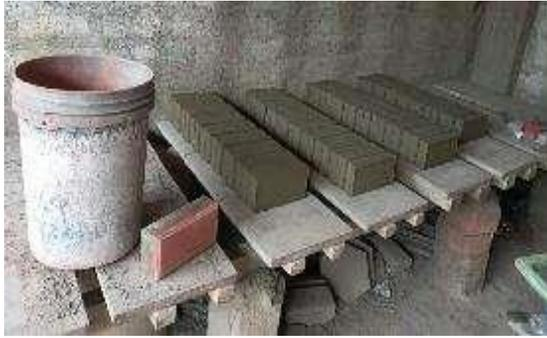
Figura 8: Fabricación de Adoquines de acuerdo a las dosificaciones 0 %, 2,5 %, 5,0 % y 7,5 %, por elaboración propia (2022)
