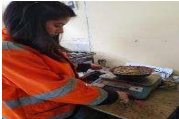
Figura 5 Pesado de agregados para los ensayos granulométricos por elaboración propia (2022).
