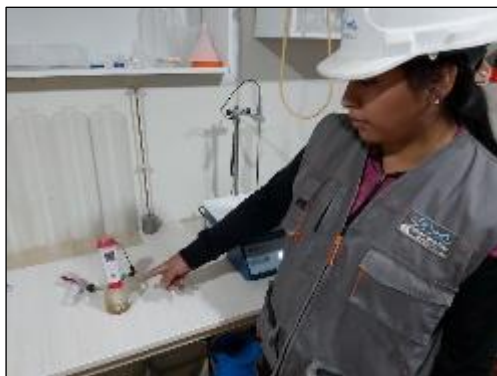
Fotografía 31. Determinación del pH del suelo con 14 % (14.03) de hidróxido sódico según la NTP 339.176
