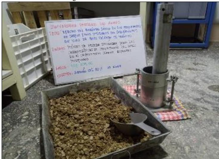
Fotografía 19. Ejecución del ensayo de Proctor modificado del suelo con 10 % de hidróxido sódico según la NTP 339.141.
