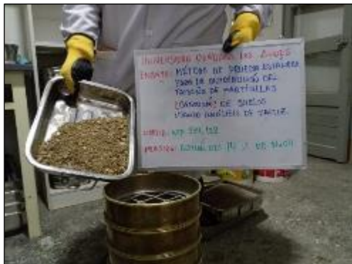
Fotografía 27. Vista del ensayo granulométrico del suelo con 14 % de hidróxido sódico según NTP 339.128.
