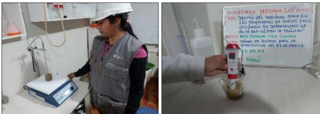
Fotografía 10. Determinación del pH (8.30) del suelo fino de fundación según la NTP 339.176.
