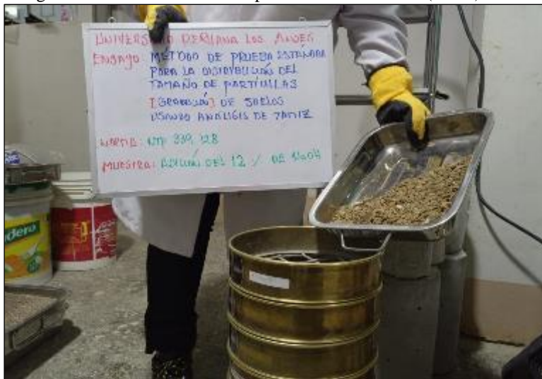
Fotografía 22. Vista del ensayo granulométrico del suelo con 12 % de hidróxido sódico según NTP 339.128.
