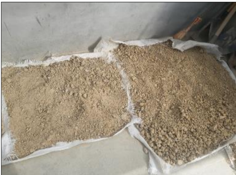
Fotografía 2. Vista de las muestras del suelo obtenida de la calicata y trasladadas a laboratorio de acuerdo a lo especificado en la NTP 339.151.
