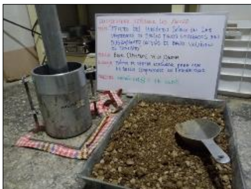
Fotografía 14. Ejecución del ensayo de Proctor modificado del suelo con 8 % de hidróxido sódico según la NTP 339.141.
