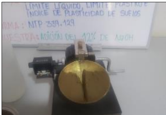
Fotografía 23. Ejecución del ensayo para determinar el límite líquido y límite plástico del suelo con 12 % de hidróxido sódico según la NTP 339.129.
