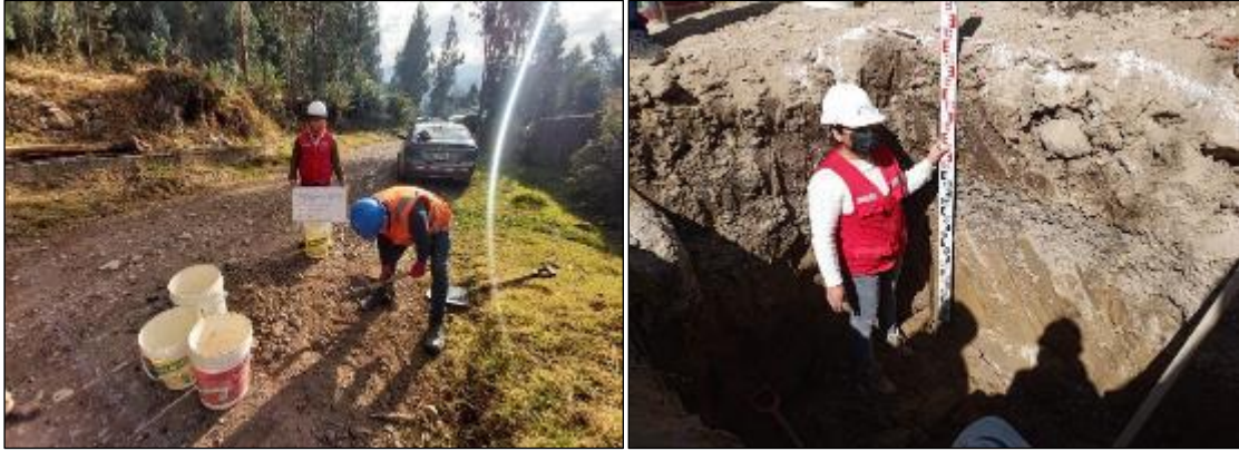
Fotografía 1. Vista de la extracción de muestras de suelos a una profundidad de 1.50 m, en la calle José Olaya, progresiva 0+427.74 con coordenadas 483033 E; 8660057 S; el cual fue la única de la cual se obtuvieron las muestras de suelos.
