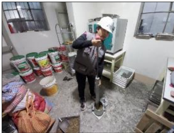
Fotografía 8. Ejecución del ensayo de Proctor modificado del suelo fino de fundación según la NTP 339.141.
