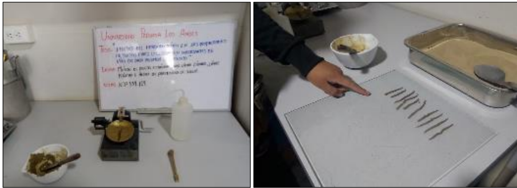
Fotografía 7. Ejecución del ensayo para determinar el límite líquido y límite plástico del suelo fino de fundación según la NTP 339.129.
