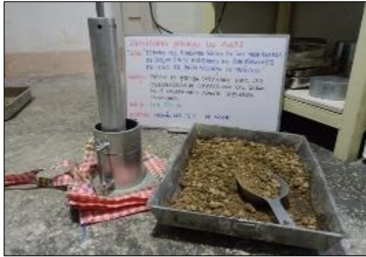
Fotografía 24. Ejecución del ensayo de Proctor modificado del suelo con 12 % de hidróxido sódico según la NTP 339.141.
