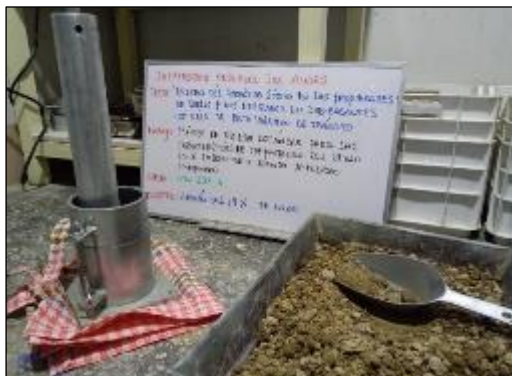
Fotografía 29. Ejecución del ensayo de Proctor modificado del suelo con 14 % de hidróxido sódico según la NTP 339.141.
