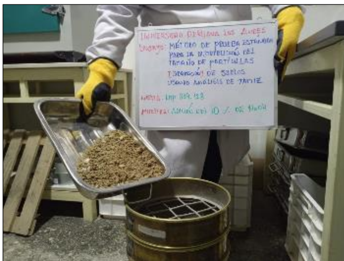
Fotografía 17. Vista del ensayo granulométrico del suelo con 10 % de hidróxido sódico según NTP 339.128.
