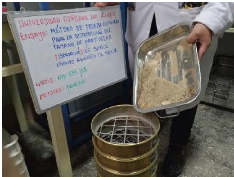
Fotografía 6. Vista del tamizado del suelo fino de fundación de acuerdo a la NTP 339.128.
