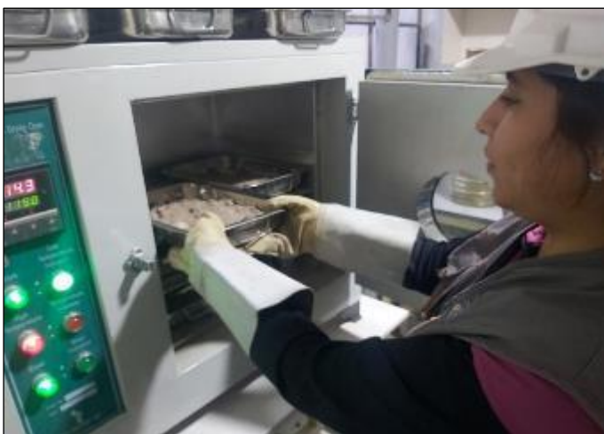
Fotografía 3. Ejecución del ensayo para determinar el contenido de humedad del suelo según la NTP 339.127.
