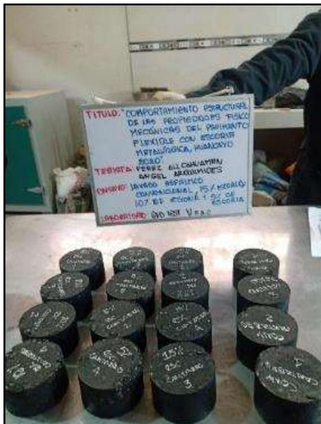
Fotografía N° 32: Desarrollo del ensayo lavado asfaltico convencional 15%, 10% y 5% de escoria.
