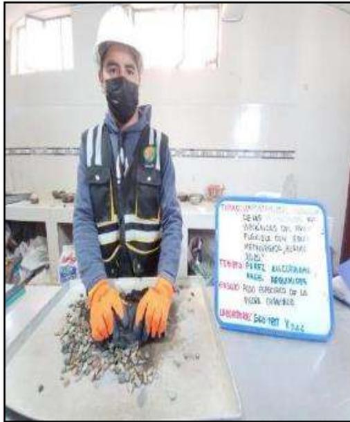
Fotografía N° 9: Desarrollo del Ensayo de peso específico de piedra chancada MTC E -206.
