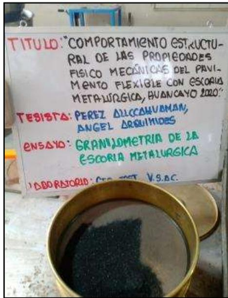
Fotografía N° 7: Desarrollo del Ensayo para la granulometría de escoria metalúrgica, según la MTC E-204, ASTM D-422.
