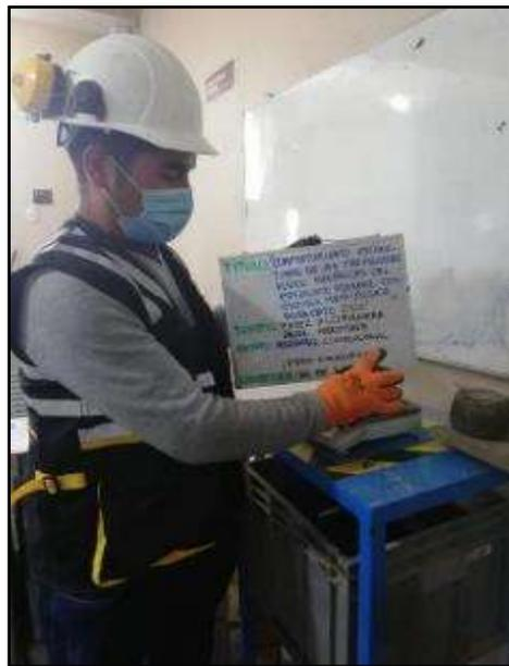
Fotografía N° 22: Desarrollo del ensayo Marshall (peso específico) al 4%, 4,5%, 5%, 5.5%, 6%, según la MTC E-504.
