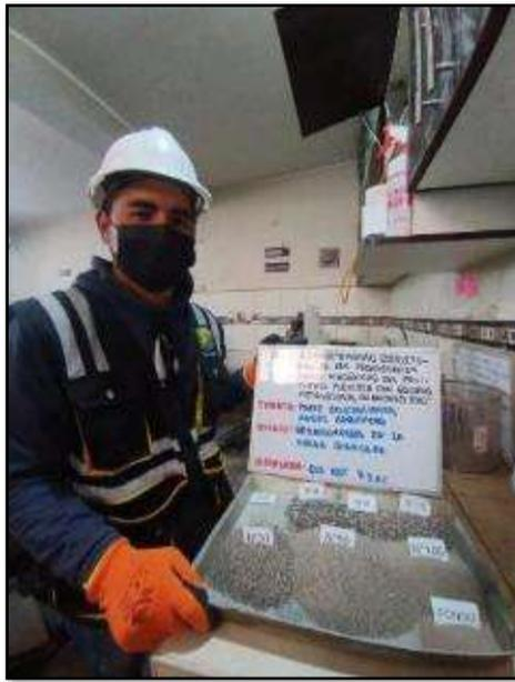
*Fotografía N° 5:* Ensayo de granulometría de arena chancada MTC E-204, ASTM D-422
