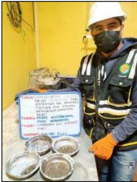
*Fotografía N° 15:* Desarrollo del Ensayo Durabilidad del agregado grueso y agregado fino según la MTC E-209.
