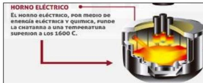
Figura 5: Horno eléctrico de sider Perú
