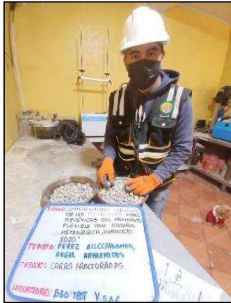
Fotografía N° 17: Desarrollo del ensayo para determinar el Método de ensayo de las caras fracturadas 90/70 MTC E-210
