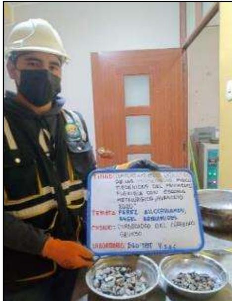
Fotografía N° 14: Desarrollo del Ensayo Durabilidad del agregado grueso y agregado fino según la MTC E-209.
