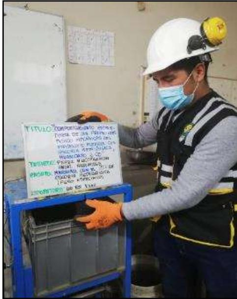
Fotografía N° 27: Desarrollo del ensayo Marshall con el 15% de escoria metalúrgica (peso específico) según la MTC E-504.
