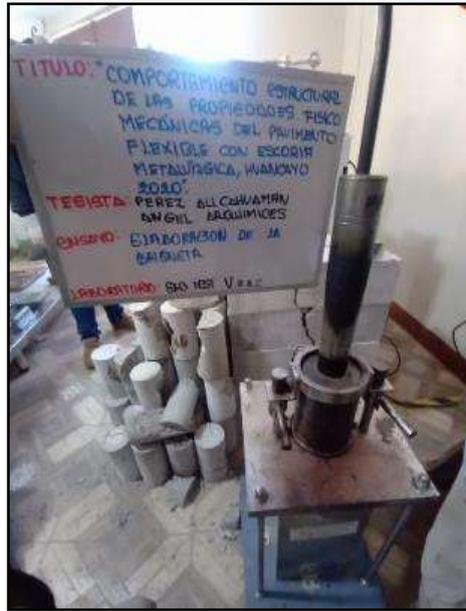
Fotografía N° 33: Desarrollo del ensayo para la elaboración de la Briqueta.
