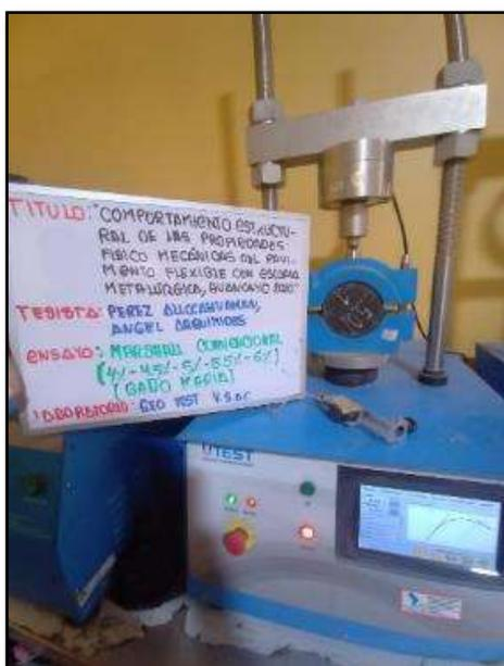
Fotografía N° 24: Desarrollo del ensayo Marshall para determinar la Rotura al 4%, 4,5%, 5%, 5,5%, 6% según la MTC E-504.
