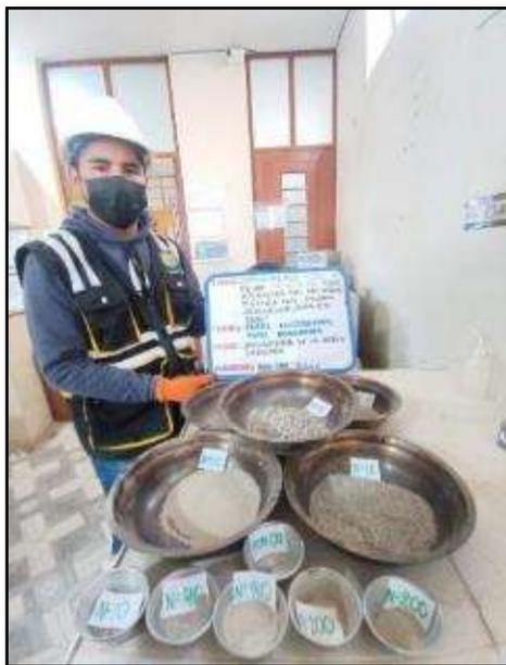
Fotografía N° 4: Ensayo de granulometría de arena chancada MTC E-204, ASTM D-422
