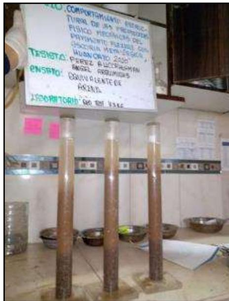
Fotografía N° 12: Desarrollo del Ensayo de arena Equivalente de Arena Natural MTC E-114.
