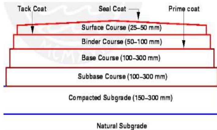
Figura 1: Sección de un pavimento flexible convencional.
