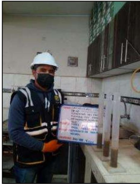
Fotografía N° 11: Desarrollo del Ensayo de arena Equivalente de Arena Natural MTC E-114.
