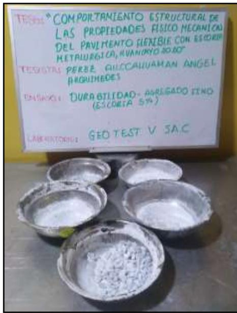
Fotografía N° 3: Muestra el agregado fino después de ser retirado del horno.
