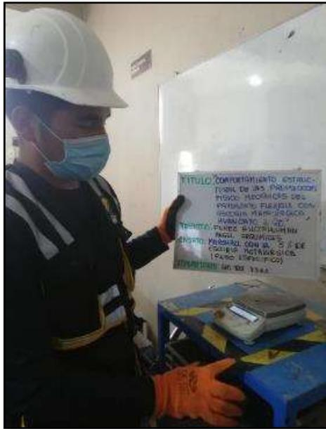
Fotografía N° 25: Desarrollo del ensayo Marshall con el 5%, de escoria metalúrgica (peso específico) según la MTC E-504.
