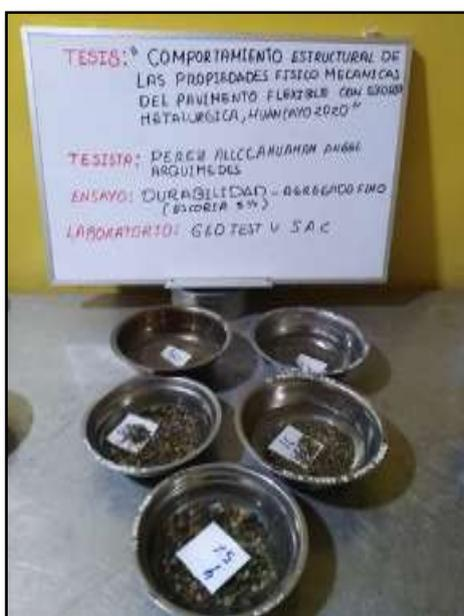
*Fotografía N° 2:* Se puede visualizar el agregado fino sumergido en la solución, el cual estuvo por 18 horas. Finalmente se pasó a retirar la solución, para luego ser llevado al horno por 3 horas a una temperatura de 110 °C.
