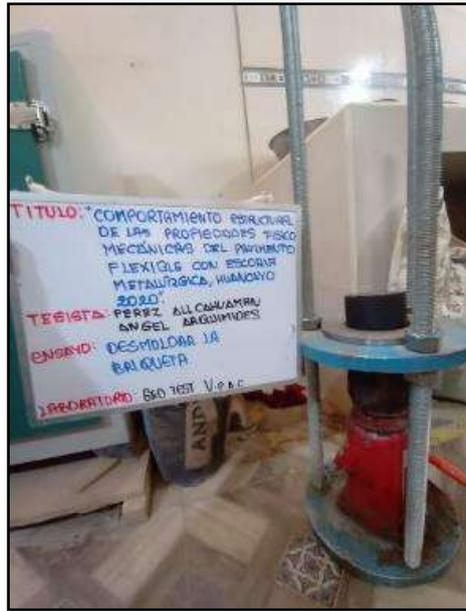
Fotografía N° 35: Desarrollo del ensayo para desmoldar la briqueta.
