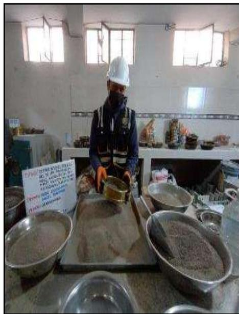
*Fotografía N° 6:* Ensayo de granulometría de arena natural MTC E-204, ASTM D-422.
