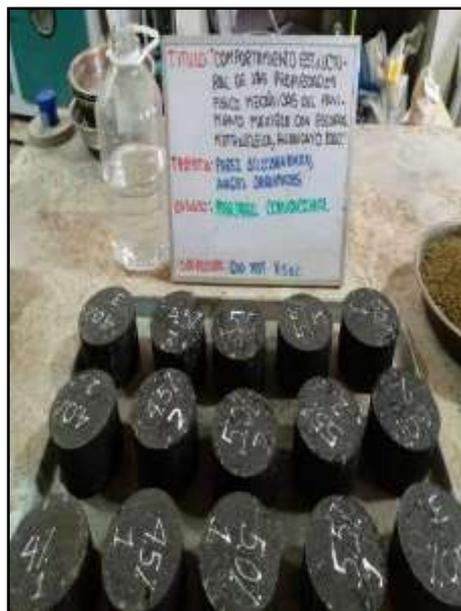
Fotografía N° 20: Desarrollo del ensayo Marshall al 4%, 4.5%, 5%, 5.5%, 6%. según la MTC E-504.
