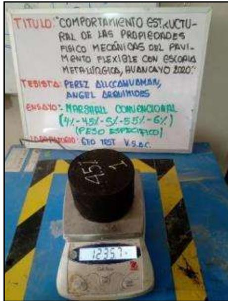
Fotografía N° 21: Desarrollo del ensayo Marshall (peso específico) al 4%, 4,5%, 5%, 5.5%, 6%, según la MTC E-504.
