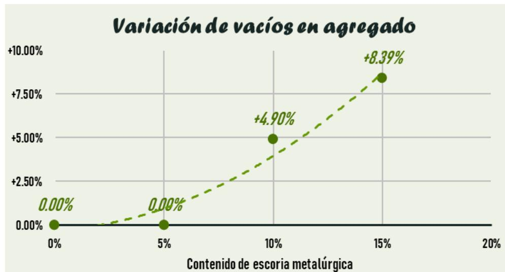
Figura 33: Variación de los vacíos en el agregado
