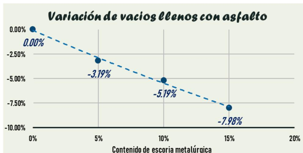
Figura 31: Variación de los vacíos llenos con asfalto
