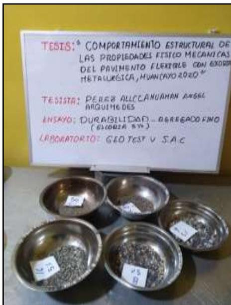
*Fotografía N° 1:* Se observa el material fino libre de impureza o polvillo; tamizado y retenido en mallas N° 4, 8, 16, 30, 50.
