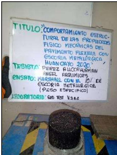
Fotografía N° 26: Desarrollo del ensayo Marshall con el 10% de escoria metalúrgica (peso específico) según la MTC E-504.
