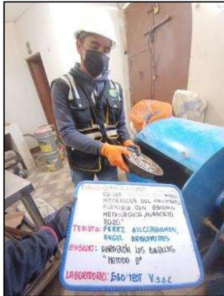
Fotografía N° 19: Desarrollo del ensayo de Abrasión Los Ángeles (Método B- 11 esferas) MTC E-207.
