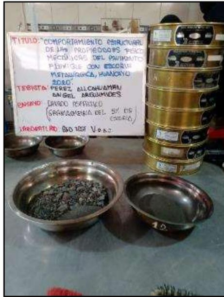
Fotografía N° 31: Desarrollo del ensayo para determinar el Lavado Asfaltico del 5% de escoria (se desarrolla con el óptimo).
