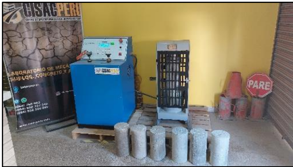
Figura 40 Ensayos de compresión simple en laboratorio
