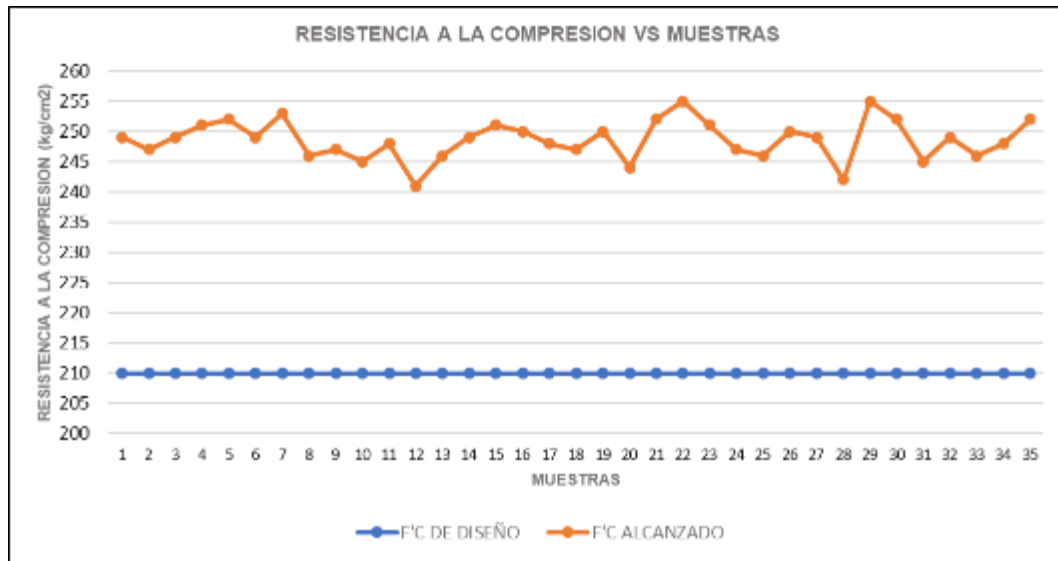
Figura 44 Gráfica de resistencia a la compresión de diseño y resistencia real ejecutada en porcentaje
