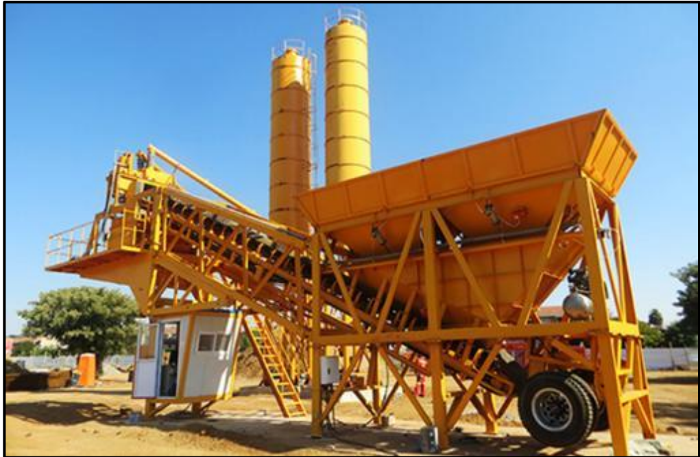
Figura 5 Planta dosificadora de concreto
