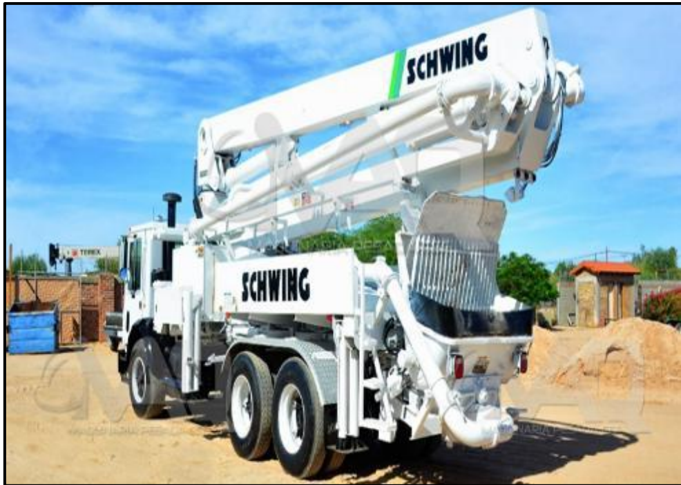
Figura 7 Telescópica de concreto
