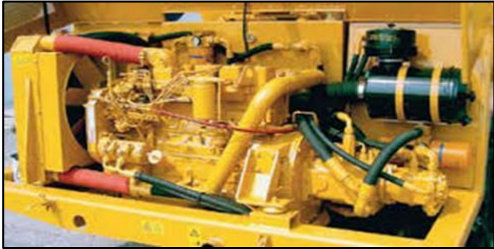
Figura 17 Energía para movilizar toda la autohormigonera
