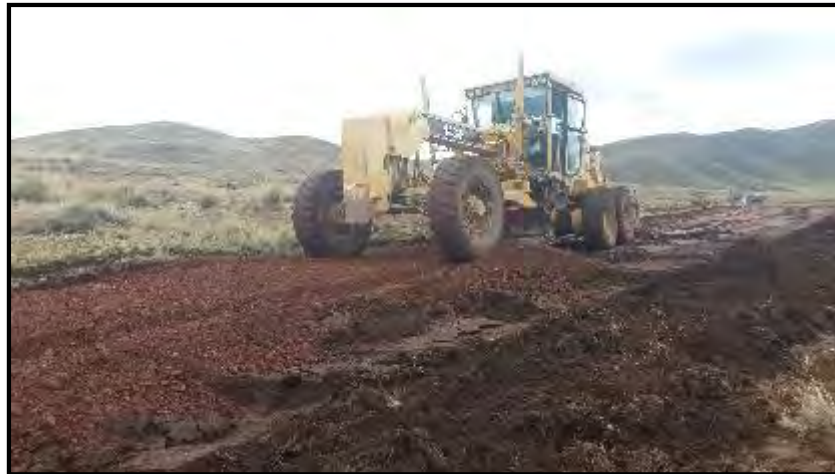
Ilustración 21. Motoniveladora Caterpillar 143H.
