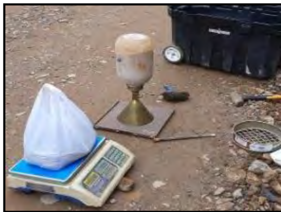
Ilustración 13. Pruebas de Densidad de campo.
