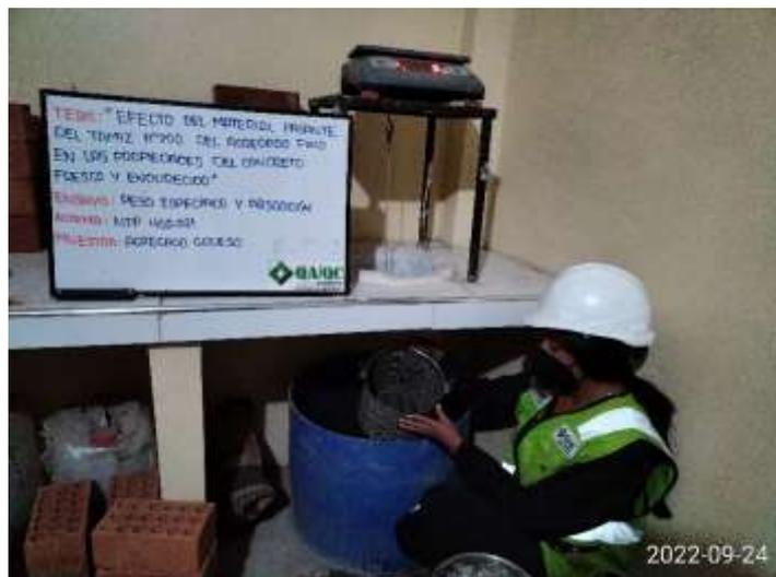
**Imagen 12:** Vista general del proceso del ensayo de peso específico del agregado grueso (NTP 400.021)
