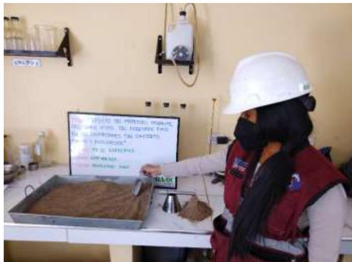
**Imagen 09:** Vista general del proceso del ensayo de peso específico del agregado fino (NTP 400.022)
