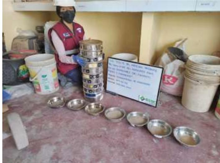
**Imagen 10:** Vista general del proceso del ensayo de análisis granulométrico por tamizado (NTP 400.012)
