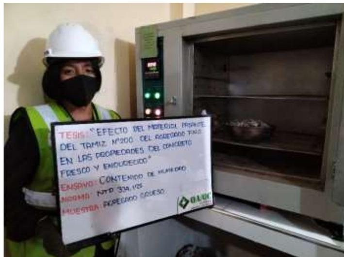
**Imagen 08:** Vista general del proceso del ensayo de contenido de humedad de los agregados (NTP 339.185).
