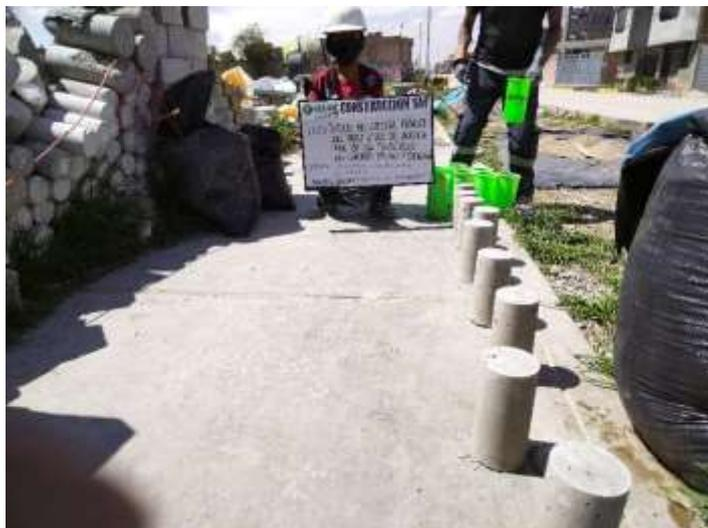
**Imagen 06:** Vista general del proceso desmoldado de los especímenes cilíndricos.
