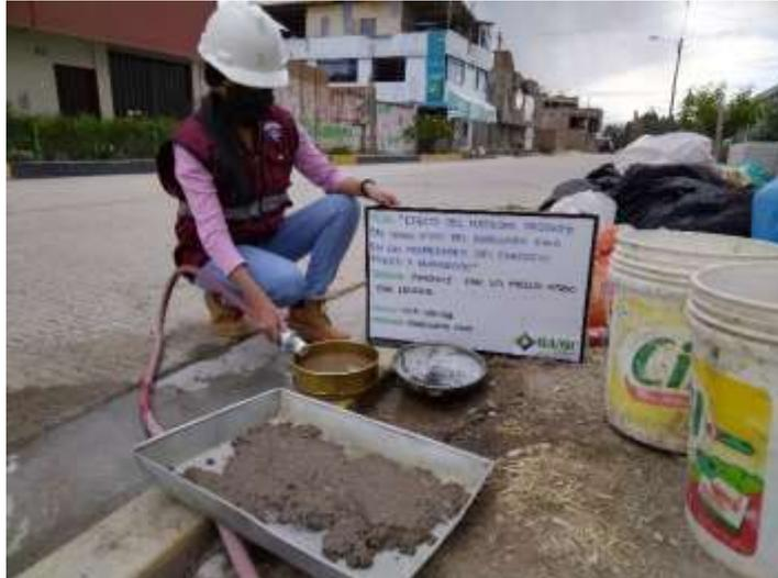
**Imagen 04:** Vista general del proceso del ensayo de microfinos menor que el tamiz #200 (NTP 400.018)
