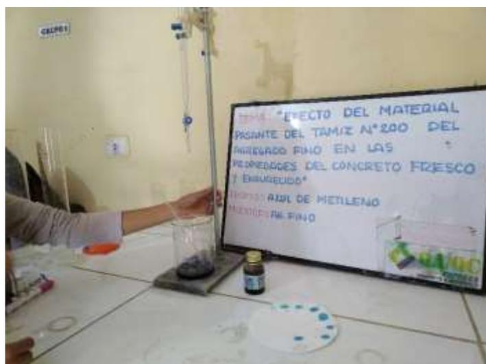
**Imagen 03:** Vista general del ensayo azul de metileno (NTP 239.401)
