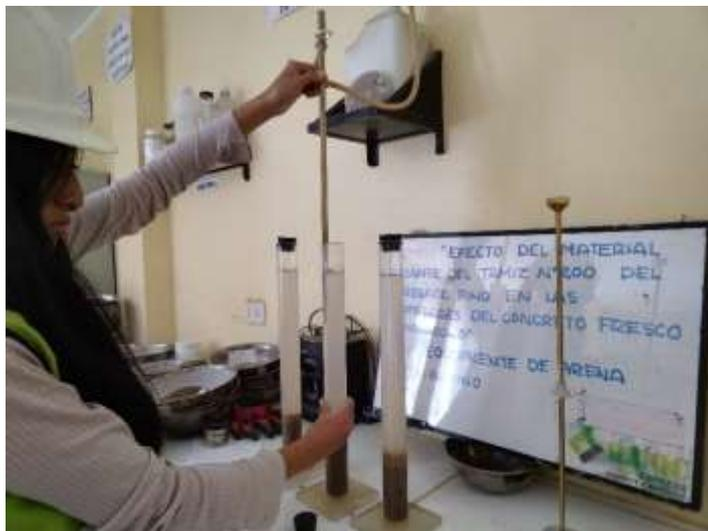
**Imagen 05:** Vista general del proceso del ensayo equivalente de arena (NTP 339.146).
