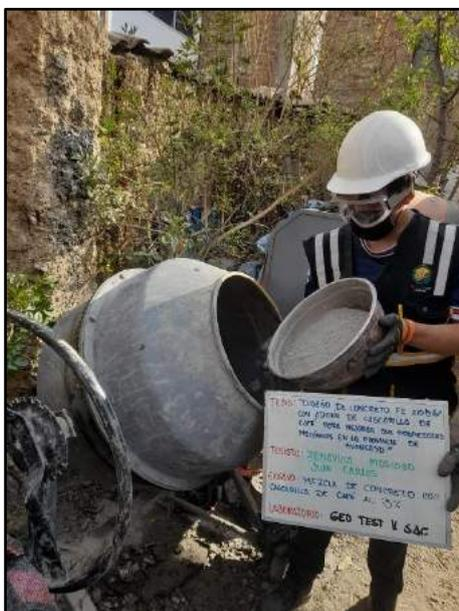
Fotografía N° 46: Se observa cómo se vierte el cemento para la elaboración del concreto con adición del 3% de cascarilla de café, de acuerdo a la norma NTP 339.183.
