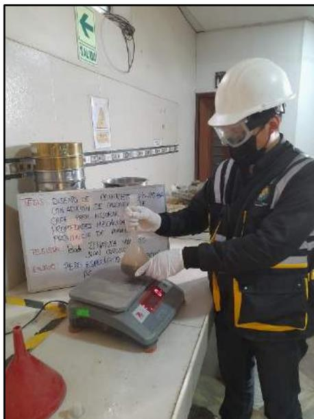
Fotografía N° 4: Se determino el peso específico y absorción del agregado fino mediante el método de la Fiola, de acuerdo a la norma NTP 400.022.
