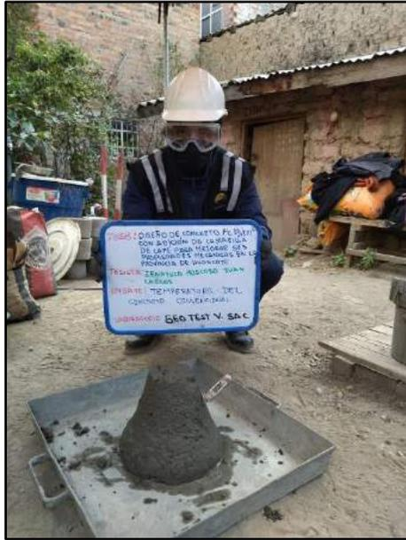
Fotografía N° 15: Se muestra la medición de la temperatura del concreto convencional, de acuerdo a la norma NTP 339.184.
