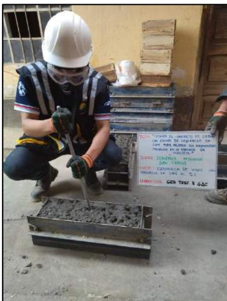
Fotografía N° 57: Se muestra la elaboración de testigos rectangulares con la incorporación del 3% de cascarilla de café, para sus correspondientes tipos de ensayos, de acuerdo a lo establecido por la norma NTP 339.034 /ASTM C39.
