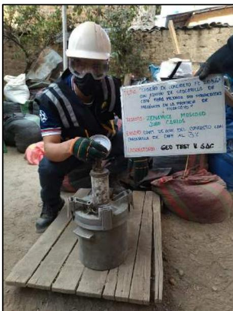
Fotografía N° 53: Se muestra el control del contenido de aire del concreto fresco con la incorporación del 3% de cascarilla de café ejecutado por el método de presión. de acuerdo a la norma NTP 339.083.
