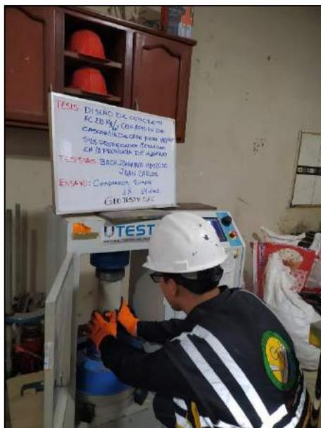
Fotografía N° 66: Se muestran los testigos cilíndricos ensayados a compresión incorporados al 1% de cascarilla de café para determinar su resistencia a los 14 días de edad, de acuerdo a los establecido por la norma NTP 339.034 / ASTM C39.
