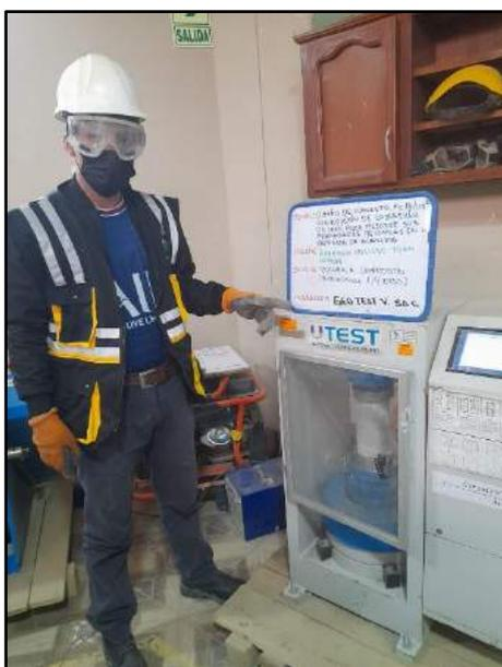
Fotografía N° 60: Se muestran los testigos cilíndricos convencionales transcurridos los 14 días de edad para determinar la resistencia a la compresión, en base al criterio establecido por la norma NTP 339.034 /ASTM C39.
