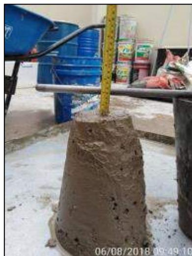
*Figura 12. Ensayo Slump (trabajabilidad)*
