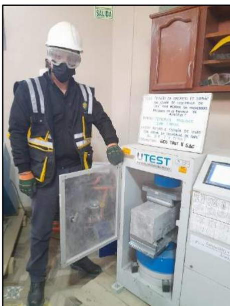
Fotografía N° 92: Se muestra a los testigos verticales con una incorporación del 2% de cascarilla de café con el fin de determinar la resistencia a la flexión al transcurrir los 7 días de edad, en base al criterio establecido por la norma NTP 339.034 / ASTM C39.
