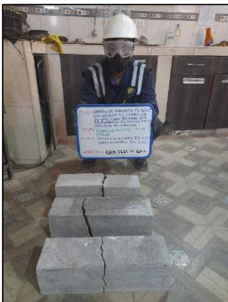
Fotografía N° 83: Se muestran los testigos verticales convencionales transcurridos los 14 días de edad para determinar la resistencia a la flexión, en base al criterio establecido por la norma NTP 339.034 /ASTM C39.
