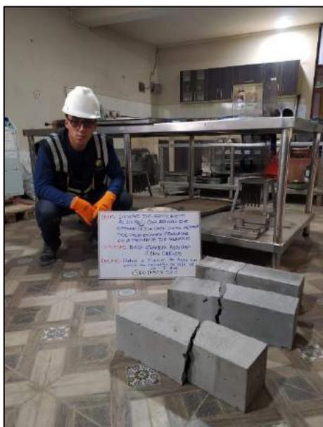
Fotografía N° 87: Se muestra a los testigos verticales con una incorporación del 1% de cascarilla de café con el fin de determinar la resistencia a la flexión al transcurrir los 7 días de edad, en base al criterio establecido por la norma NTP 339.034 / ASTM C39.
