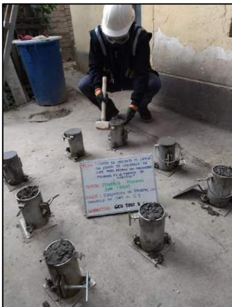
Fotografía N° 44: Se muestra la elaboración de testigos cilíndricos con la incorporación del 2% de cascarilla de café para sus correspondientes tipos de ensayos, según referencia de la norma NTP 339.034/ ASTM C39.
