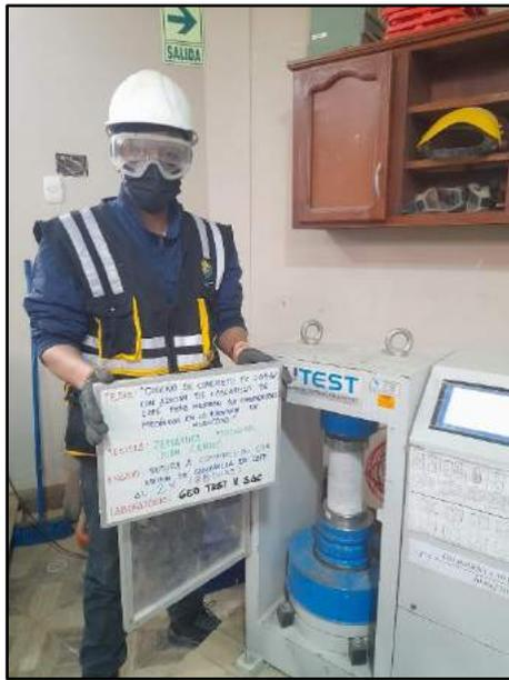
Fotografía N° 73: Se muestran los testigos cilíndricos ensayados a compresión incorporados al 2% de cascarilla de café para determinar su resistencia a los 28 días de edad, de acuerdo a los establecido por la norma NTP 339.034 / ASTM C39.
