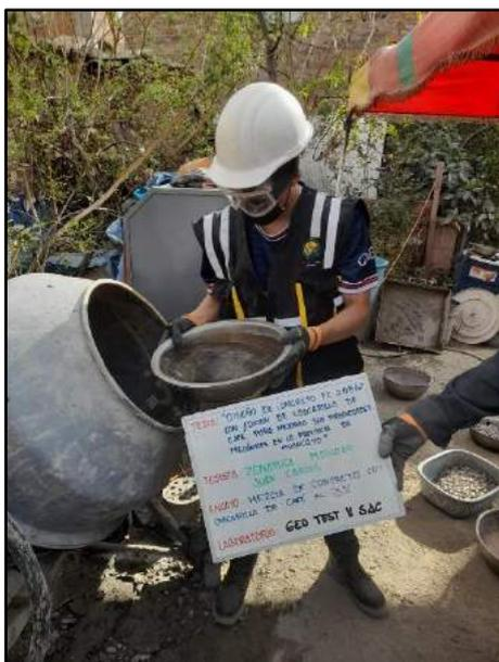
Fotografía N° 49: Se observa cómo se vierte el agua para la elaboración del concreto con la adición de 3% de cascarilla de café, de acuerdo a la norma NTP 339.183.
