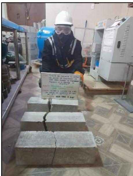
Fotografía N° 97: Se muestra a los testigos verticales con una incorporación del 2% de cascarilla de café con el fin de determinar la resistencia a la flexión al transcurrir los 28 días de edad, en base al criterio establecido por la norma NTP 339.034 / ASTM C39.
