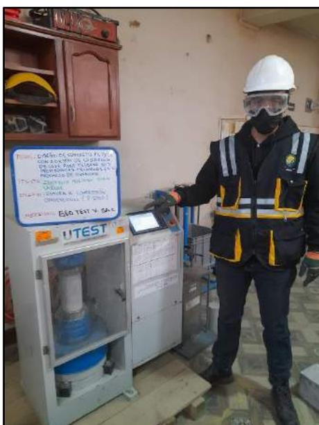
Fotografía N° 58: Se muestran los testigos cilíndricos convencionales transcurridos los 7 días de edad para determinar la resistencia a la compresión, en base al criterio establecido por la norma NTP 339.034 /ASTM C39.
