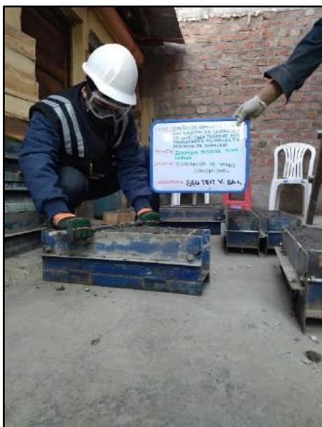
Fotografía N° 21: Se muestra la elaboración de testigos rectangulares convencionales para sus correspondientes tipos de ensayos, de acuerdo a lo establecido por la norma NTP 339.034 / ASTM C39.
