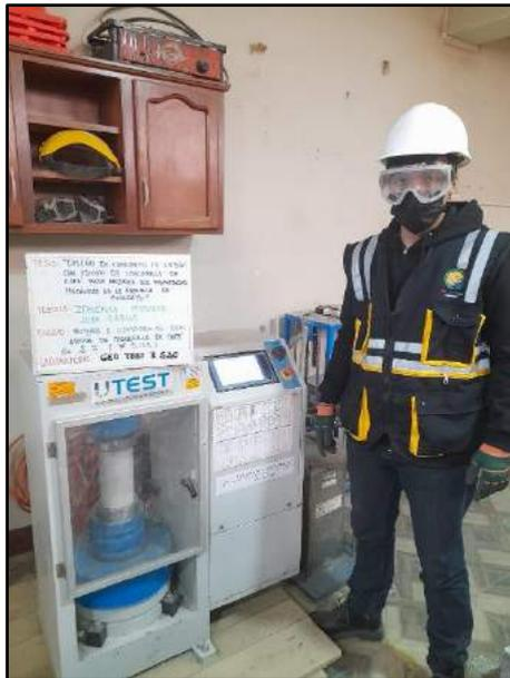
Fotografía N° 69: Se muestran los testigos cilíndricos ensayados a compresión incorporados al 2% de cascarilla de café para determinar su resistencia a los 7 días de edad, de acuerdo a los establecido por la norma NTP 339.034 / ASTM C39.
