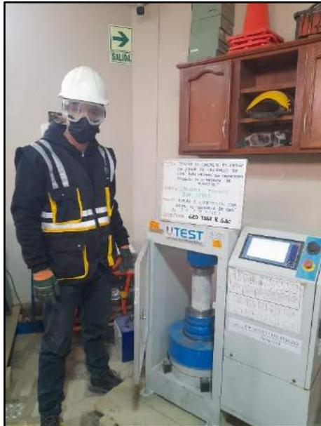
Fotografía N° 75: Se muestran los testigos cilíndricos ensayados a compresión incorporados al 3% de cascarilla de café para determinar su resistencia a los 7 días de edad, de acuerdo a los establecido por la norma NTP 339.034 / ASTM C39.
