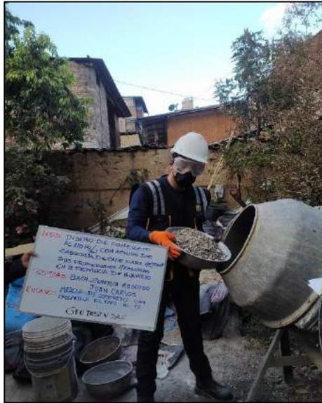
Fotografía N° 23: Se observa cómo se vierte el agregado grueso para la elaboración del concreto con adición del 1% de cascarilla de café, de acuerdo a la norma NTP 339.183.
