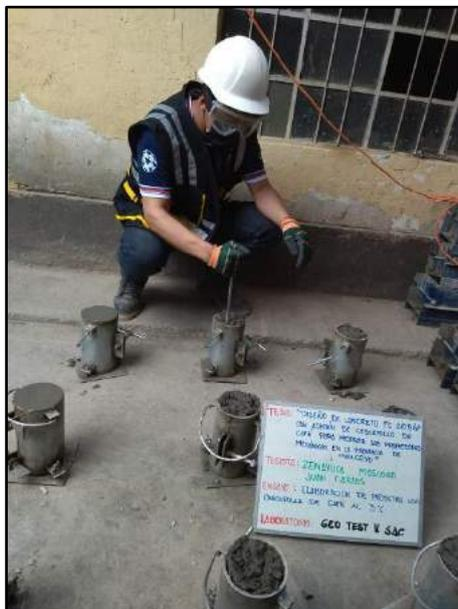
Fotografía N° 56: Se muestra la elaboración de testigos cilíndricos con la incorporación del 3% de cascarilla de café para sus correspondientes tipos de ensayos, según referencia de la norma NTP 339.034 / ASTM C39.
