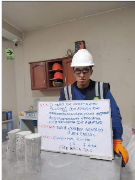
Fotografía N° 65: Se muestran los testigos cilíndricos ensayados a compresión incorporados al 1% de cascarilla de café para determinar su resistencia a los 7 días de edad, de acuerdo a los establecido por la norma NTP 339.034 / ASTM C39.
