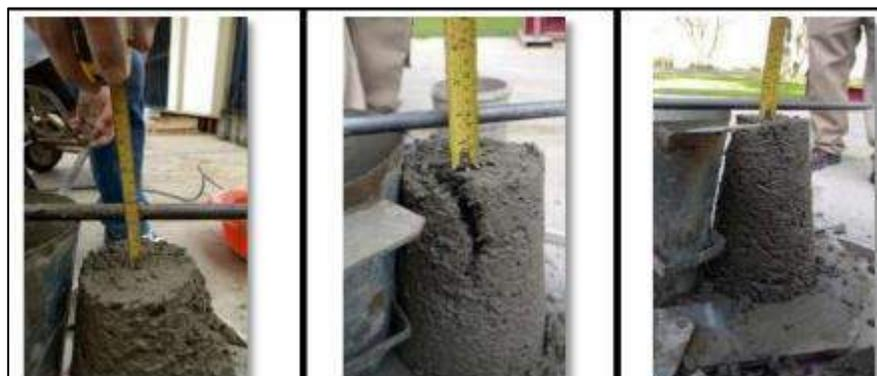
*Figura 18. Ensayo de asentamiento*
