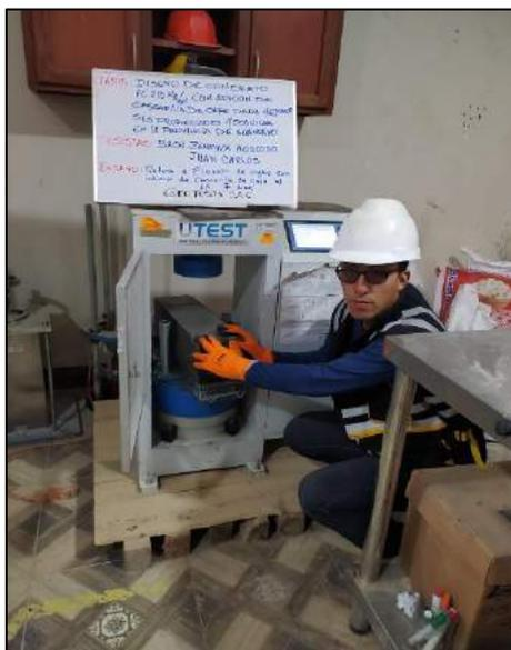
Fotografía N° 86: Se muestra a los testigos verticales con una incorporación del 1% de cascarilla de café con el fin de determinar la resistencia a la flexión al transcurrir los 7 días de edad, en base al criterio establecido por la norma NTP 339.034 / ASTM C39.
