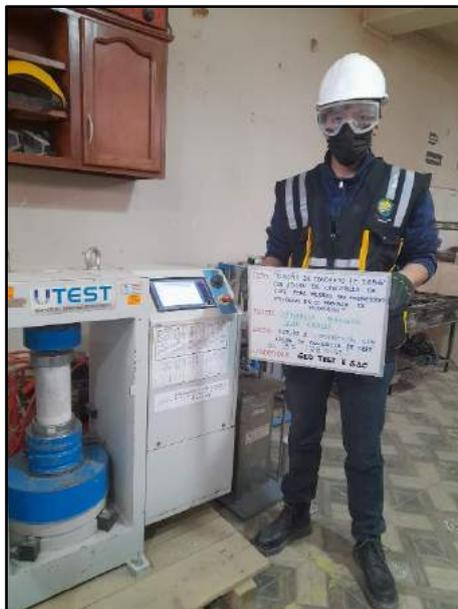
Fotografía N° 78: Se muestran los testigos cilíndricos ensayados a compresión incorporados al 3% de cascarilla de café para determinar su resistencia a los 28 días de edad, de acuerdo a los establecido por la norma NTP 339.034 / ASTM C39.
