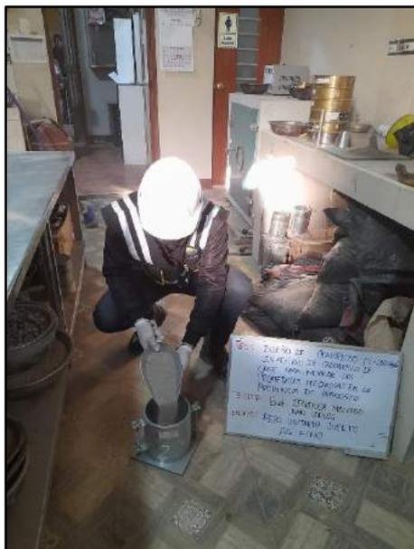
Fotografía N° 8: Se determino el peso unitario suelto y el % de vacíos del agregado fino, de acuerdo a la norma NTP 400.017.
