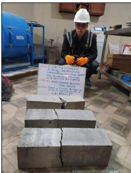
Fotografía N° 89: Se muestra a los testigos verticales con una incorporación del 1% de cascarilla de café con el fin de determinar la resistencia a la flexión al transcurrir los 14 días de edad, en base al criterio establecido por la norma NTP 339.034 / ASTM C39.
