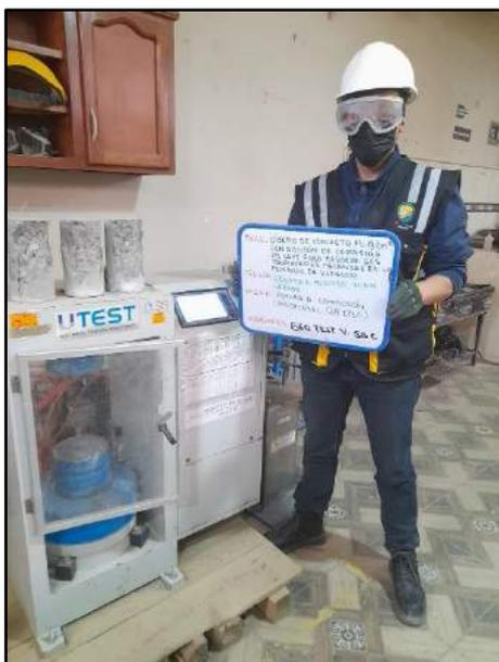
Fotografía N° 63: Se muestran los testigos cilíndricos convencionales transcurridos los 28 días de edad para determinar la resistencia a la compresión, en base al criterio establecido por la norma NTP 339.034 /ASTM C39.
