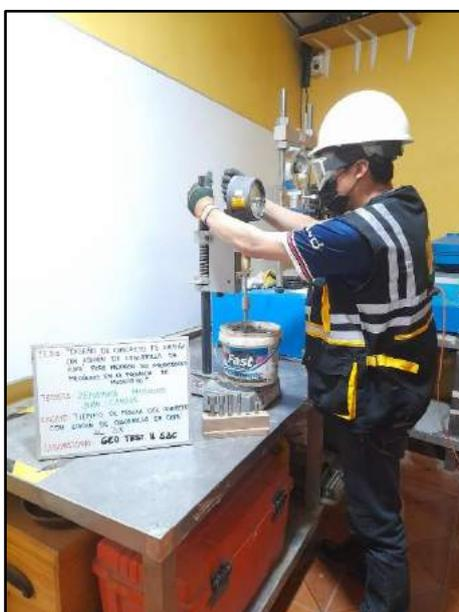
Fotografía N° 54: Se muestra el control de penetración de distintos diámetros de agujas para la comprobación del tiempo para el fraguado con 3% de cascarilla de café, en base al criterio establecido por la norma NTP 400.037.
