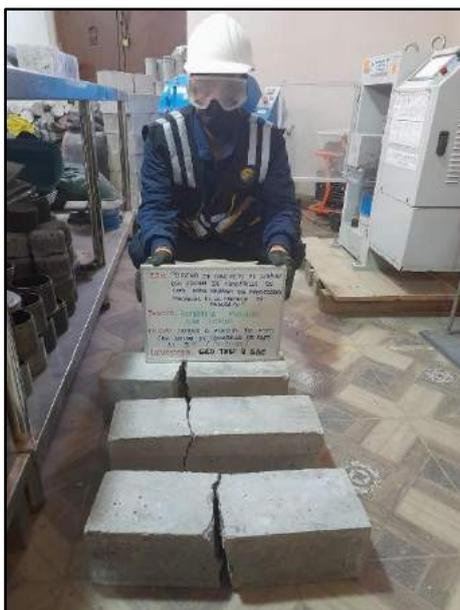
Fotografía N° 101: Se muestra a los testigos verticales con una incorporación del 3% de cascarilla de café con el fin de determinar la resistencia a la flexión al transcurrir los 14 días de edad, en base al criterio establecido por la norma NTP 339.034 / ASTM C39.
