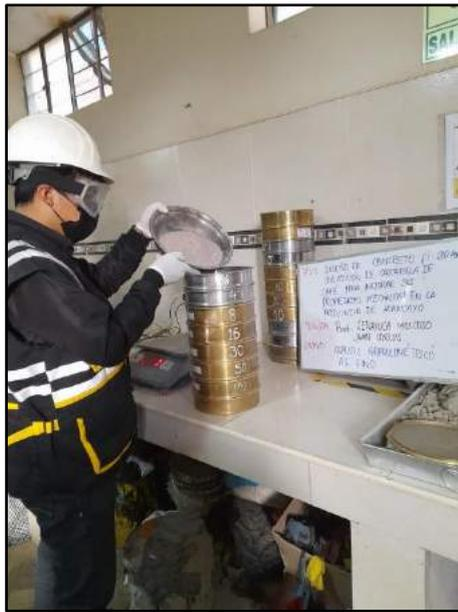
Fotografía N°1: Se realizo el ensayo de análisis granulométrico del agregado fino, de acuerdo a la norma NTP 400.012.
