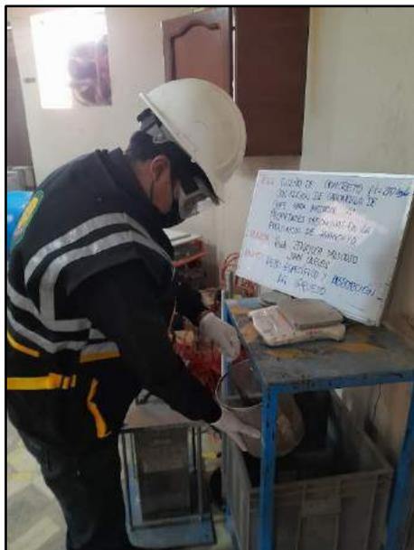
Fotografía N° 6: Se realizó el ensayo para el agregado grueso superficialmente seco en la canastilla metálica y así determinar su peso sumergido en el agua, a una temperatura de 23°C, de acuerdo a la norma NTP 400.022.
