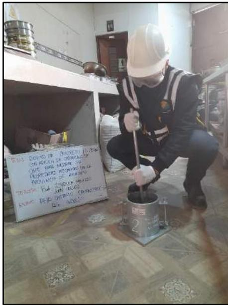
Fotografía N° 9: Se determino el del peso unitario compactado y el % de vacíos del agregado grueso, de acuerdo a la norma NTP 400.017.
