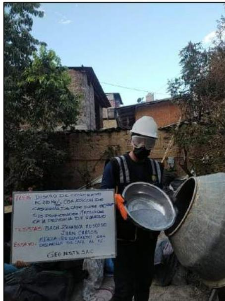
Fotografía N° 26: Se observa cómo se vierte la cascarilla de café con un porcentaje del 1% para su mezcla en el concreto, de acuerdo a la norma NTP 339.183.
