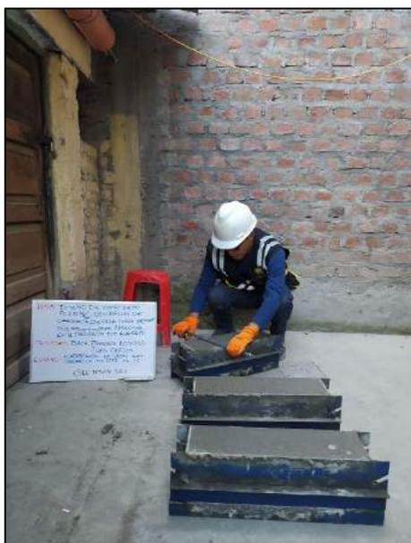
Fotografía N° 33: Se muestra la elaboración de testigos rectangulares con la incorporación de 1% de cascarilla de café, para sus correspondientes tipos de ensayos, de acuerdo a lo establecido por la norma NTP 339.034 / ASTM C39.
