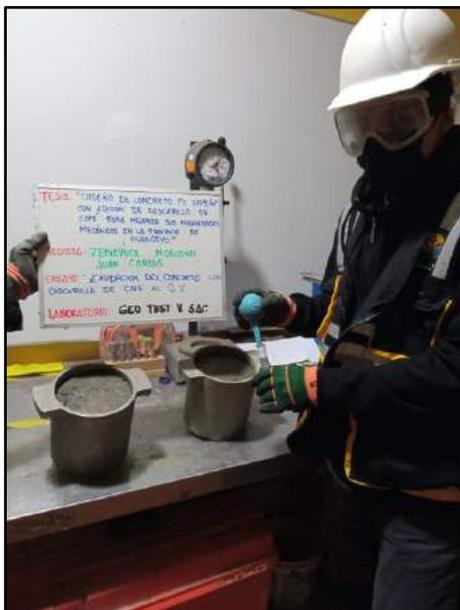
Fotografía N° 43: Se muestra el ensayo de control de la exudación con la incorporación del 2% de cascarilla de café, según referencia de la norma NTP 339.037.
