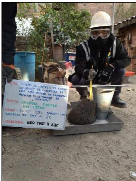
Fotografía N° 40: Se muestra la medición del asentamiento del concreto fresco con la incorporación del 2% de cascarilla de café, de acuerdo a la norma NTP 339.035.
