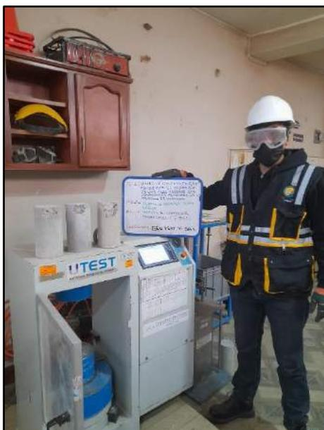
Fotografía N° 59: Se muestran los testigos cilíndricos convencionales transcurridos los 7 días de edad para determinar la resistencia a la compresión, en base al criterio establecido por la norma NTP 339.034 /ASTM C39.
