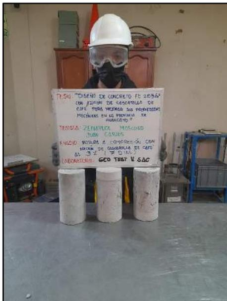
Fotografía N° 76: Se muestran los testigos cilíndricos ensayados a compresión incorporados al 3% de cascarilla de café para determinar su resistencia a los 7 días de edad, de acuerdo a los establecido por la norma NTP 339.034 / ASTM C39.
