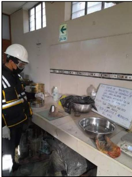
Fotografía N° 3: Se realizo el ensayo con el molde cónico-metálico de  $40\text{mm}\pm 3\text{mm}$  de diámetro y la varilla de apisonamiento de  $340\pm 15\text{g}$ , de acuerdo a la norma NTP 400.022.
