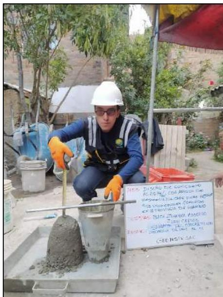
Fotografía N° 28: Se muestra la medición del asentamiento del concreto fresco con la incorporación del 1% de cascarilla de café, de acuerdo a la norma NTP 339.035.
