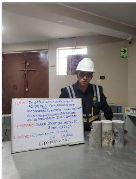
Fotografía N° 67: Se muestran los testigos cilíndricos ensayados a compresión incorporados al 1% de cascarilla de café para determinar su resistencia a los 14 días de edad, de acuerdo a los establecido por la norma NTP 339.034 / ASTM C39.
