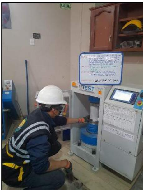
Fotografía N° 62: Se muestran los testigos cilíndricos convencionales transcurridos los 28 días de edad para determinar la resistencia a la compresión, en base al criterio establecido por la norma NTP 339.034 /ASTM C39.
