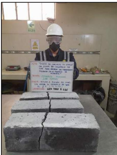
Fotografía N° 95: Se muestra a los testigos verticales con una incorporación del 2% de cascarilla de café con el fin de determinar la resistencia a la flexión al transcurrir los 14 días de edad, en base al criterio establecido por la norma NTP 339.034 / ASTM C39.
