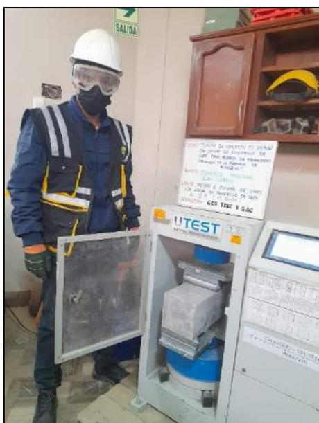
Fotografía N° 94: Se muestra a los testigos verticales con una incorporación del 2% de cascarilla de café con el fin de determinar la resistencia a la flexión al transcurrir los 14 días de edad, en base al criterio establecido por la norma NTP 339.034 / ASTM C39.
