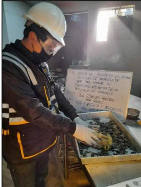
Fotografía N° 5: Se realizó el Método de ensayo normalizado para determinar el peso específico y absorción del agregado grueso, de acuerdo a la norma NTP 400.022.
