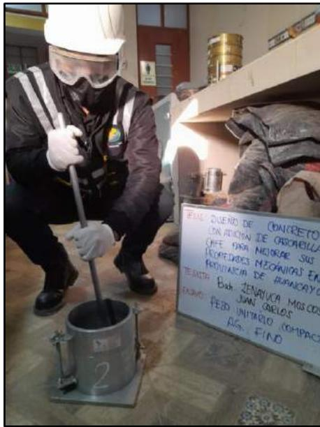
Fotografía N° 7: Se determino el peso unitario compactado y el % de vacíos del agregado fino, de acuerdo a la norma NTP 400.017.
