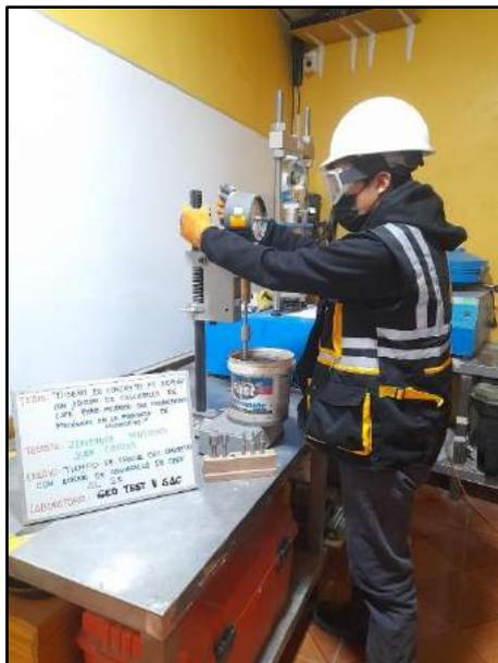
Fotografía N° 42: Se muestra el control de penetración de distintos diámetros de agujas para la comprobación del tiempo para el fraguado con 2% de cascarilla de café, en base al criterio establecido por la norma NTP 400.037.
