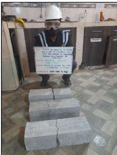
Fotografía N° 81: Se muestran los testigos verticales convencionales transcurridos los 7 días de edad para determinar la resistencia a la flexión, en base al criterio establecido por la norma NTP 339.034 /ASTM C39.
