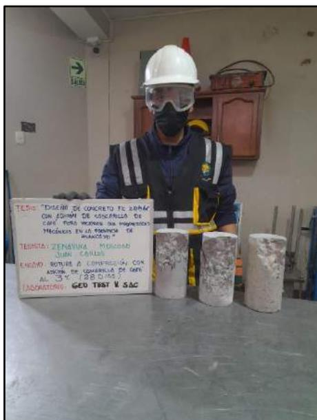
Fotografía N° 79: Se muestran los testigos cilíndricos ensayados a compresión incorporados al 3% de cascarilla de café para determinar su resistencia a los 28 días de edad, de acuerdo a los establecido por la norma NTP 339.034 / ASTM C39.
