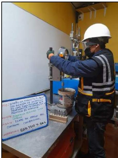
Fotografía N° 18: Se muestra el control de penetración de distintos diámetros de agujas para la comprobación del tiempo para el fraguado convencional, en base al criterio establecido por la norma NTP 400.037.
