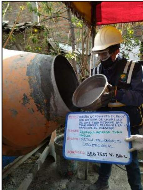
Fotografía N° 11: Se observa cómo se vierte el cemento para la elaboración del concreto convencional, de acuerdo a la norma NTP 339.183.
