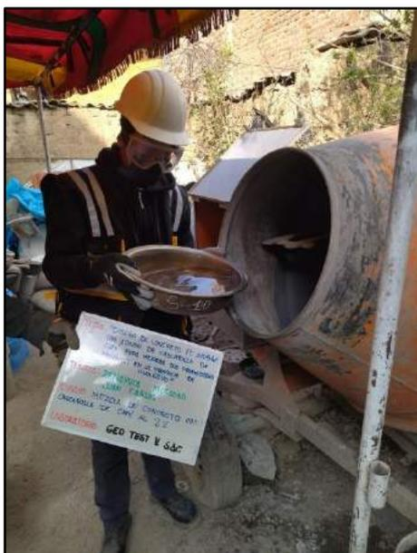
Fotografía N° 37: Se observa cómo se vierte el agua para la elaboración del concreto con adición del 2% de cascarilla de café, de acuerdo a la norma NTP 339.183.
