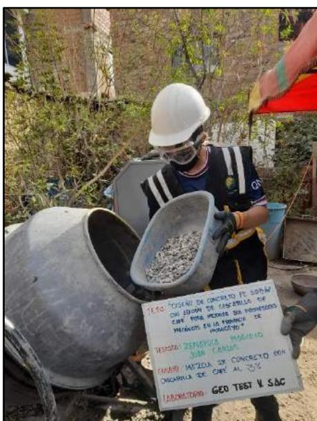
Fotografía N° 47: Se observa cómo se vierte el agregado grueso para la elaboración del concreto con adición del 3% de cascarilla de café, de acuerdo a la norma NTP 339.183.
