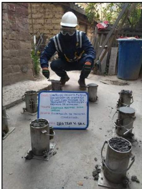
Fotografía N° 20: Se muestra la elaboración de testigos cilíndricos convencionales para sus correspondientes tipos de ensayos, de acuerdo a lo establecido por la norma NTP 339.034 / ASTM C39.
