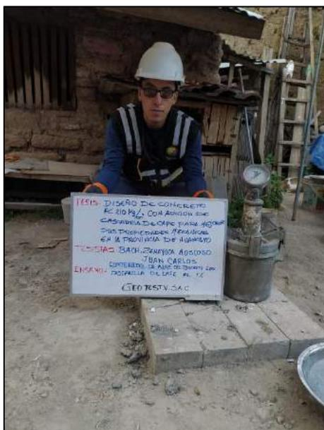
Fotografía N° 29: Se muestra el control del contenido de aire del concreto fresco con la incorporación del 1% de cascarilla de café ejecutado por el método de presión, de acuerdo a la norma NTP 339.083.
