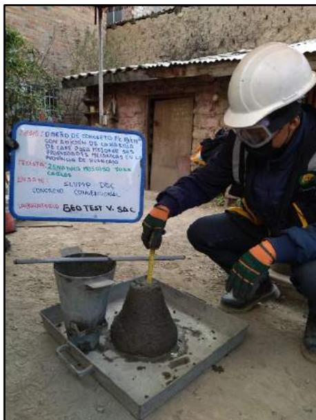
Fotografía N° 16: Se muestra la medición del asentamiento del concreto convencional, de acuerdo a la norma NTP 339.035.
