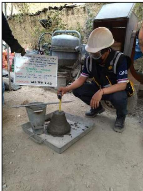
Fotografía N° 52: Se muestra la medición del asentamiento del concreto fresco con la incorporación del 3% de cascarilla de café, de acuerdo a la norma NTP 339.035.
