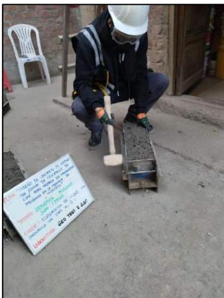
Fotografía N° 45: Se muestra la elaboración de testigos rectangulares con la incorporación de 2% de cascarilla de café, para sus correspondientes tipos de ensayos, de acuerdo a lo establecido por la norma NTP 339.034 / ASTM C39.
