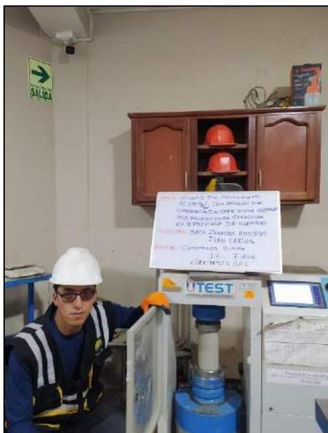
Fotografía N° 64: Se muestran los testigos cilíndricos ensayados a compresión incorporados al 1% de cascarilla de café para determinar su resistencia a los 7 días de edad, de acuerdo a los establecido por la norma NTP 339.034 / ASTM C39.
