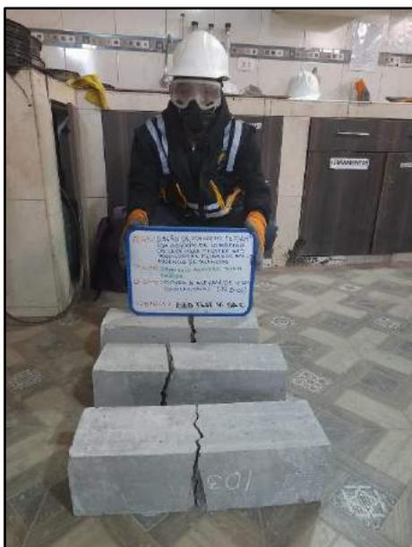
Fotografía N° 85: Se muestran los testigos verticales convencionales transcurridos los 28 días de edad para determinar la resistencia a la flexión, en base al criterio establecido por la norma NTP 339.034 /ASTM C39.
