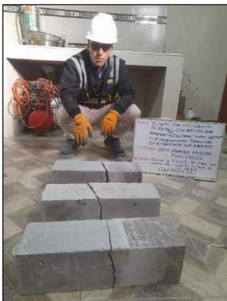
Fotografía N° 91: Se muestra a los testigos verticales con una incorporación del 1% de cascarilla de café con el fin de determinar la resistencia a la flexión al transcurrir los 28 días de edad, en base al criterio establecido por la norma NTP 339.034 / ASTM C39.
