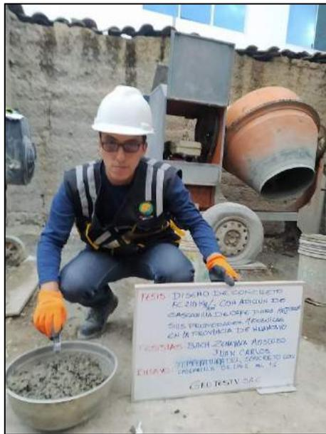
Fotografía N° 27: Se muestra la medición de la temperatura del concreto con la incorporación del 3% de cascarilla de café, de acuerdo a la norma NTP 339.184.
