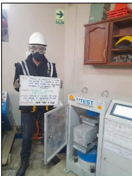
Fotografía N° 96: Se muestra a los testigos verticales con una incorporación del 2% de cascarilla de café con el fin de determinar la resistencia a la flexión al transcurrir los 28 días de edad, en base al criterio establecido por la norma NTP 339.034 / ASTM C39.
