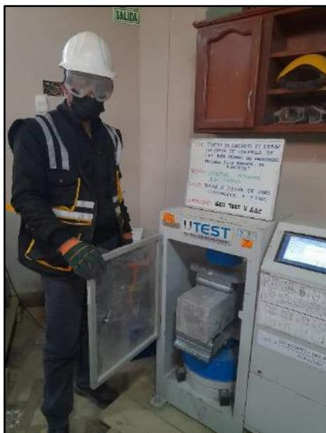
Fotografía N° 80: Se muestran los testigos verticales convencionales transcurridos los 7 días de edad para determinar la resistencia a la flexión, en base al criterio establecido por la norma NTP 339.034 / ASTM C39.
