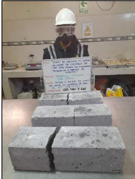
Fotografía N° 103: Se muestra a los testigos verticales con una incorporación del 3% de cascarilla de café con el fin de determinar la resistencia a la flexión al transcurrir los 28 días de edad, en base al criterio establecido por la norma NTP 339.034 / ASTM C39.
