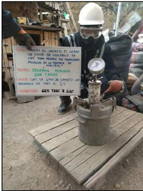
Fotografía N° 41: Se muestra el control del contenido de aire del concreto fresco con la incorporación del 2% de cascarilla de café ejecutado por el método de presión, de acuerdo a la norma NTP 339.083.
