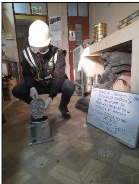
Fotografía N° 10: Se determino el peso unitario suelto y el % de vacíos del agregado grueso, de acuerdo a la norma NTP 400.017.
