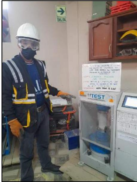
Fotografía N° 71: Se muestran los testigos cilíndricos ensayados a compresión incorporados al 2% de cascarilla de café para determinar su resistencia a los 14 días de edad, de acuerdo a los establecido por la norma NTP 339.034 / ASTM C39.
