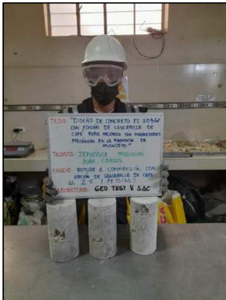
Fotografía N° 72: Se muestran los testigos cilíndricos ensayados a compresión incorporados al 2% de cascarilla de café para determinar su resistencia a los 14 días de edad, de acuerdo a los establecido por la norma NTP 339.034 / ASTM C39.
