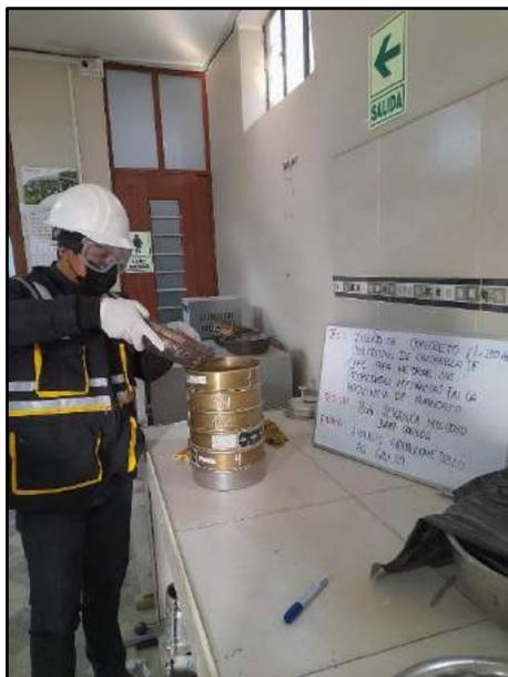
Fotografía N°2: Se realizo el ensayo de granulometría del agregado grueso, de acuerdo a la norma NTP 400.012.
