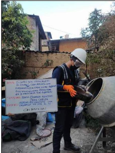
Fotografía N° 25: Se observa cómo se vierte el agua para la elaboración del concreto con adición del 1% de cascarilla de café, de acuerdo a la norma NTP 339.183.
