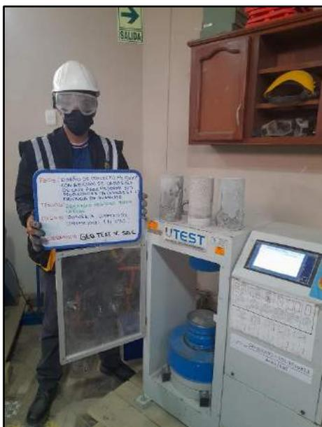
Fotografía N° 61: Se muestran los testigos cilíndricos convencionales transcurridos los 14 días de edad para determinar la resistencia a la compresión, en base al criterio establecido por la norma NTP 339.034/ASTM C39.
