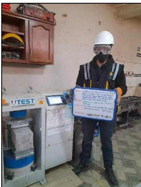
Fotografía N° 84: Se muestran los testigos verticales convencionales transcurridos los 28 días de edad para determinar la resistencia a la flexión, en base al criterio establecido por la norma NTP 339.034 /ASTM C39.
