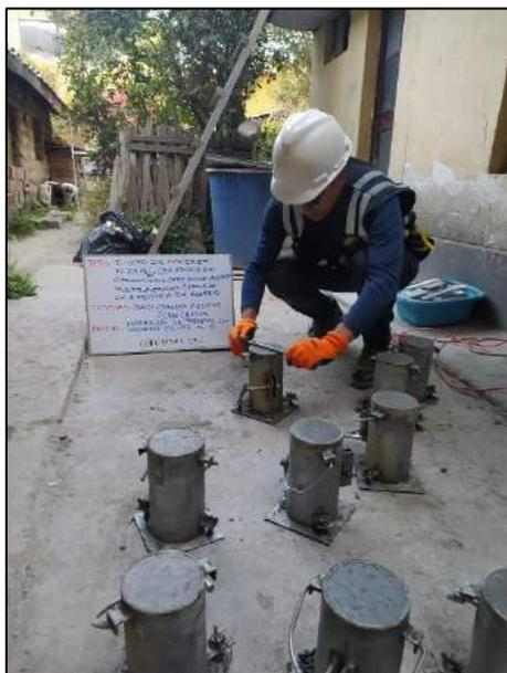
Fotografía N° 32: Se muestra la elaboración de testigos cilíndricos con la incorporación del 1% de cascarilla de café para sus correspondientes tipos de ensayos, según referencia de la norma NTP 339.034 / ASTM C39.
