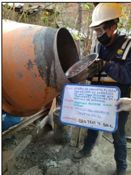
Fotografía N° 12: Se observa cómo se vierte el agregado grueso para la elaboración del concreto convencional, de acuerdo a la norma NTP 339.183.
