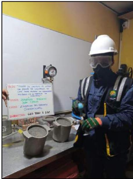
Fotografía N° 17: Se muestra el ensayo de control de la exudación del concreto convencional, según referencia de la norma NTP 339.037.
