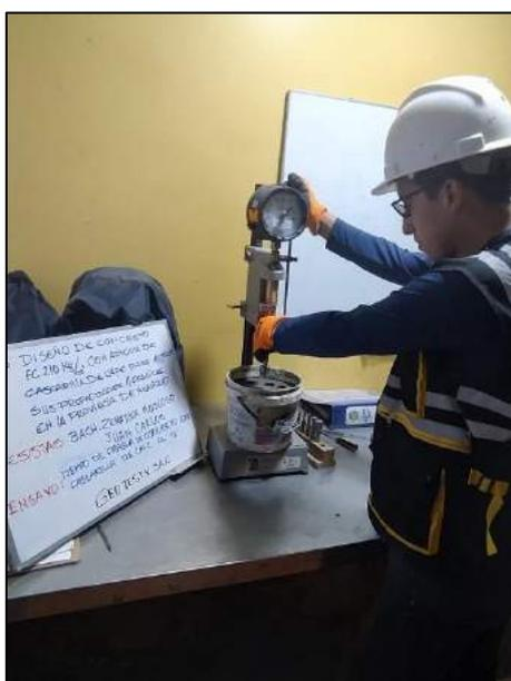
Fotografía N° 30: Se muestra el control de penetración de distintos diámetros de agujas para la comprobación del tiempo para el fraguado con 1% de cascarilla de café, en base al criterio establecido por la norma NTP 400.037.
