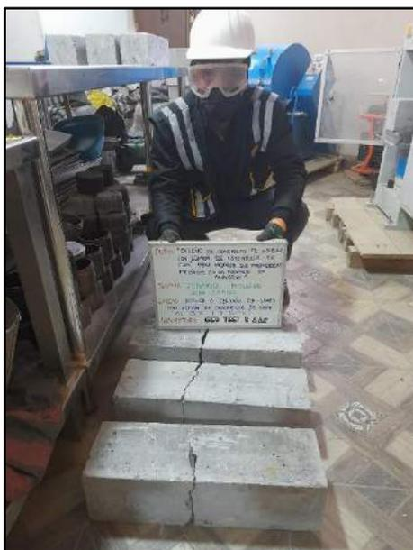
Fotografía N° 99: Se muestra a los testigos verticales con una incorporación del 3% de cascarilla de café con el fin de determinar la resistencia a la flexión al transcurrir los 7 días de edad, en base al criterio establecido por la norma NTP 339.034 / ASTM C39.
