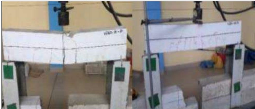
*Figura 11. Vigas ensayadas a esfuerzos de flexión*
