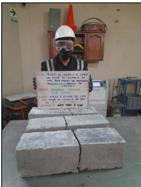
Fotografía N° 93: Se muestra a los testigos verticales con una incorporación del 2% de cascarilla de café con el fin de determinar la resistencia a la flexión al transcurrir los 7 días de edad, en base al criterio establecido por la norma NTP 339.034 / ASTM C39.
