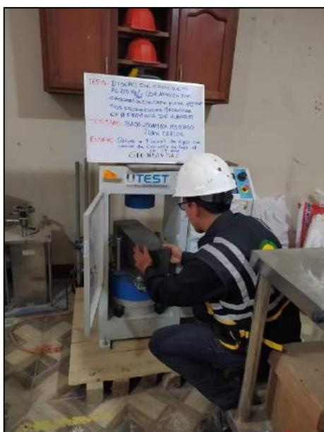
Fotografía N° 88: Se muestra a los testigos verticales con una incorporación del 1% de cascarilla de café con el fin de determinar la resistencia a la flexión al transcurrir los 14 días de edad, en base al criterio establecido por la norma NTP 339.034 / ASTM C39.
