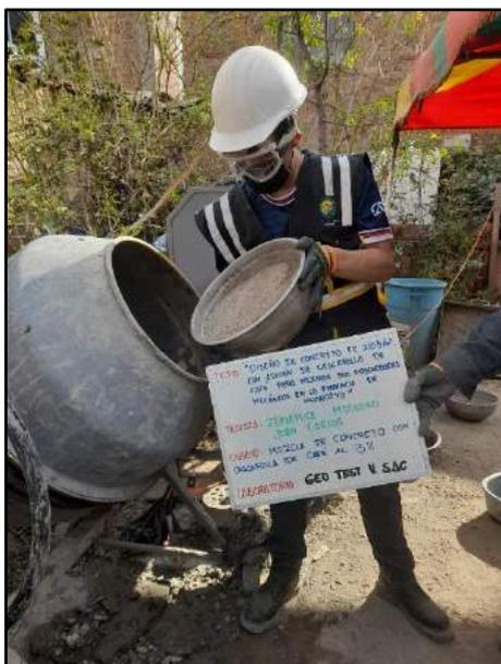
Fotografía N° 48: Se observa cómo se vierte el agregado fino para la elaboración del concreto con adición del 3% de cascarilla de café, de acuerdo a la norma NTP 339.183.
