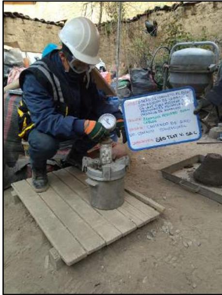
Fotografía N° 19: Se muestra el control del contenido de aire del concreto fresco convencional ejecutando el método de presión, de acuerdo a la norma NTP 339.083.
