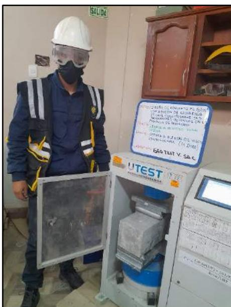
Fotografía N° 82: Se muestran los testigos verticales convencionales transcurridos los 14 días de edad para determinar la resistencia a la flexión, en base al criterio establecido por la norma NTP 339.034 /ASTM C39.
