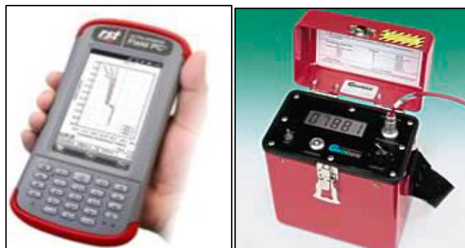
Figura N° 23: Unidad de lectura para inclinómetro
