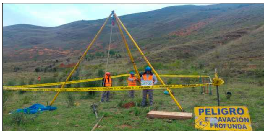
Figura N° 34: Ensayo de Penetración Estándar
