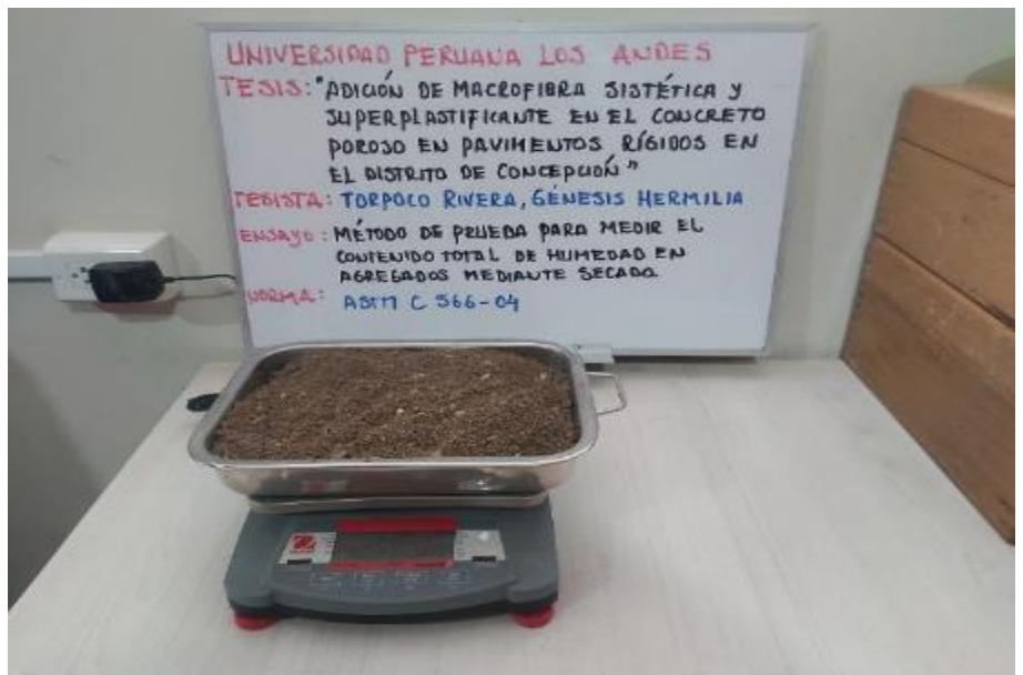
Fotografía 18: Pesado de agregado fino para el ensayo.
