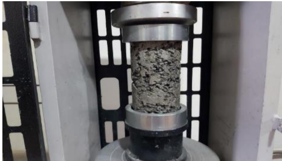
Fotografía 28: Proceso de rotura de testigos del ensayo de compresión.
