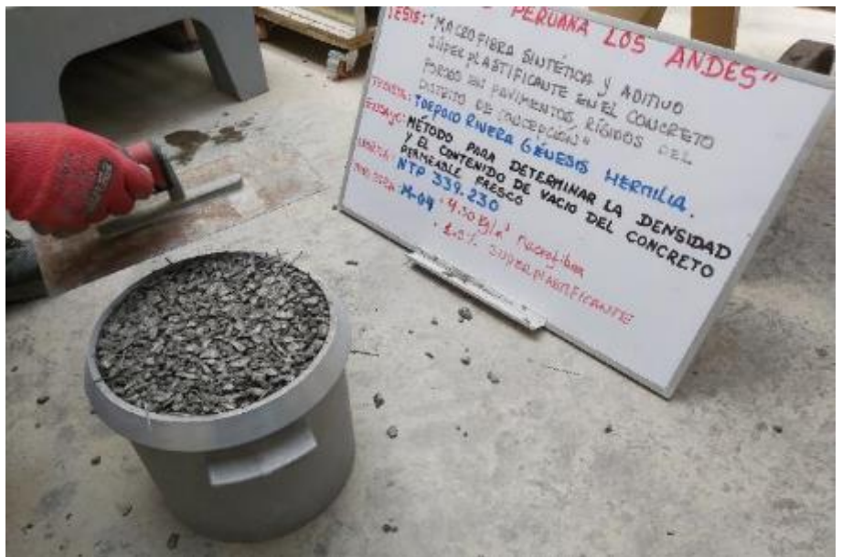
Fotografía 23: Colocado de mezcla dentro de un recipiente en capas de 3.
