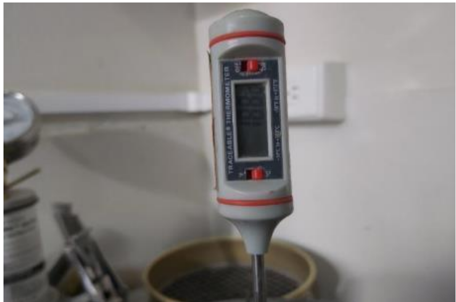
Fotografía 24: Toma de temperatura del concreto en estado fresco.
