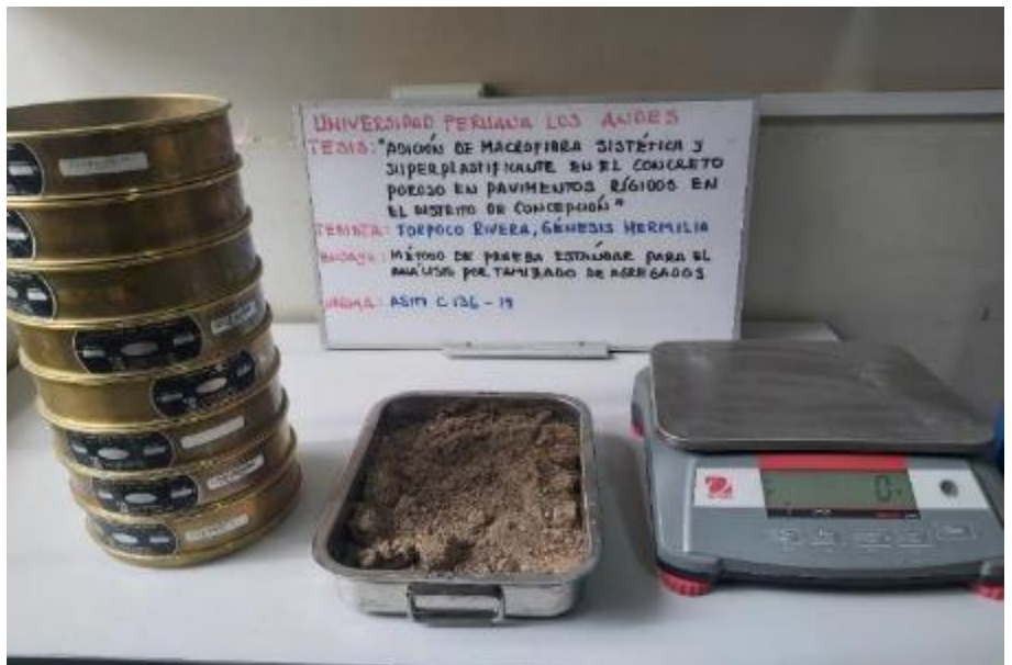
Fotografía 10: Tamizaje de agregado grueso, para el análisis granulométrico de agregado fino.
