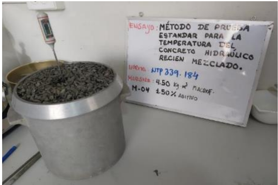
Fotografía 25: Toma de temperatura del concreto en estado fresco.
