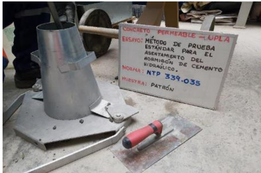
Fotografía 20: Equipos que se utilizaron en el ensayo de determinación de asentamiento.
