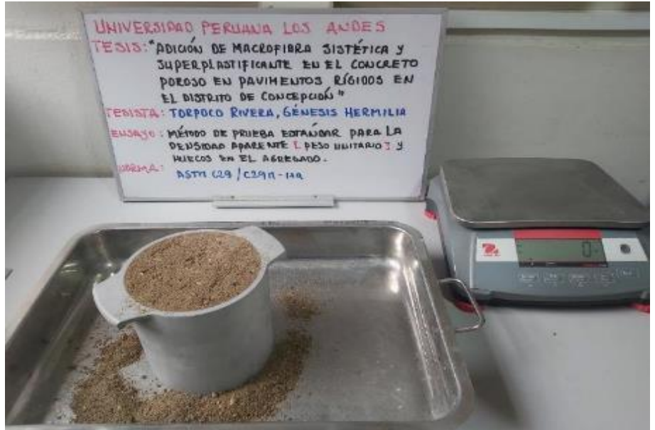
Fotografía 13: Proceso de llenado y peso del molde más el material fino
