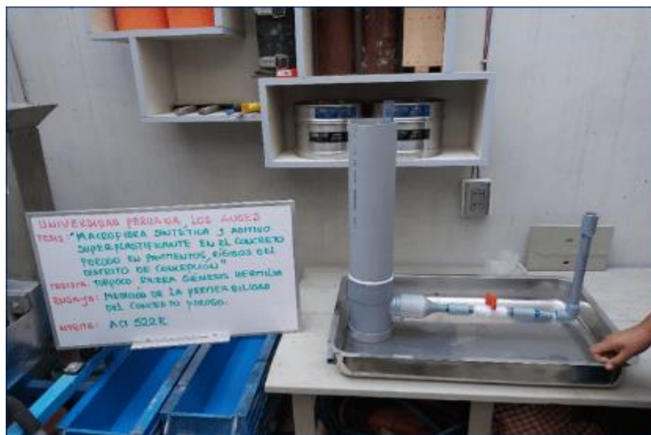
Fotografía 32: Equipo construido en el laboratorio para medir la permeabilidad.
