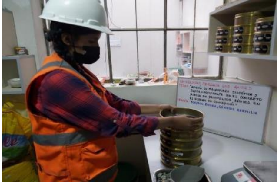
Fotografía 9: Tamizaje de agregado grueso, para el análisis granulométrico de agregado grueso.
