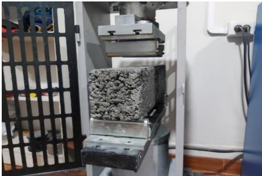
Fotografía 30: Método de prueba estándar para la resistencia a la flexión del concreto.
