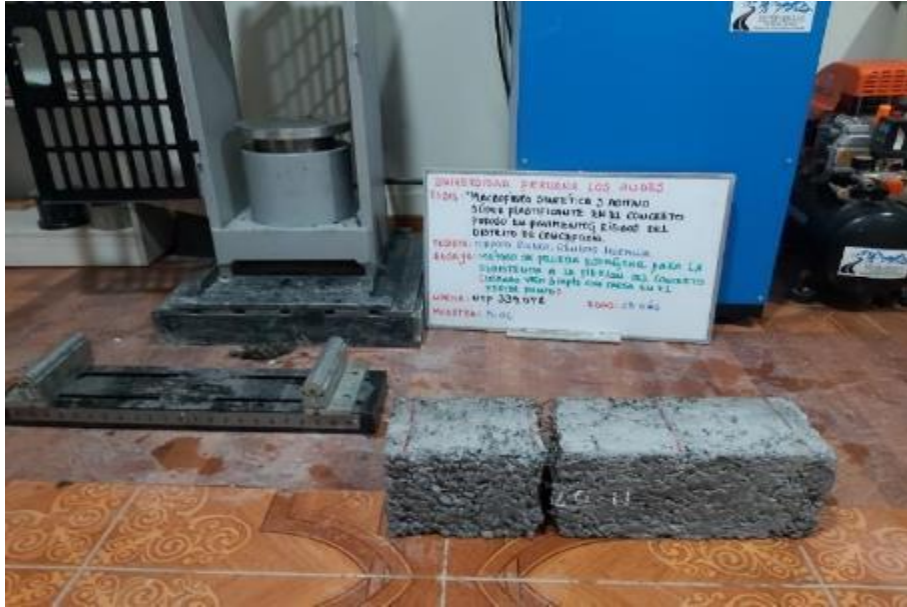
Fotografía 29: Método de prueba estándar para la resistencia a la flexión del concreto.
