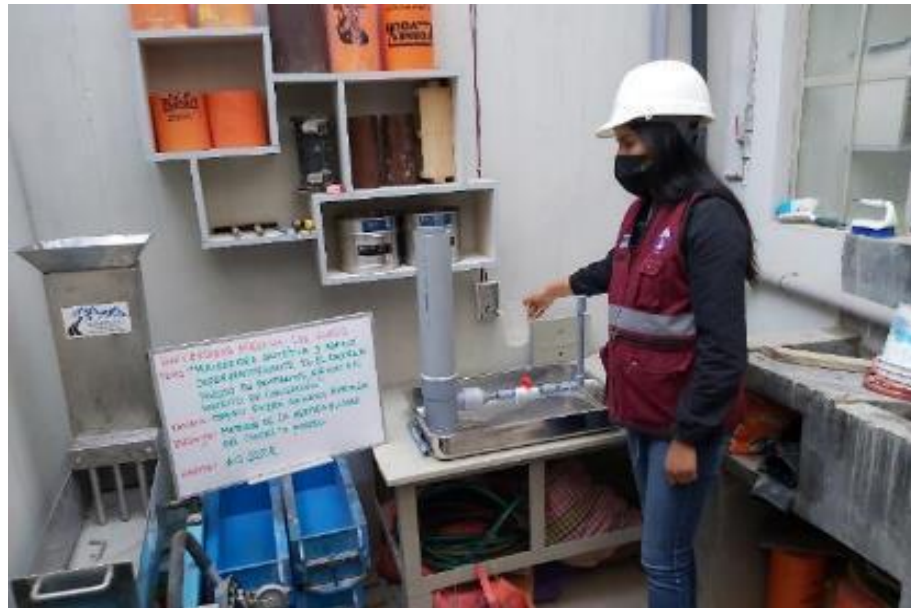
Fotografía 31 : Medición de la Permeabilidad del Concreto Poroso con Permeámetro de Carga Variable en Laboratorio.
