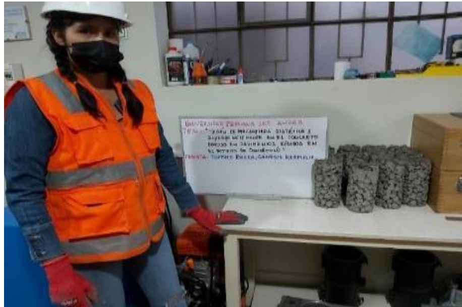
Fotografía 27: Testigos sometidos al ensayo de compresión
