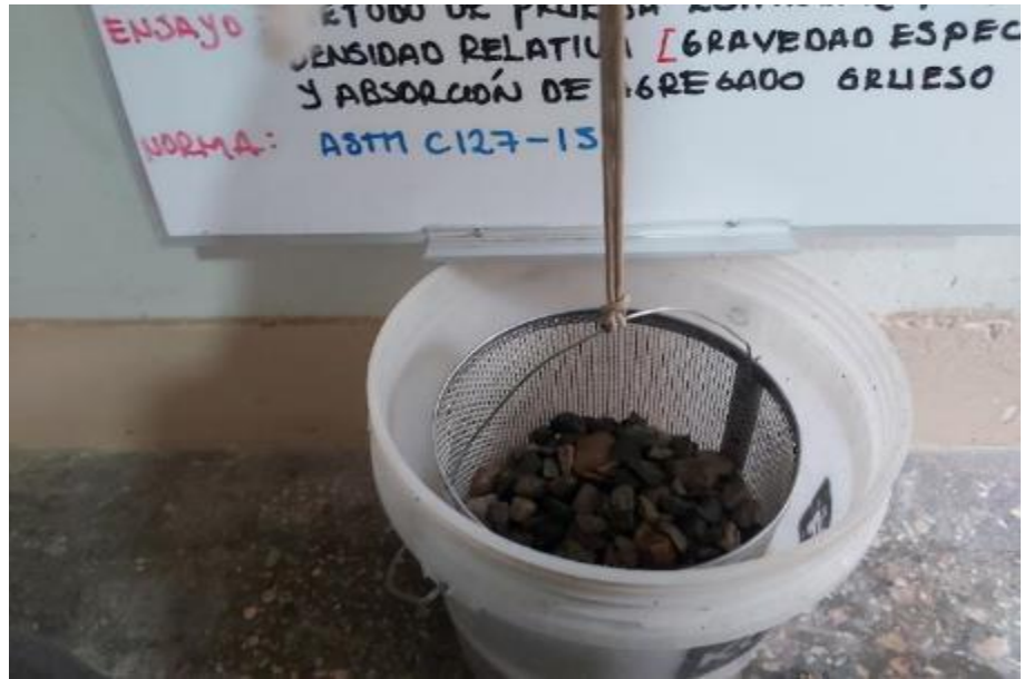
Fotografía 15: Proceso de pesado de muestra de agregado grueso sumergida en agua.
