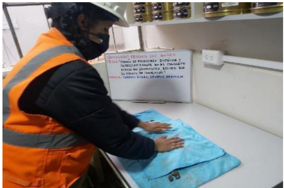
Fotografía 16: Proceso de secado superficial de agregado grueso.
