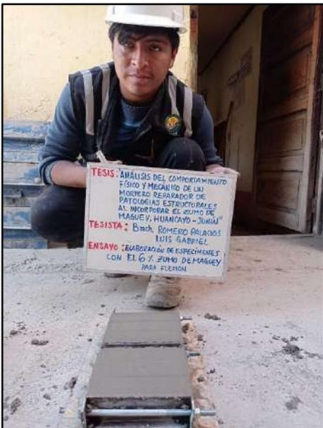
**MOLDEADO DE ESPECÍMENES DE MORTERO PARA LA RESISTENCIA A FLEXIÓN**
