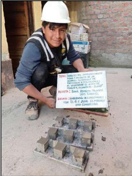
**MOLDEADO DE ESPECÍMENES DE MORTERO PARA LA RESISTENCIA A COMPRESIÓN**
