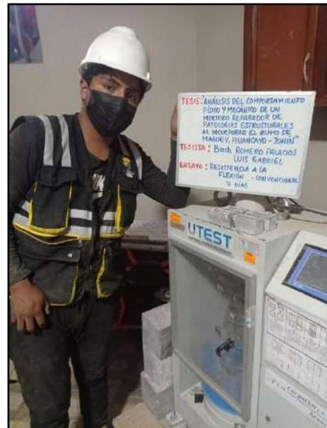
**ENSAYO DE RESISTENCIA A FLEXIÓN DEL MORTERO**
