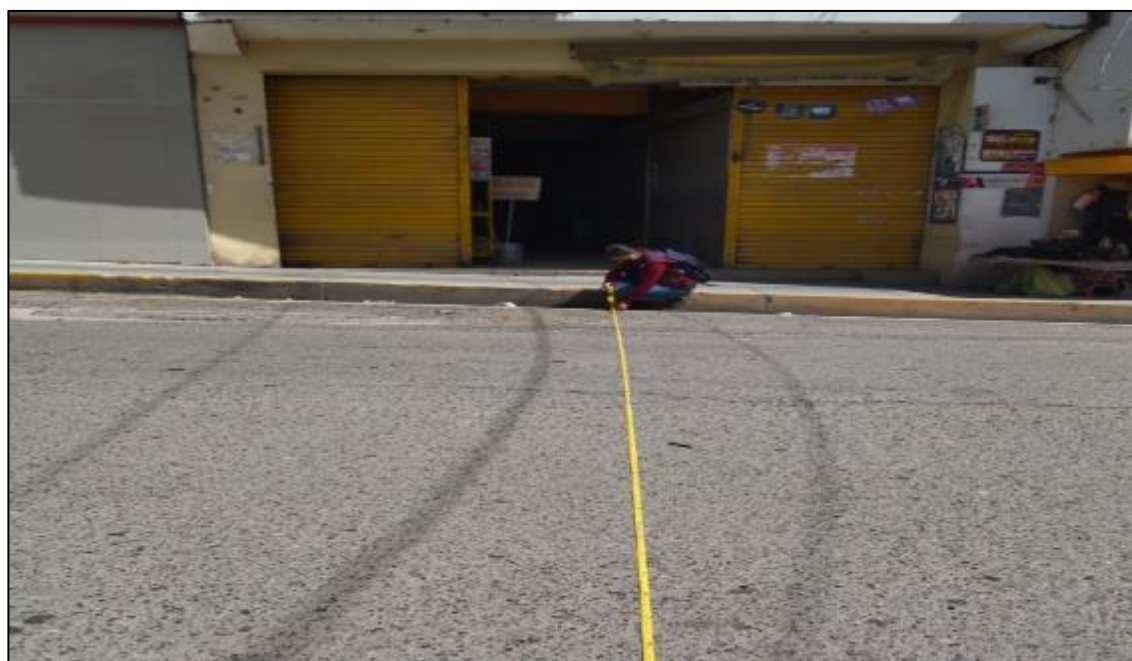
Fotografía N° 14: Se toma la medida de la sección transversal del Jr. Tarapacá, en el acceso Oeste a Este
