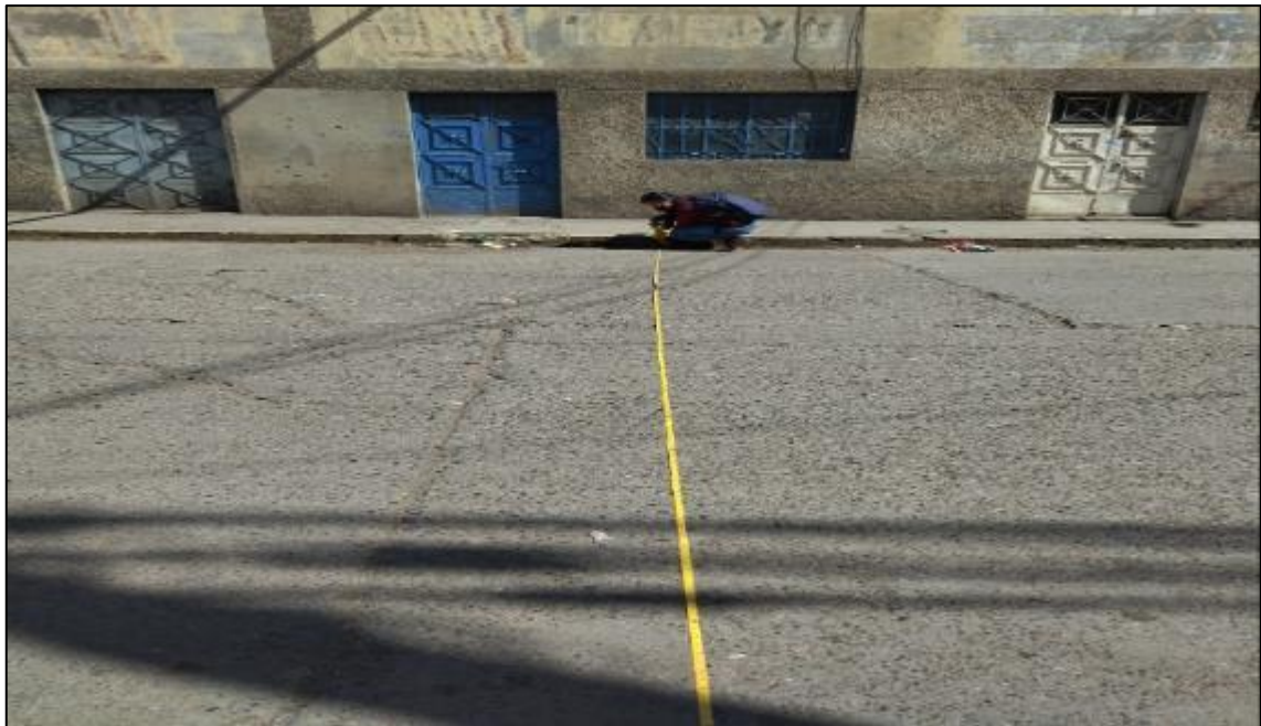
Fotografía N° 09: Se toma la medida de la sección transversal del Jr. Cajamarca, en el acceso Oeste -Este
