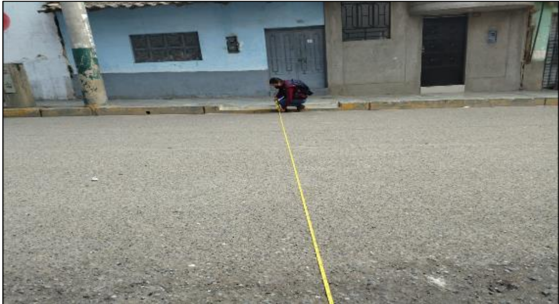
Fotografía N° 11: Se toma la medida de la sección transversal de la intersección de la Prolog. Huánuco, en el acceso Este -Oeste
