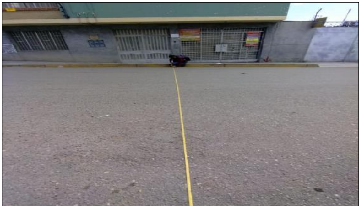
Fotografía N° 08: Se toma la medida de la sección transversal del Jr. Piura Antigua, en el acceso Este -Oeste
