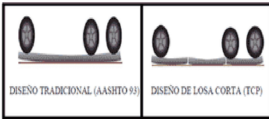
FIGURA 8. DIFERENCIA DEL DIMENSIONAMIENTO ENTRE LA LOSA TRADICIONAL (AASHTO 93) Y LA DE LOSA CORTA (TCP) (TC PAVEMENTS).
