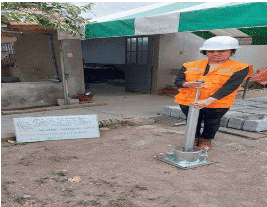
FOTOGRAFIA N°16: ESTUDIO DE SUELOS: FOTOS DE LOS ENSAYOS REALIZADOS (Ensayo de Proctor Modificado).
