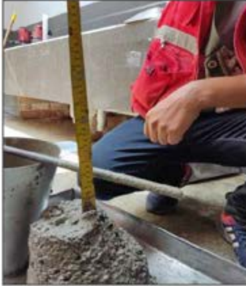
Foto 11: Determinación del Slump.
