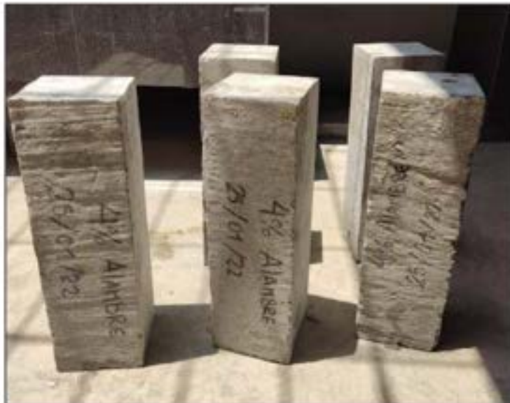
Foto 16: Preparación de las viguetas con adición del 4% de alambre 16 para ensayo a la resistencia a la flexión.
