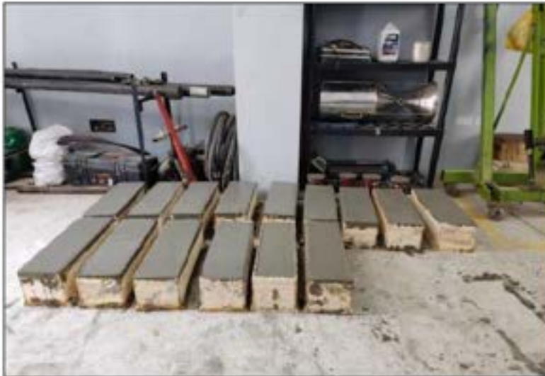
Foto 12: Viga patrón y viguetas con adición del alambre N° 16 en proporciones del 2%, 4% y 6%.
