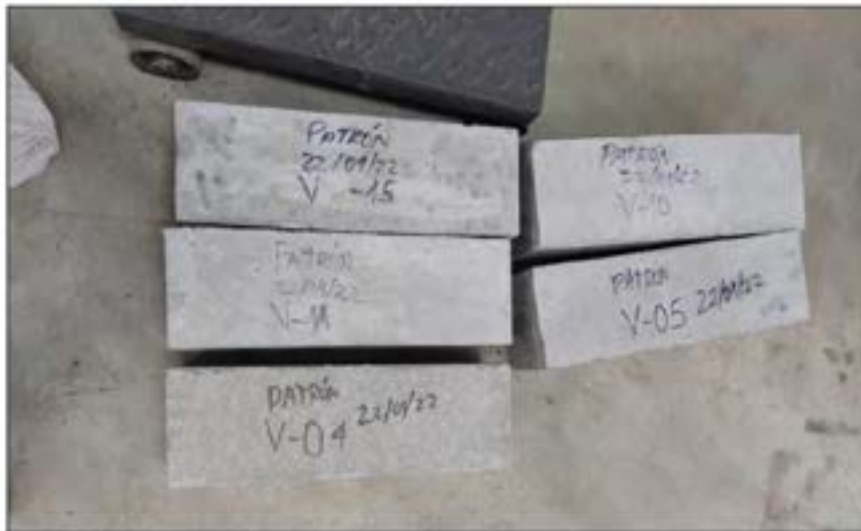
Foto 14: Preparación de la viga patrón para ensayo a la resistencia a la flexión.
