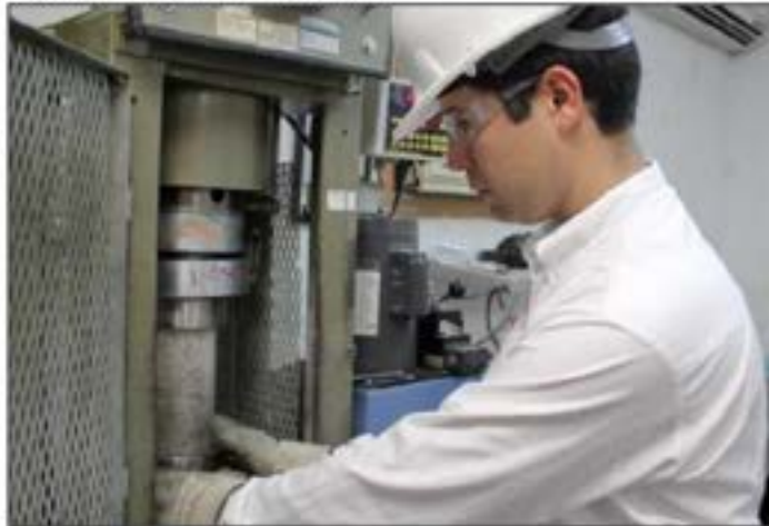
Figura 6: Ensayo a la compresión.
