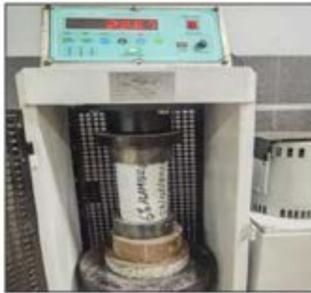
Figura 13: Ensayo a compresión.
