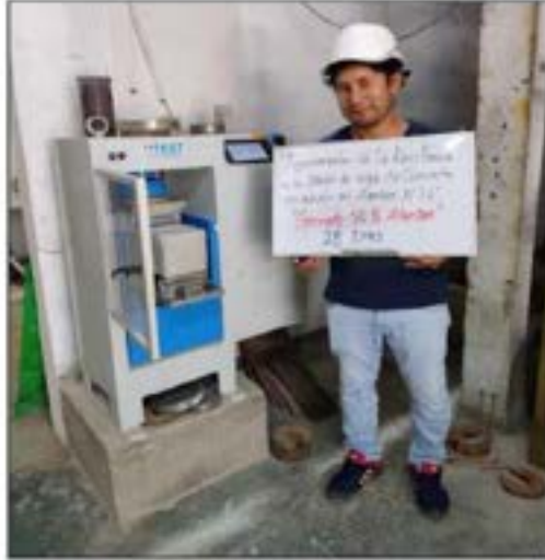
3 Foto 21: Ensayo de la resistencia a flexión de la viga con adición del 6% de alambre N° 16.
