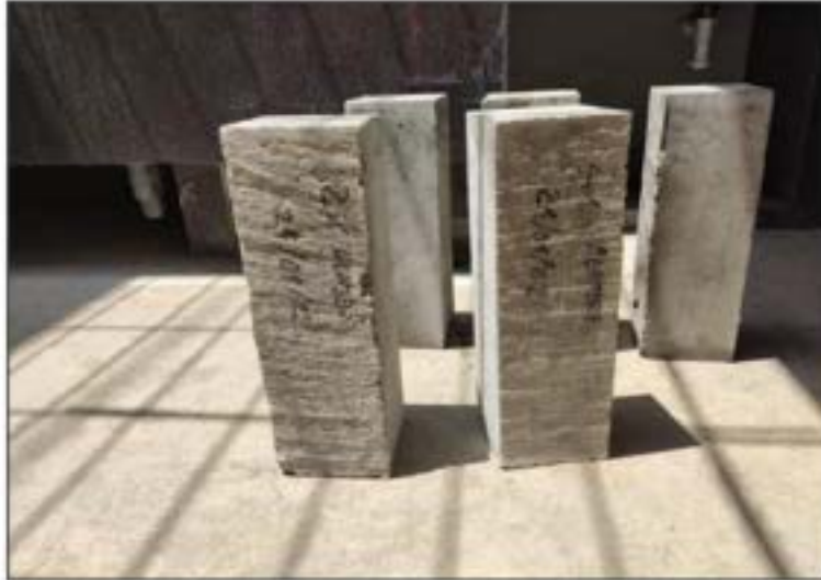
Foto 16: Preparación de las viguetas con adición del 4% de alambre 16 para ensayo a la resistencia a la flexión.
