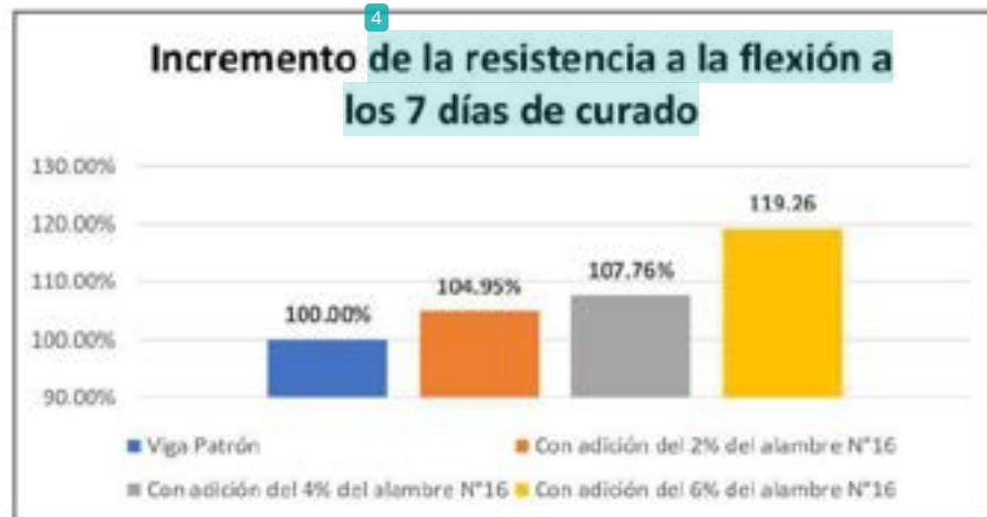
Figura 15: Incremento de la resistencia a la flexión a los 07 días de curado.
