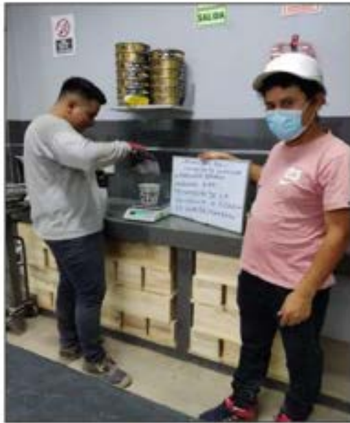
Foto 4: Secado de los agregados para la determinación del contenido de humedad.
