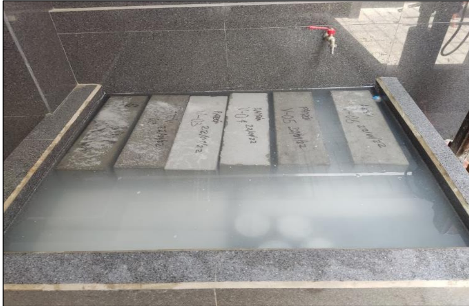
Foto 13: Curado de la viga patrón y las viguetas con adición del alambre N° 16.
