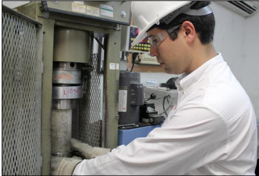
Figura 6: Ensayo a la compresión.
