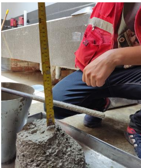
Figura 12: Ensayo del cono de Abrams.
