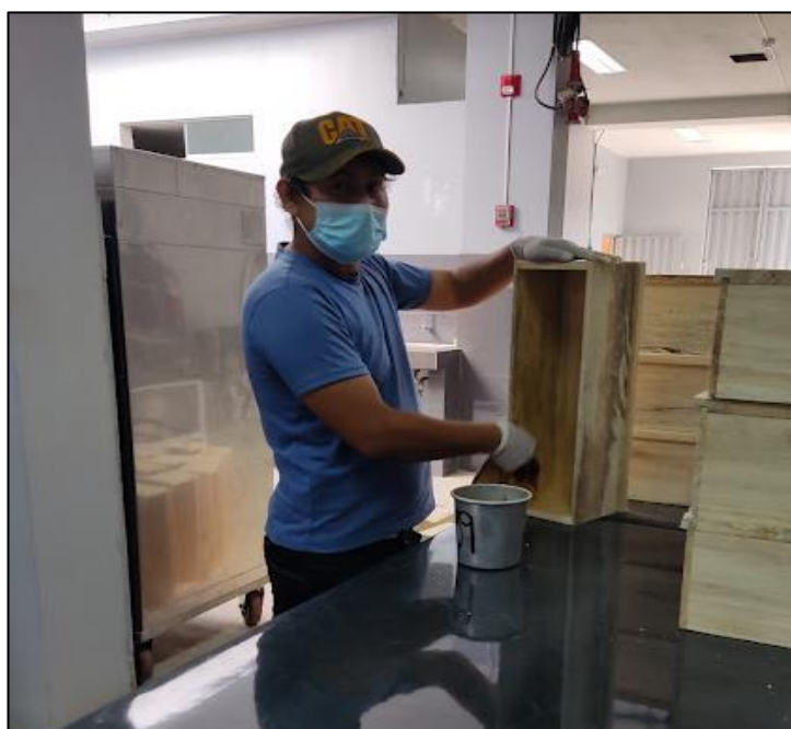
Foto 2: Preparación de los moldes para la elaboración de las viguetas.
