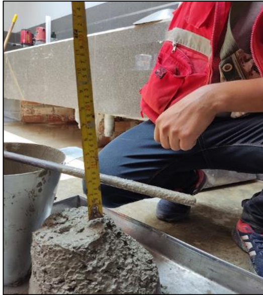
Figura 5: Ensayo del cono de Abrams.
