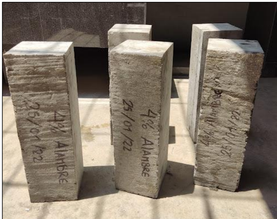
Foto 16: Preparación de las viguetas con adición del 4% de alambre 16 para ensayo a la resistencia a la flexión.
