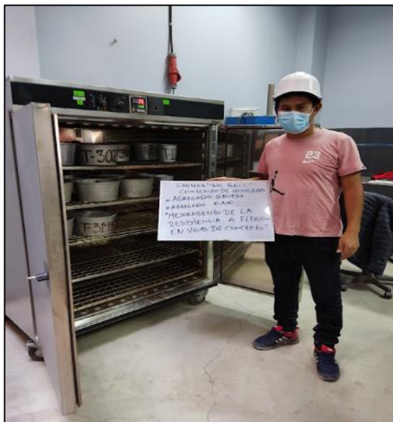
Foto 4: Secado de los agregados para la determinación del contenido de humedad.
