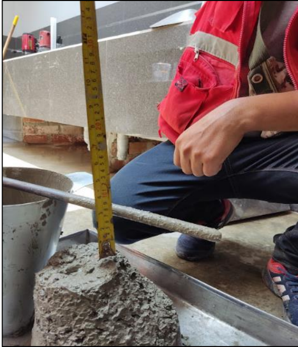
Foto 11: Determinación del Slump.
