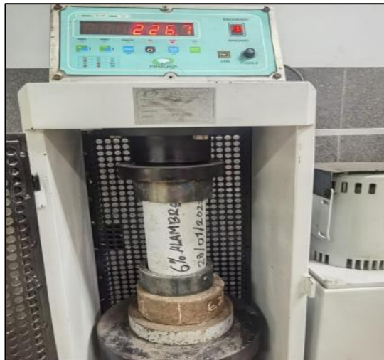
Figura 13: Ensayo a compresión.
