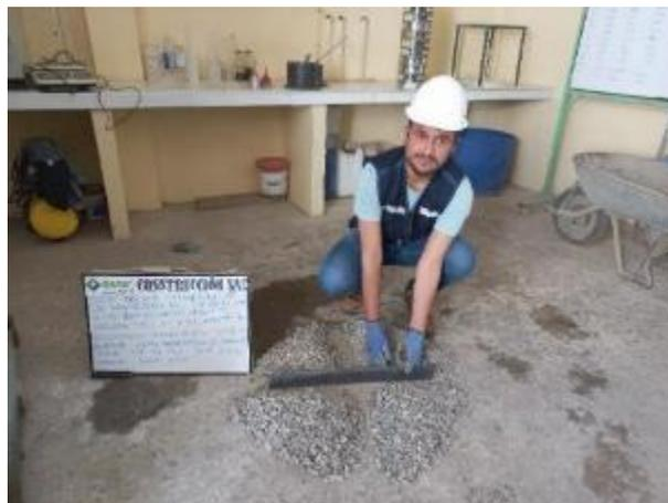
**Fotografía 02:** Todas las muestras ensayadas fueron extraídas por cuarteo previo muestreo en concordancia con la MTC E 201.
