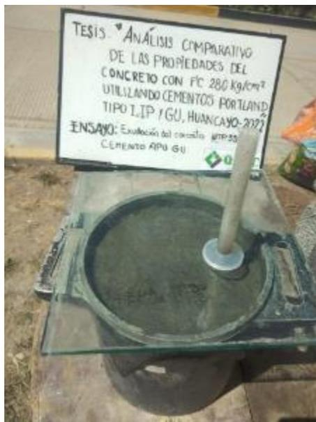
**Fotografía 07:** Vista general del ensayo de exudación del concreto empleando cemento APU GU.
