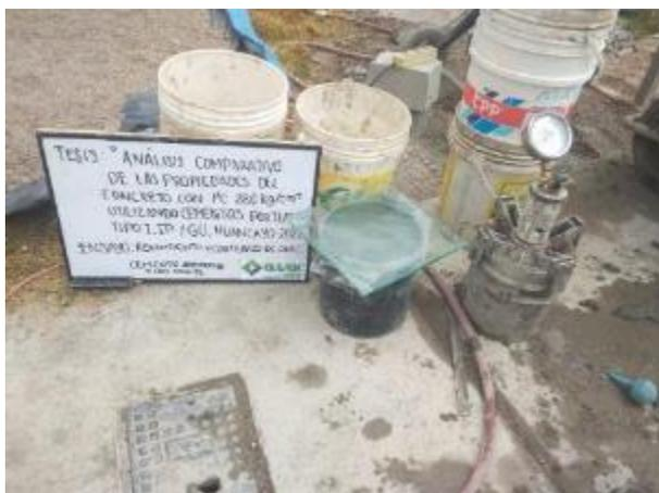
**Fotografía 08:** Vista general del ensayo de contenido de aire del concreto.
