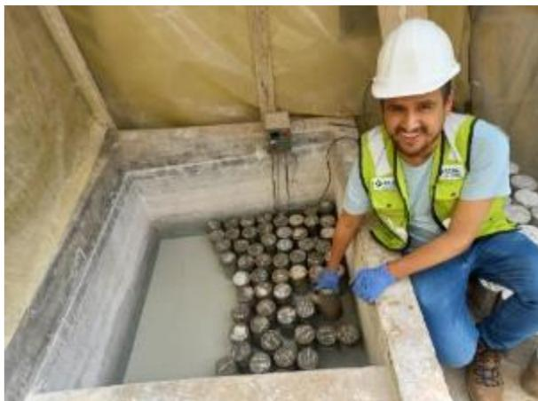
**Fotografía 05:** Los testigos elaborados y desencofrados, han sido sometidos a saturación en una poza de concreto, a una temperatura constante.
