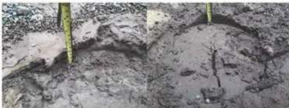
Figura 13. Vista del terreno después de los ensayos de placa de carga.
