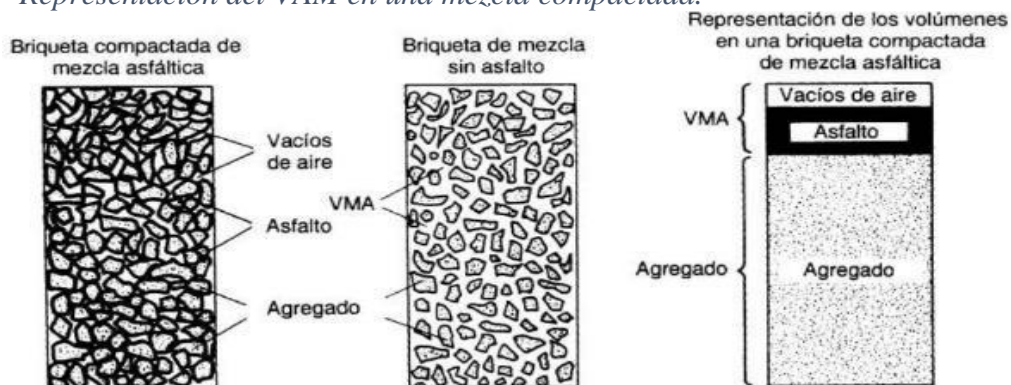
Figura 11: Representación del VAM en una mezcla compactada.
