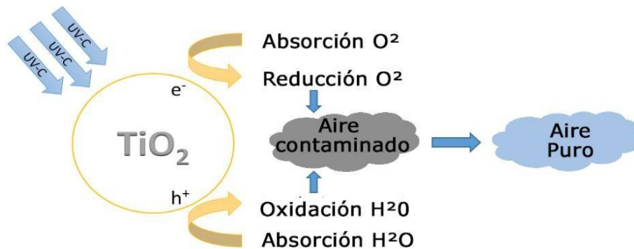
Figura 2: Conjunto de las reacciones que se producen en la superficie de un semiconductor, el TiO 2 , bajo la acción de una radiación UV adecuada.
