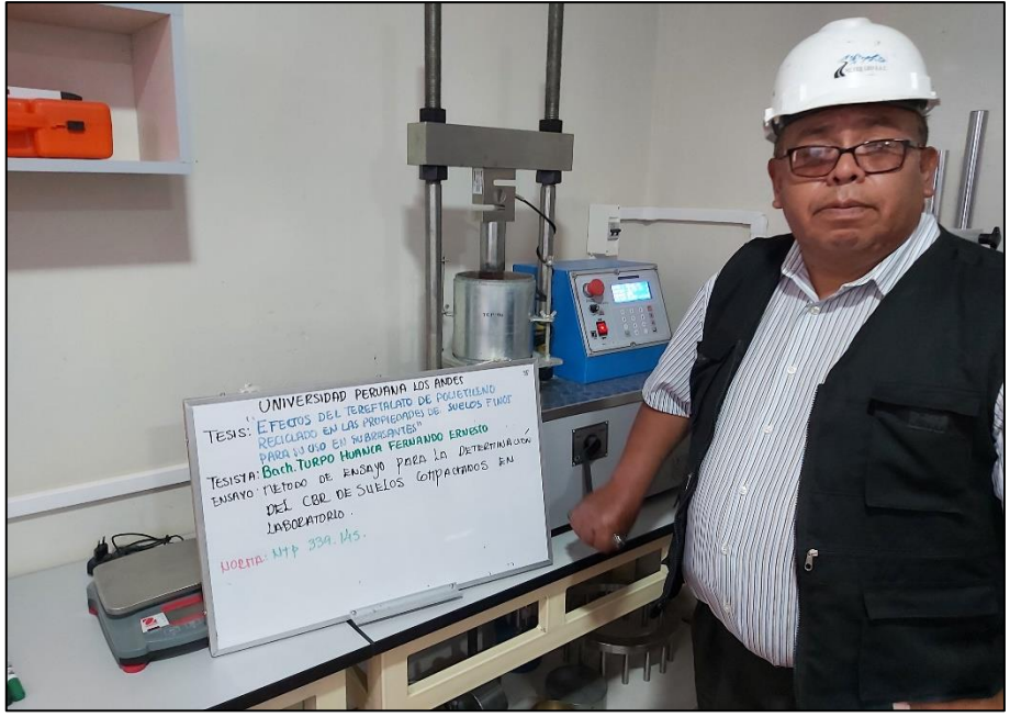
Fotografía 9. Ensayo CBR para las muestras de suelo.
