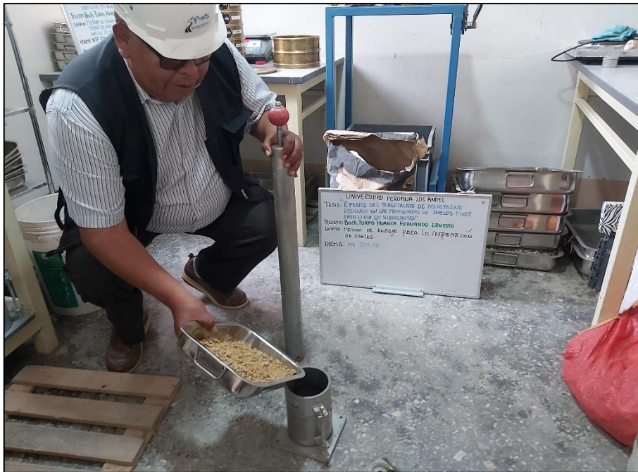
Fotografía 8. Ensayo de Proctor modificado sobre las muestras de suelo.
