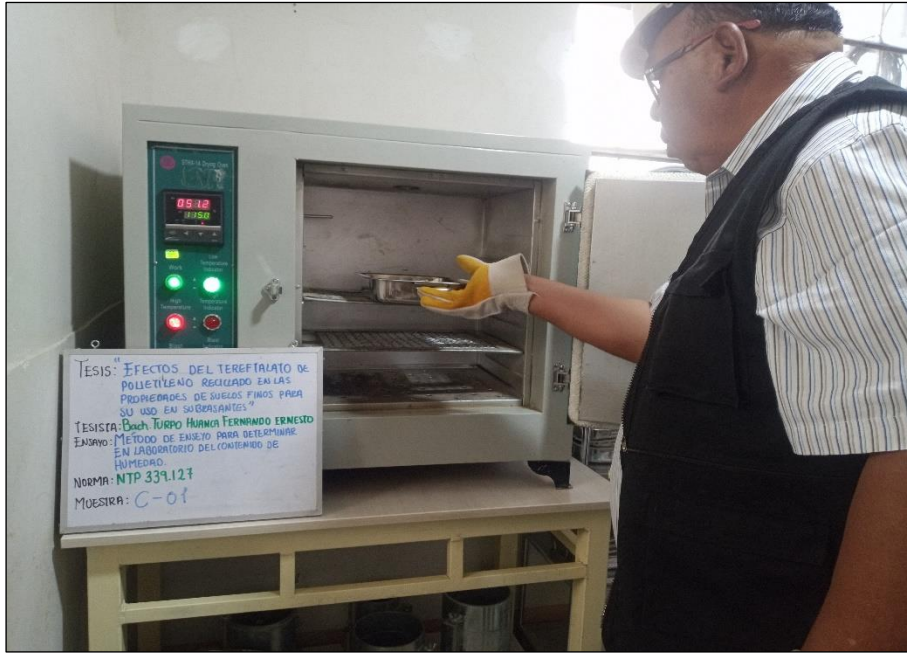
Fotografía 1. Ensayo de contenido de humedad para las muestras de suelo.
