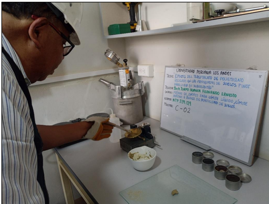
Fotografía 6. Realización de los ensayos de límites de consistencia con la cuchara de Casagrande.
