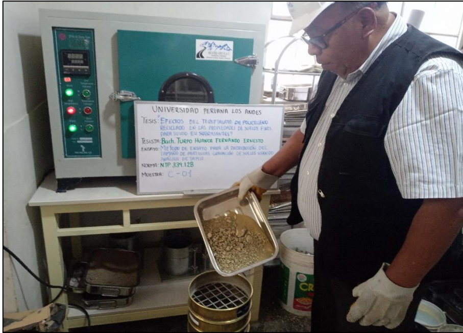
Fotografía 3. Análisis granulométrico para muestra de suelo natural.
