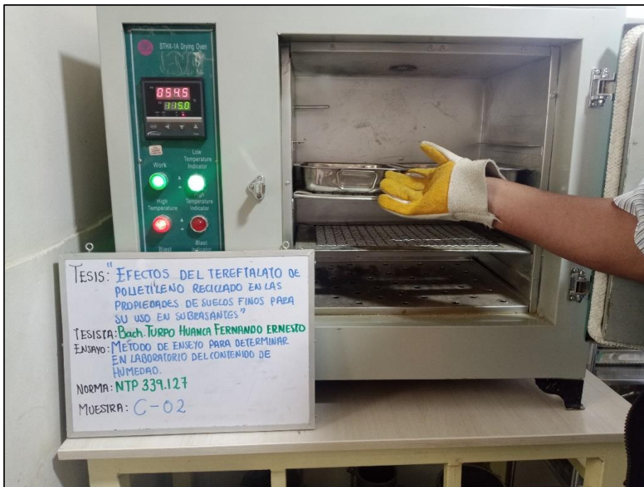
Fotografía 2. Ensayo de contenido de humedad para muestras alteradas de suelo.
