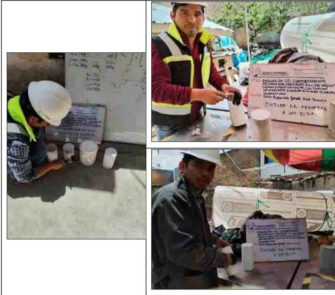
**Fotografía N° 9:** Pintado de las probetas con pintura intumescente.
