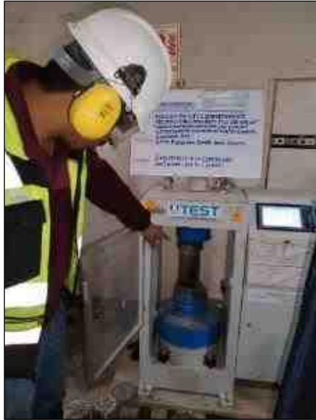
Figura 19. Ensayo de rotura de probetas
