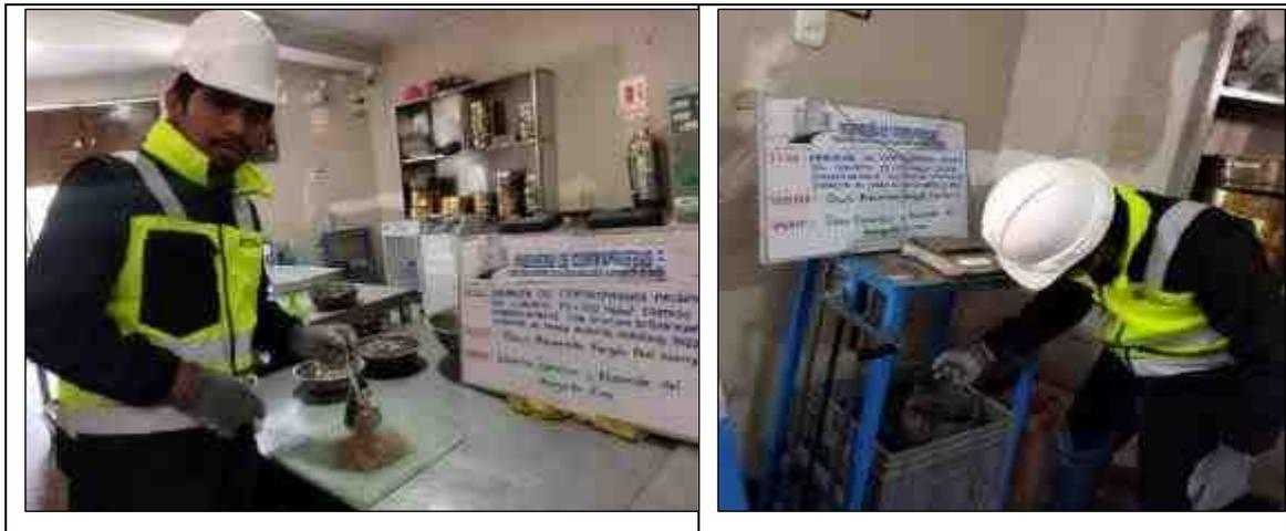
**Fotografía N° 1:** Ensayo de Gravedad específica y absorción de los agregados. NTP 400.022
