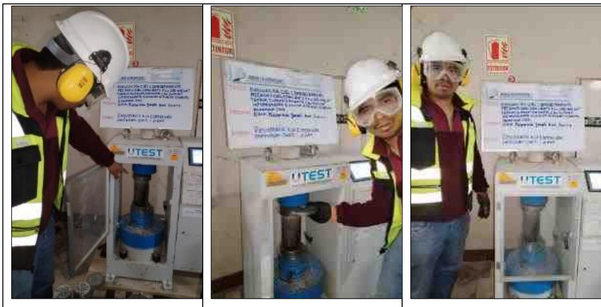
**Fotografía N° 15:** Ensayo de Resistencia a la compresión de la muestra con pintura intumescente sometidas a la simulación de incendio a temperaturas de 300°C, 500°C y 700°C, a la edad 21 días, según referencia de la Norma NTP 339.034
