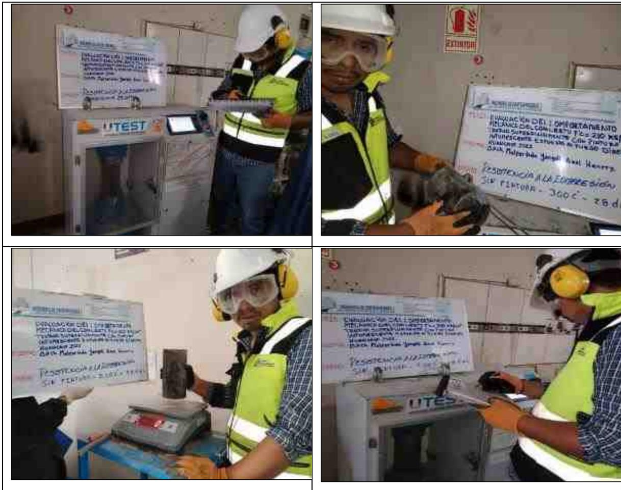
**Fotografía N° 13:** Ensayo de Resistencia a la compresión de la muestra convencional y muestras con pintura intumescente sometidas a la simulación de incendio a temperaturas de 300°C, 500°C y 700°C, a la edad 28 días, según referencia de la Norma NTP 339.034
