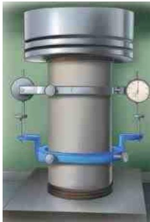
Figura 20. Ensayo para la evaluación del módulo de elasticidad con ayuda de anillos con micrómetro
