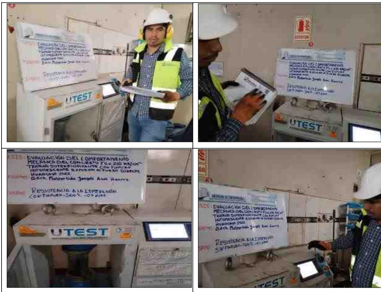
**Fotografía N° 11:** Ensayo de Resistencia a la compresión de la muestra convencional y muestras con pintura intumescente sometidas a la simulación de incendio a temperaturas de 300°C, 500°C y 700°C, a la edad 07 días, según referencia de la Norma NTP 339.034
