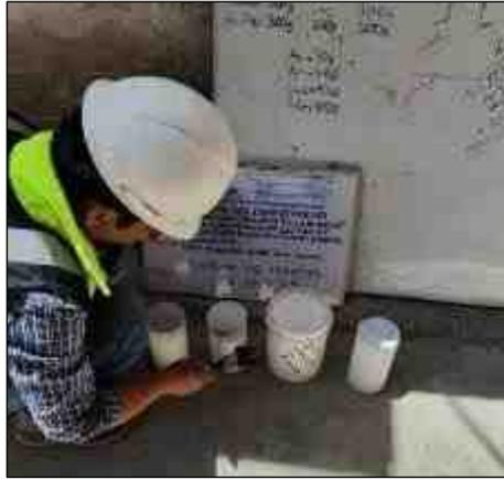
Figura 17. Pintado de probetas
