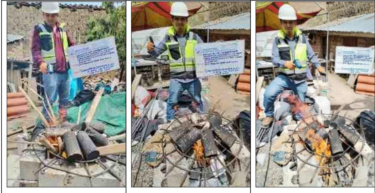
**Fotografía N° 10:** Simulación de incendio a las probetas con pintura intumescente a las temperaturas registradas de 300 °C, 500°C y 700°C.
