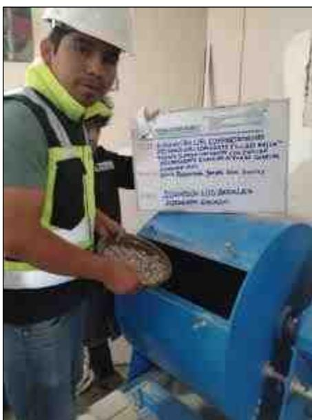
**Fotografía N° 6:** Ensayo de Abrasión los ángeles del agregado grueso. ASTM C131/C131M
