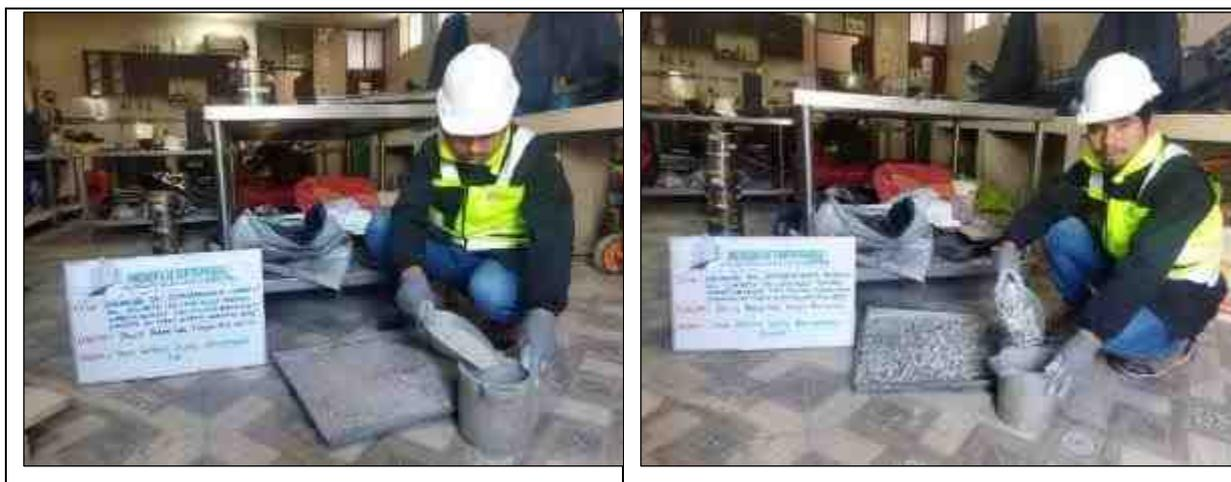
**Fotografía N° 5:** Ensayo de Peso Unitario Suelto de los agregados. NTP 400.017
