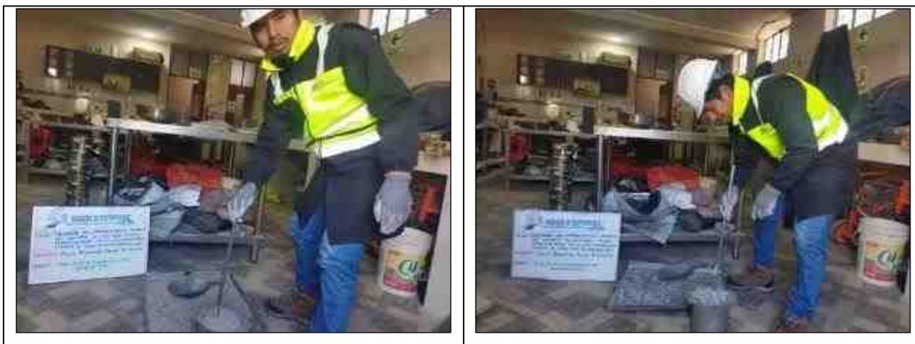
**Fotografía N° 3:** Ensayo de Peso Unitario Compactado de los agregados. NTP 400.017
