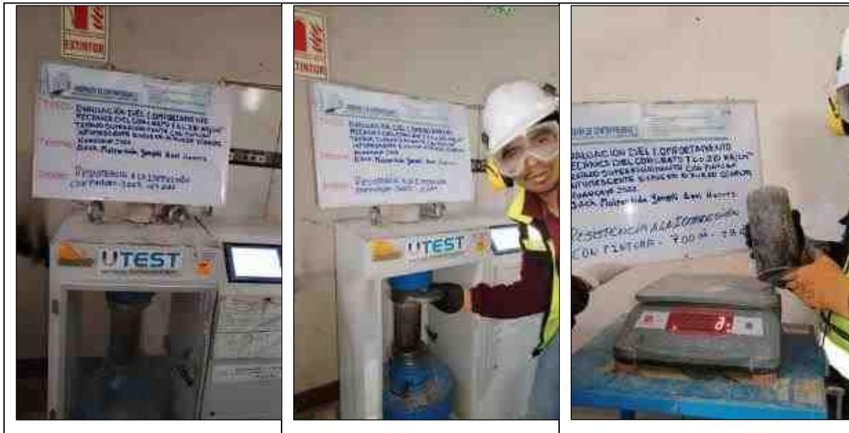
**Fotografía N° 14:** Ensayo de Resistencia a la compresión de la muestra con pintura intumescente sometidas a la simulación de incendio a temperaturas de 300°C, 500°C y 700°C, a la edad 07 días, según referencia de la Norma NTP 339.034
