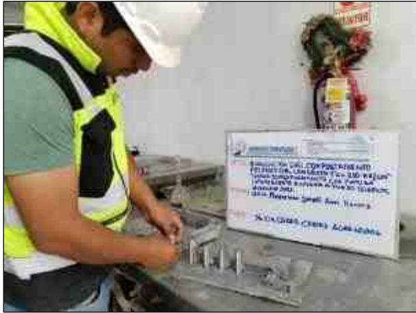
**Fotografía N° 7:** Ensayo de partículas chatas y alargadas. ASTM D4791
