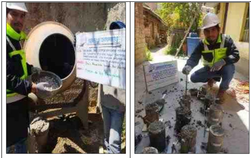
**Fotografía N° 8:** Mezclado de materiales para la obtención del concreto.
