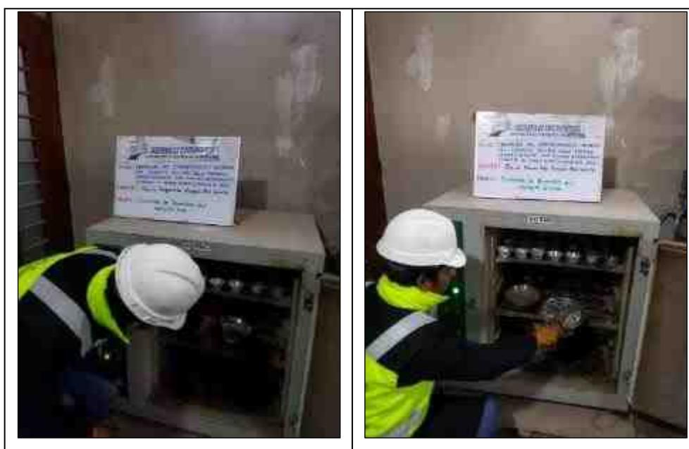
**Fotografía N° 4:** Ensayo de Contenido de Humedad de los agregados. NTP 339.185
