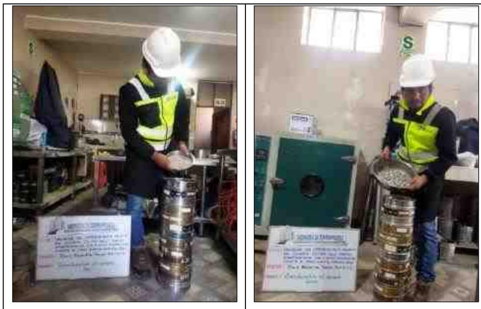
**Fotografía N° 2:** Ensayo de Granulometría de los agregados. NTP 400.012
