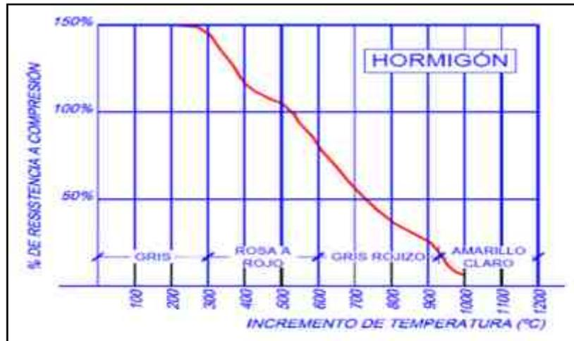
**Figura 11:** Incrementos de la temperatura y causas de la resistencia a compresión
