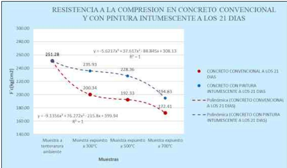
Figura 23: Comparativa de variación de resistencia a compresión del concreto convencional aplicando pintura intumescente después 21 días
