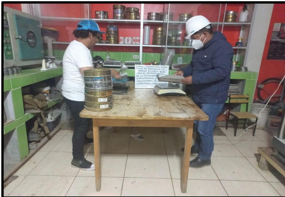
Fotografía N° 6. Granulometria de agregado fino (Arena Chancada – Norma ASTM C136)
