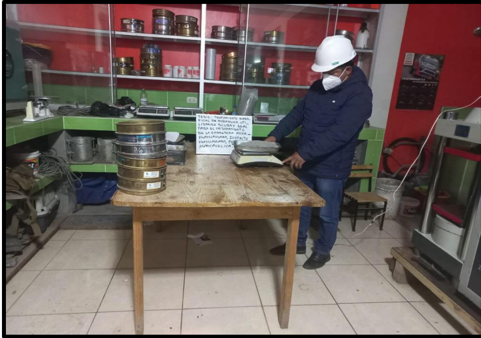
Fotografía N° 5. Granulometria de agregado fino (Arena Chancada – Norma ASTM C136)
