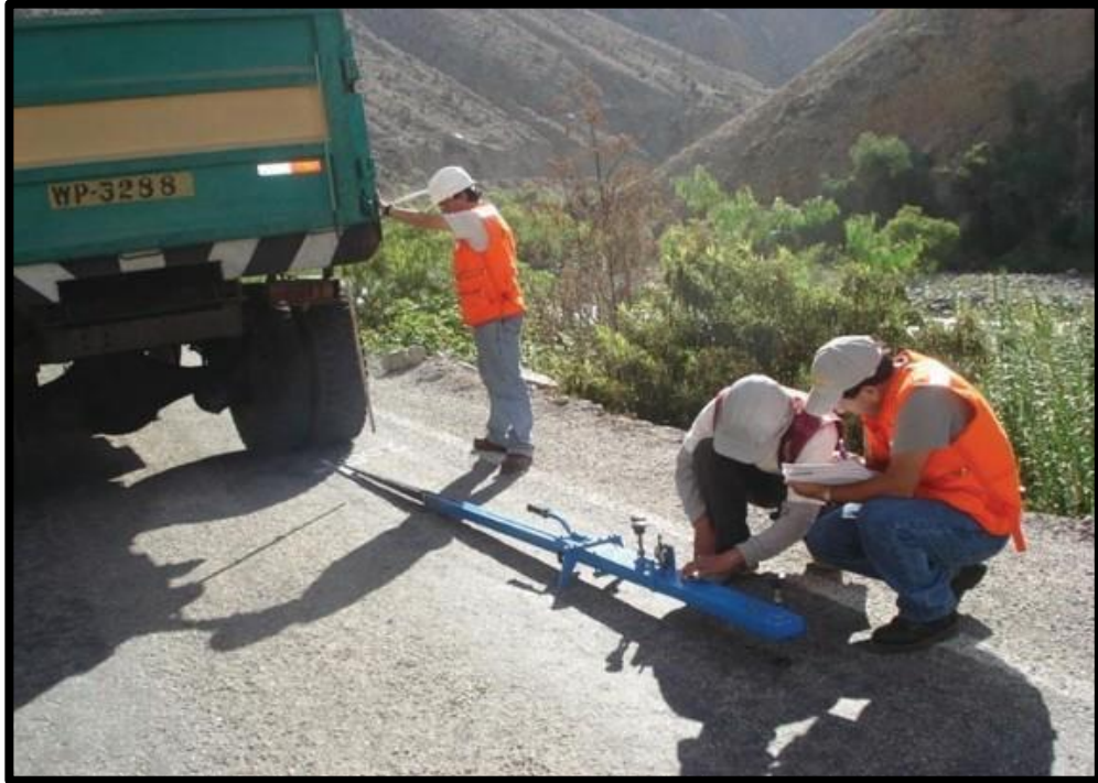
Fotografía N° 15. Medida de la deflexión empleando la Viga Benkelman (MTC E-1002)
