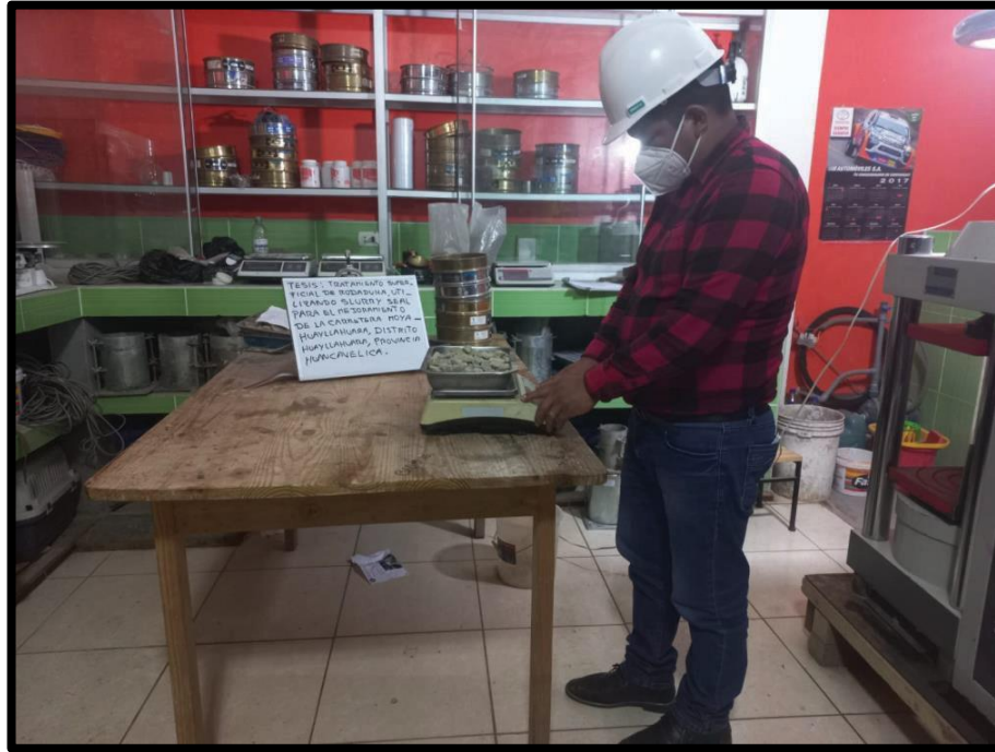
Fotografía N° 1. Ensayo de peso específico de absorción del agregado grueso y agregado fino (ASTM C128-15)
