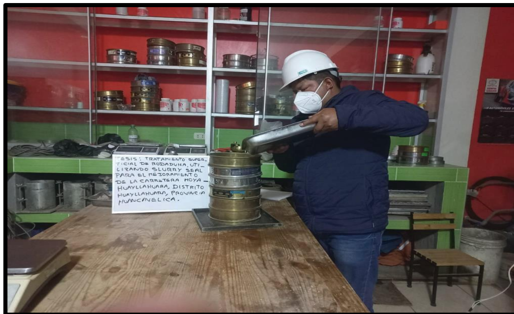
Fotografía N° 8. Combinación granulométrica del agregado fino teórico y físico (Arena Chancada – Norma ASTM C136)
