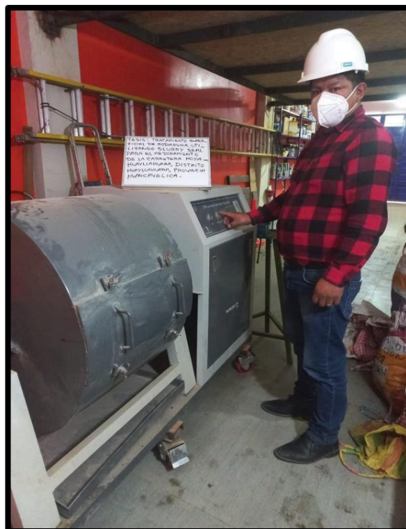
Fotografía N° 4. Ensayo Abrasion los ángeles (ASTM C131)
