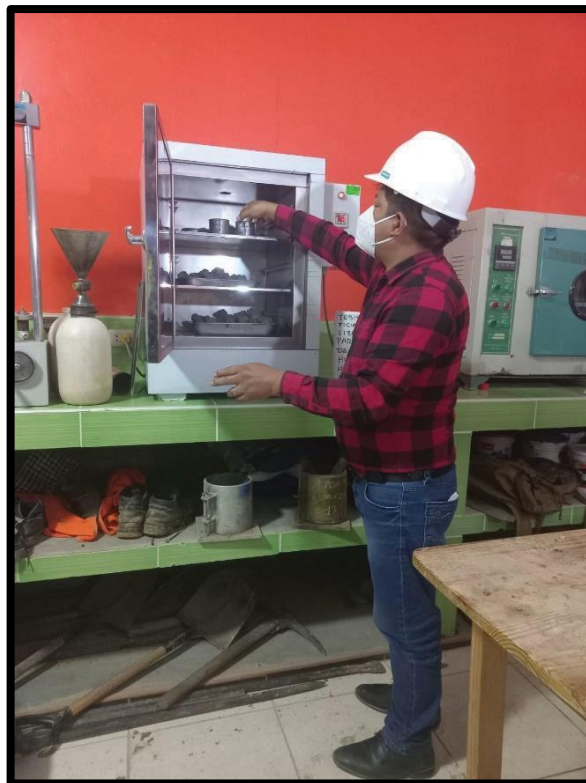
Fotografía N° 10. Peso específico y absorción del agregado fino (ASTM C128-15)
