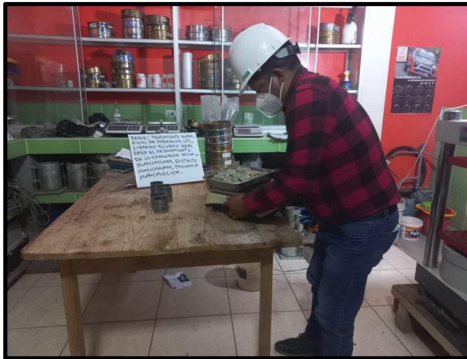
Fotografía N° 2. Ensayo de peso específico de absorción del agregado grueso y agregado fino (ASTM C128-15)
