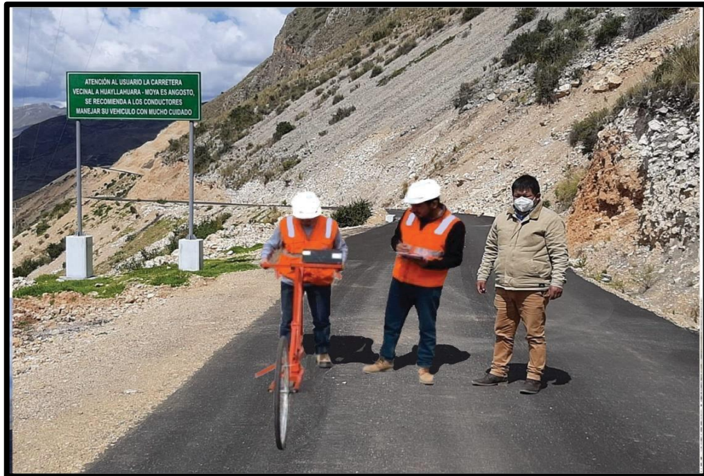
Fotografía N° 13. Determinación de rugosidad por el método de MERLIN (IRI ASTM E 1926) km 0+760 al km 0+960 carretera Moya Huayllahuara
