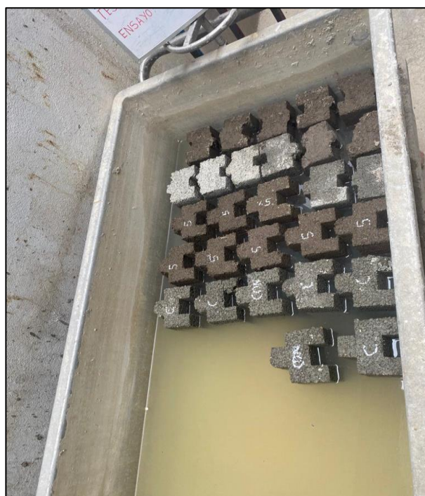
Fotografía N°14: Almacenamiento y curado de los ladrillos tipo lego Fuente: Elaborado por (RAMOS PALOMINO)
