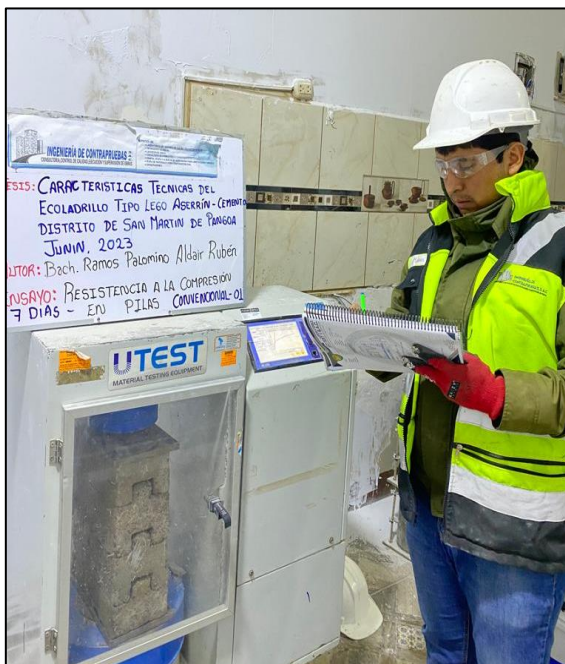
Fotografía N°31: Ensayo de resistencia a la compresión en base a la norma técnica peruana 399.605 Fuente: Elaborado por (RAMOS PALOMINO)
