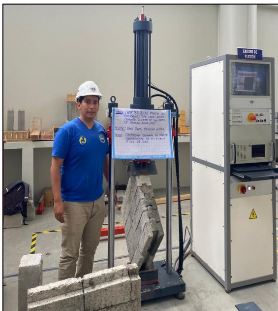
Fotografía N°43: Ensayo de resistencia a la compresión diagonal en base a la norma técnica peruana 399.621
