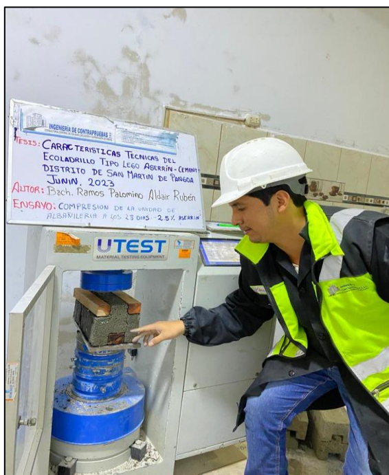
Fotografía N°27: Ensayo de resistencia a la compresión en base a la norma técnica peruana 399.604
