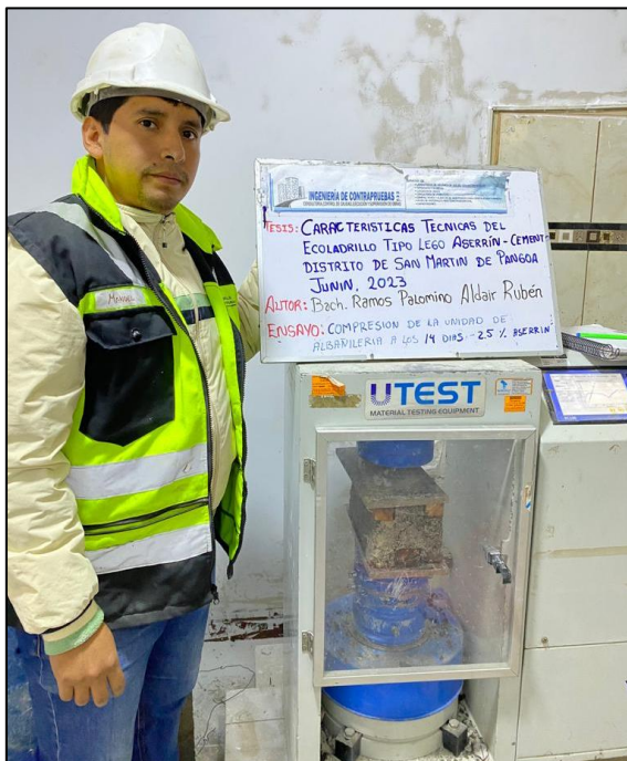
Fotografía N°26: Ensayo de resistencia a la compresión en base a la norma técnica peruana 399.604 Fuente: Elaborado por (RAMOS PALOMINO)
