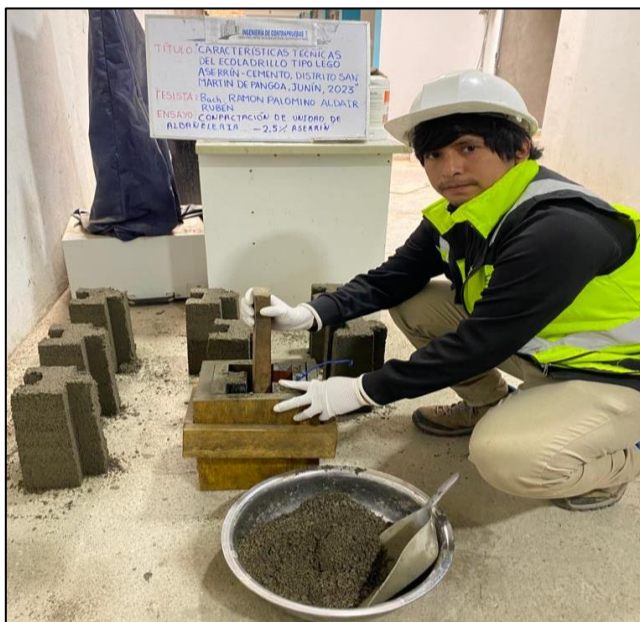
Fotografía N°11: Compactación del ecoladrillo tipo lego con la adición al 2.5% de aserrín mineralizado.
