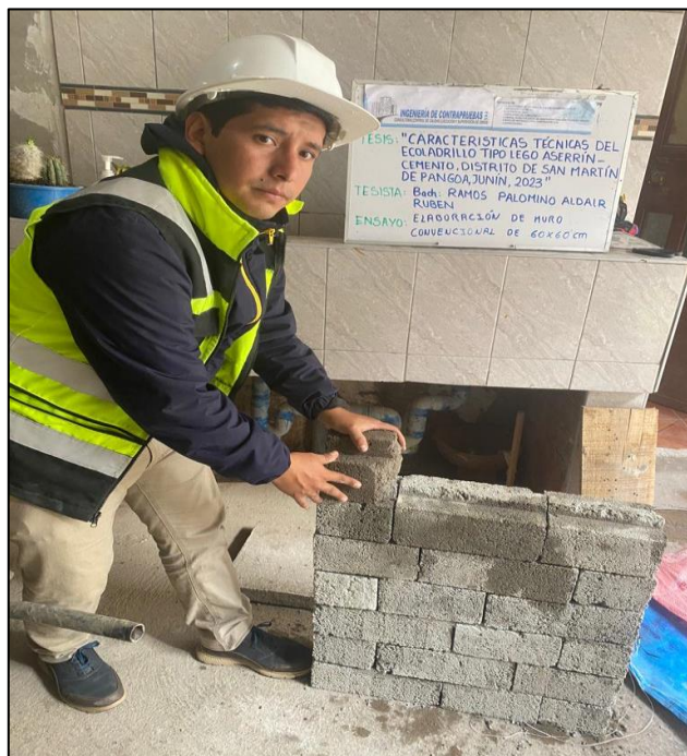
Fotografía N°15: Elaboración de muro de 0.60m x 0.60 m con la adición al 0% de aserrín mineralizado.
