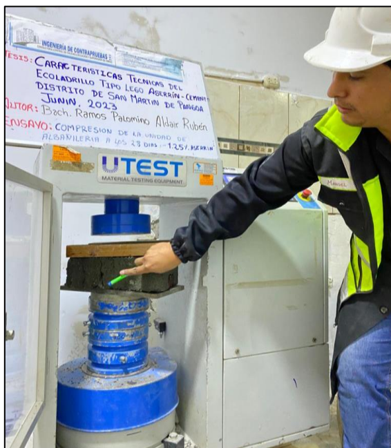
Fotografía N°24: Ensayo de resistencia a la compresión en base a la norma técnica peruana 399.604 Fuente: Elaborado por (RAMOS PALOMINO)
