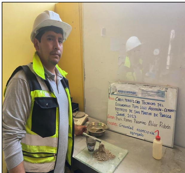
Fotografía N°03: Ensayo de peso específico y absorción del agregado fino, en base a la Norma Técnica Peruana 339.187 Fuente: Elaborado por (RAMOS PALOMINO)
