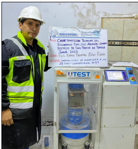
Fotografía N°21: Ensayo de resistencia a la compresión en base a la norma técnica peruana 399.604 Fuente: Elaborado por (RAMOS PALOMINO)
