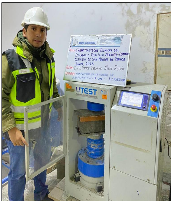
Fotografía N°34: Ensayo de resistencia a la compresión en base a la norma técnica peruana 399.605 Fuente: Elaborado por (RAMOS PALOMINO)
