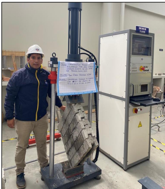
Fotografía N°45: Ensayo de resistencia a la compresión diagonal en base a la norma técnica peruana 399.621
