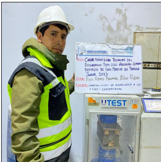
Fotografía N°19: Ensayo de resistencia a la compresión en base a la norma técnica peruana 399.604
