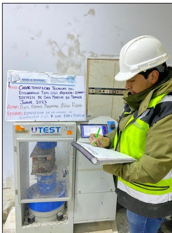
Fotografía N°22: Ensayo de resistencia a la compresión en base a la norma técnica peruana 399.604 Fuente: Elaborado por (RAMOS PALOMINO)
