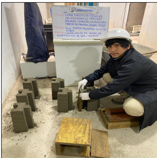
Fotografía N°10: Compactación del ecoladrillo tipo lego con la adición al 1.25% de aserrín mineralizado.
