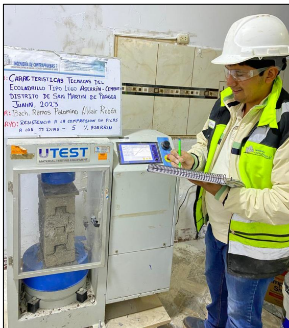
Fotografía N°41: Ensayo de resistencia a la compresión en base a la norma técnica peruana 399.605 Fuente: Elaborado por (RAMOS PALOMINO)
