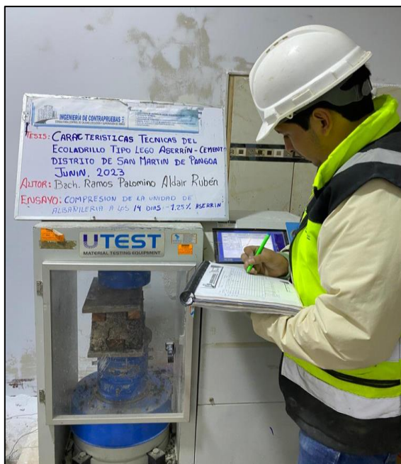
Fotografía N°23: Ensayo de resistencia a la compresión en base a la norma técnica peruana 399.604 Fuente: Elaborado por (RAMOS PALOMINO)
