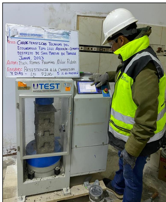
Fotografía N°40: Ensayo de resistencia a la compresión en base a la norma técnica peruana 399.605 Fuente: Elaborado por (RAMOS PALOMINO)
