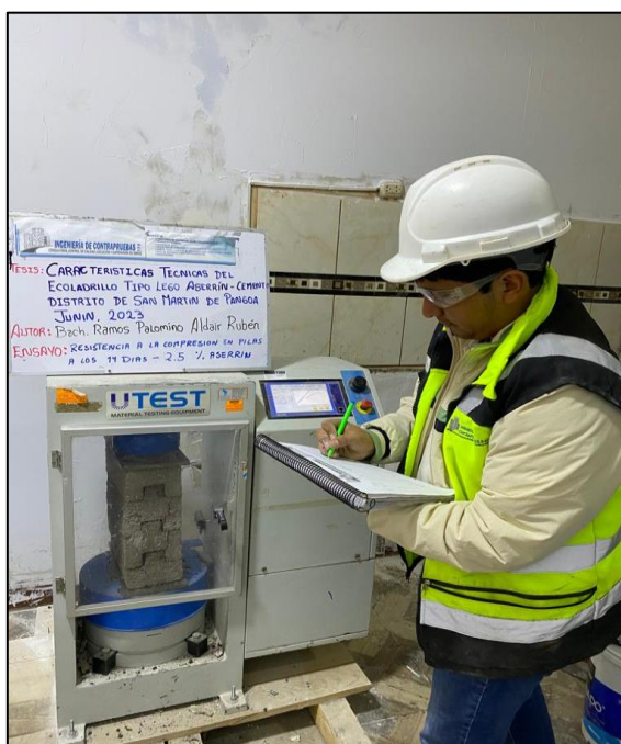
Fotografía N°38: Ensayo de resistencia a la compresión en base a la norma técnica peruana 399.605 Fuente: Elaborado por (RAMOS PALOMINO)
