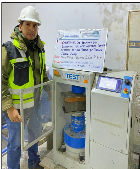
Fotografía N°28: Ensayo de resistencia a la compresión en base a la norma técnica peruana 399.604
