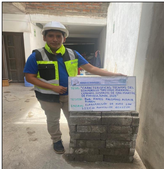
Fotografía N°16: Elaboración de muro de 0.60m x 0.60 m con la adición al 1.25% de aserrín mineralizado.
