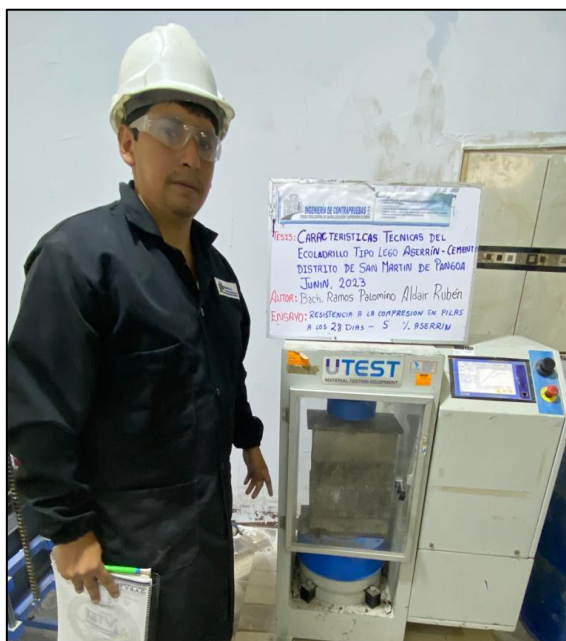
Fotografía N°42: Ensayo de resistencia a la compresión en base a la norma técnica peruana 399.605 Fuente: Elaborado por (RAMOS PALOMINO)
