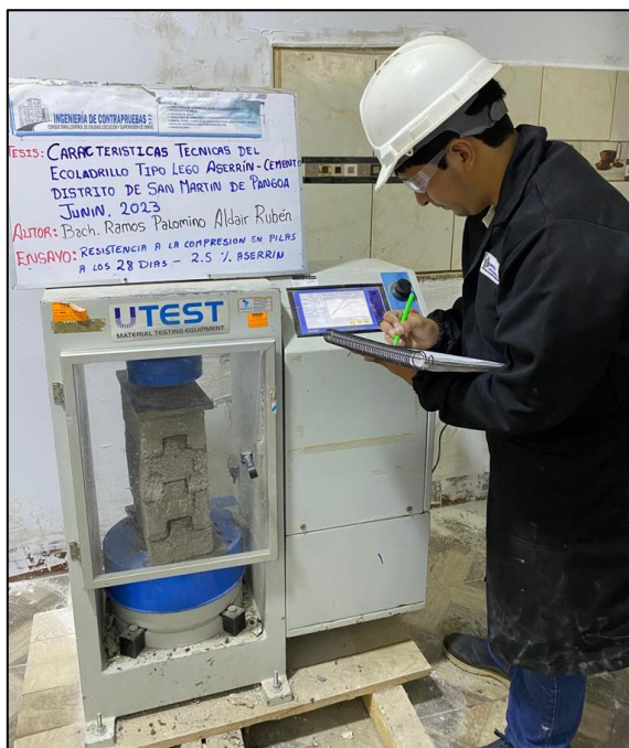
Fotografía N°39: Ensayo de resistencia a la compresión en base a la norma técnica peruana 399.605 Fuente: Elaborado por (RAMOS PALOMINO)
