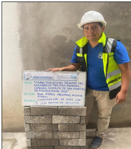
Fotografía N°18: Elaboración de muro de 0.60m x 0.60 m con la adición al 5% de aserrín mineralizado.
