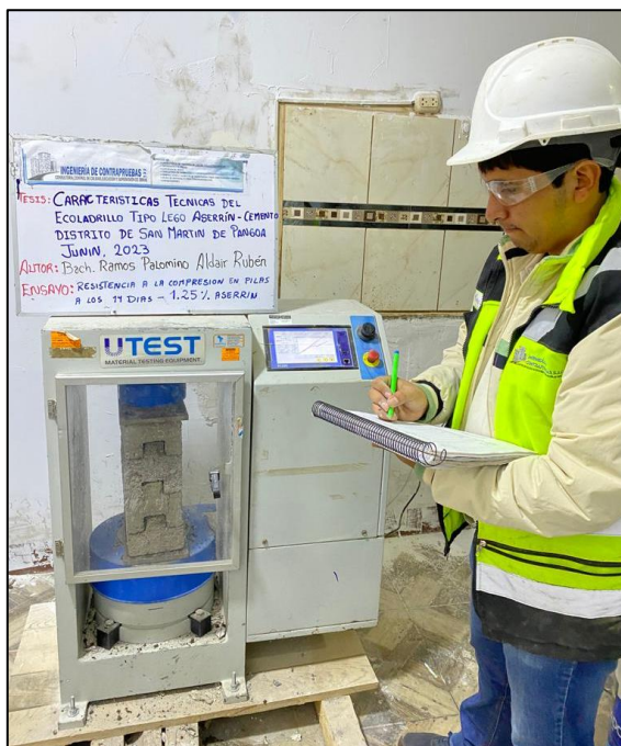
Fotografía N°35: Ensayo de resistencia a la compresión en base a la norma técnica peruana 399.605 Fuente: Elaborado por (RAMOS PALOMINO)
