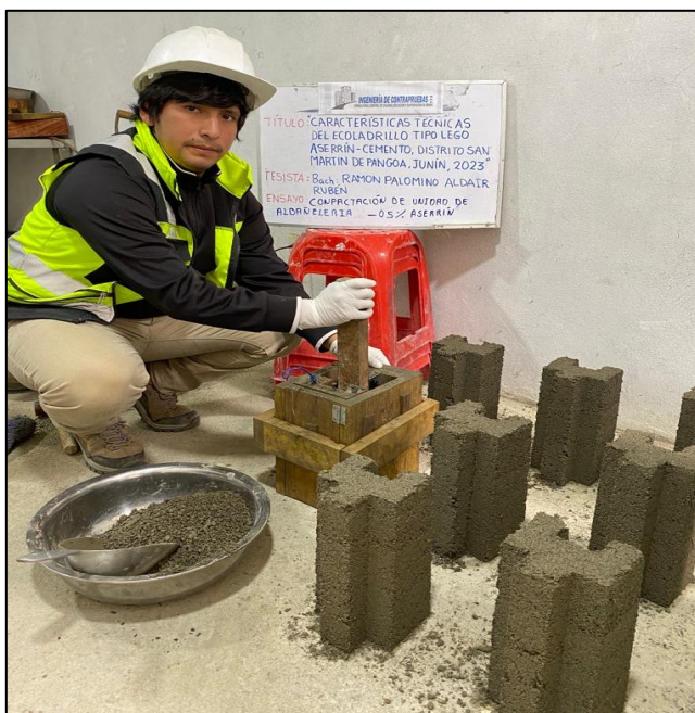
Fotografía N°12: Compactación del ecoladrillo tipo lego con la adición al 5% de aserrín mineralizado.
