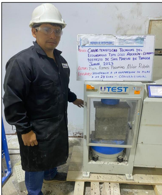
Fotografía N°33: Ensayo de resistencia a la compresión en base a la norma técnica peruana 399.605 Fuente: Elaborado por (RAMOS PALOMINO)
