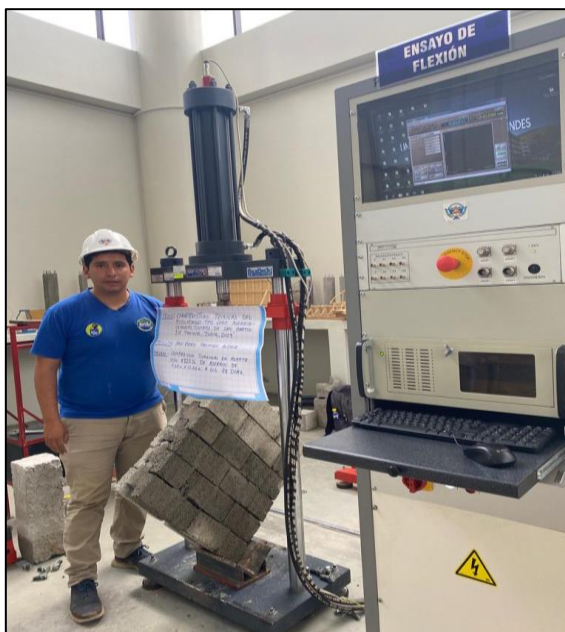
Fotografía N°44: Ensayo de resistencia a la compresión diagonal en base a la norma técnica peruana 399.621
