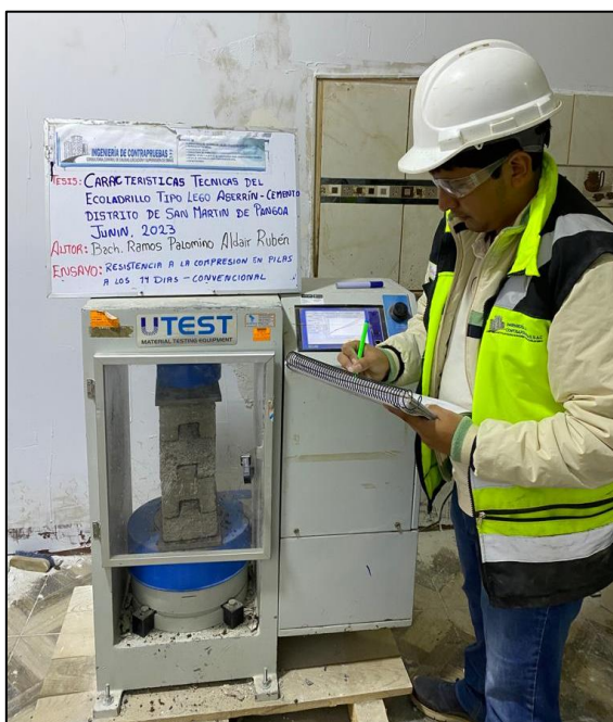
Fotografía N°32: Ensayo de resistencia a la compresión en base a la norma técnica peruana 399.605 Fuente: Elaborado por (RAMOS PALOMINO)
