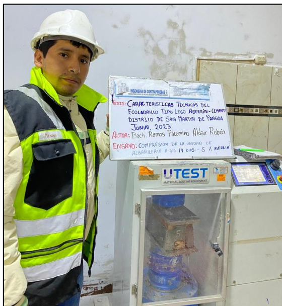
Fotografía N°29: Ensayo de resistencia a la compresión en base a la norma técnica peruana 399.604 Fuente: Elaborado por (RAMOS PALOMINO)
