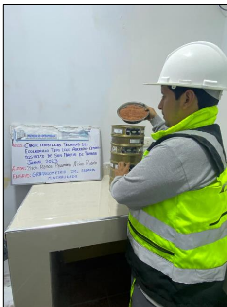
Fotografía N°02: Ensayo de Análisis Granulométrico del aserrín mineralizado, en base a la Norma Técnica Peruana 400.012 Fuente: Elaborado por (RAMOS PALOMINO)
