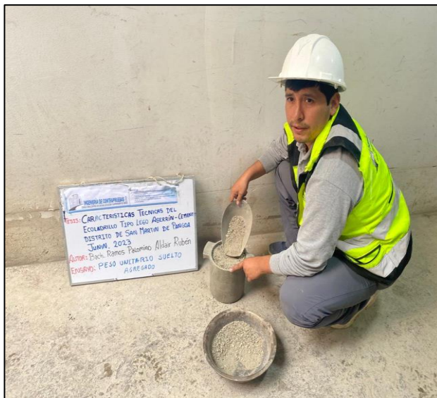
Fotografía N°05: Ensayo para determinar el peso unitario suelto del agregado fino, en base a la Norma Técnica Peruana 400.017
