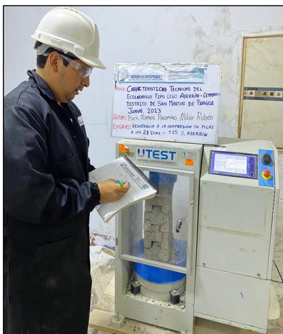
Fotografía N°36: Ensayo de resistencia a la compresión en base a la norma técnica peruana 399.605 Fuente: Elaborado por (RAMOS PALOMINO)
