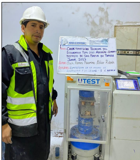
Fotografía N°30: Ensayo de resistencia a la compresión en base a la norma técnica peruana 399.604 Fuente: Elaborado por (RAMOS PALOMINO)
