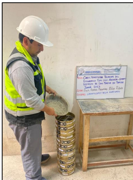
Fotografía N°01: Ensayo de Análisis Granulométrico del agregado fino, en base a la Norma Técnica Peruana 400.012 Fuente: Elaborado por (RAMOS PALOMINO).
