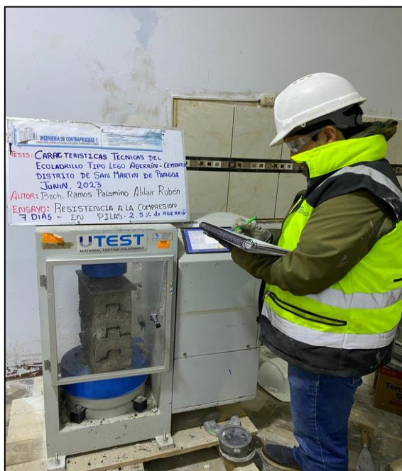
Fotografía N°37: Ensayo de resistencia a la compresión en base a la norma técnica peruana 399.605 Fuente: Elaborado por (RAMOS PALOMINO)
