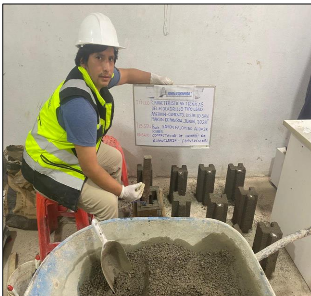
Fotografía N°09: Compactación del ecoladrillo tipo lego con la adición al 0% de aserrín mineralizado.
