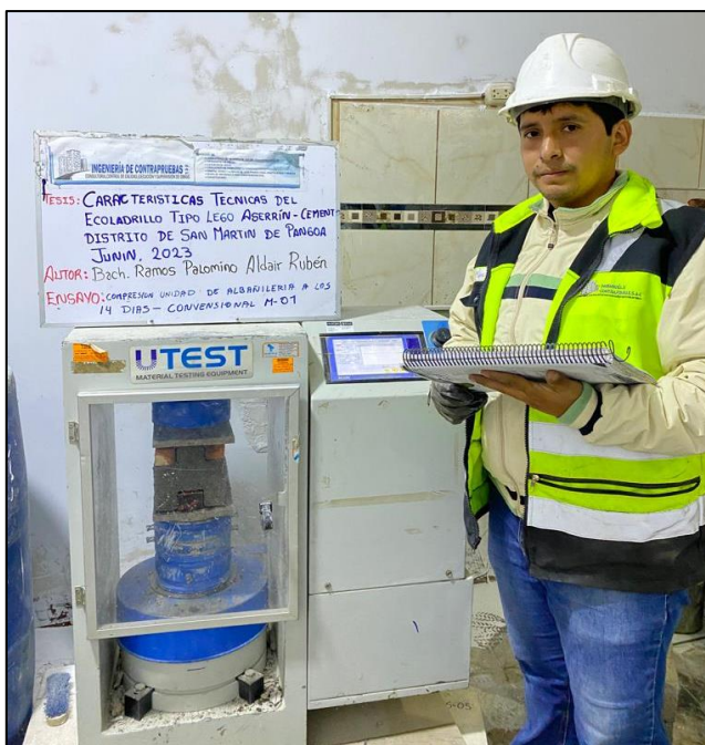
Fotografía N°20: Ensayo de resistencia a la compresión en base a la norma técnica peruana 399.604
