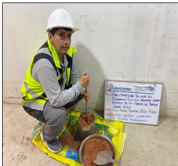
Fotografía N°08: Ensayo para determinar el peso unitario compactado del aserrín mineralizado, en base a la Norma Técnica Peruana 400.017
