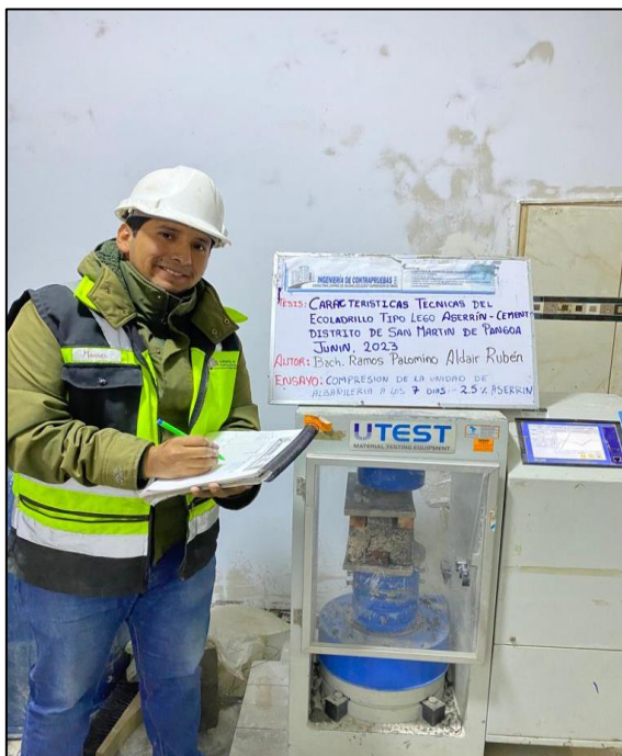
Fotografía N°25: Ensayo de resistencia a la compresión en base a la norma técnica peruana 399.604 Fuente: Elaborado por (RAMOS PALOMINO)
