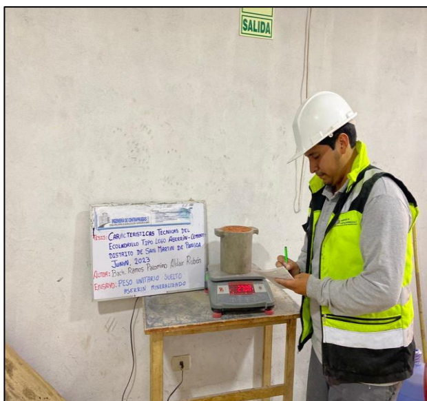
Fotografía N°06: Ensayo para determinar el peso unitario suelto del aserrín mineralizado, en base a la Norma Técnica Peruana 400.017
