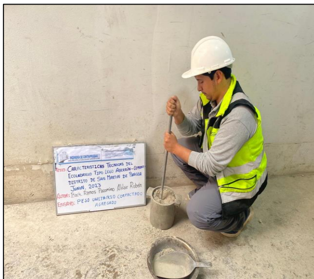
Fotografía N°07: Ensayo para determinar el peso unitario compactado del agregado fino, en base a la Norma Técnica Peruana 400.017
