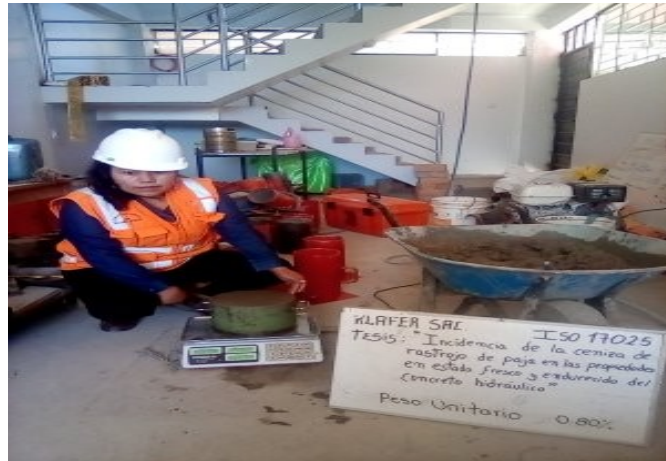
Se aprecia el ensayo de peso unitario del concreto a un 8 % sin adicionar ceniza de rastrojo de paja, a una edad de 7 días
