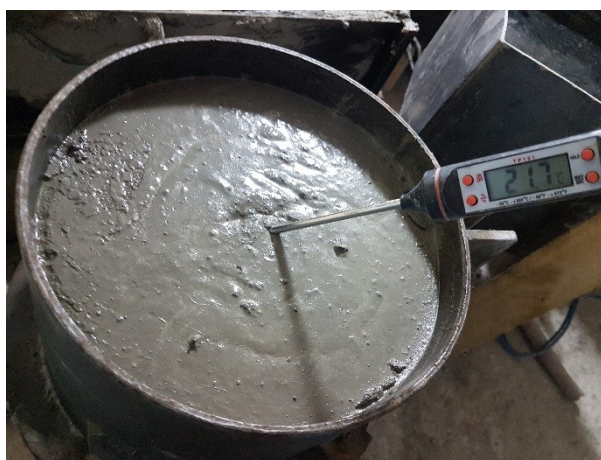
Figura 4: Vista general del control de temperatura del concreto
