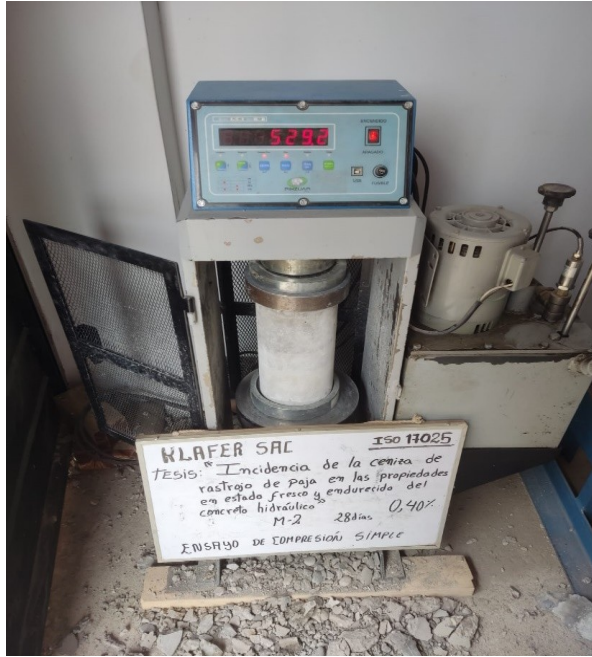
Se aprecia la rotura de probeta del ensayo a compresión simple del concreto aun 4% con adición de ceniza de rastrojo de paja, a una edad de 28 días
