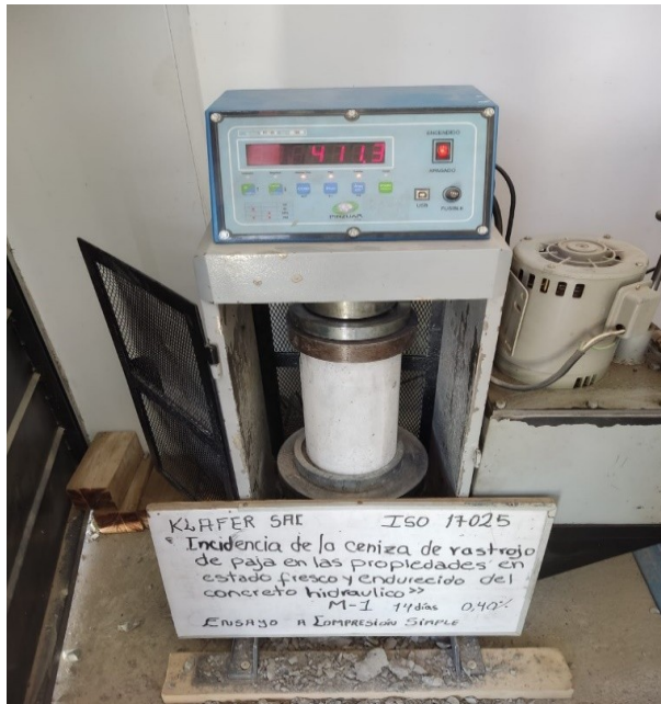
Se aprecia la rotura de probeta del ensayo a compresión simple del concreto aun 4% con adición de ceniza de rastrojo de paja, a una edad de 14 días
