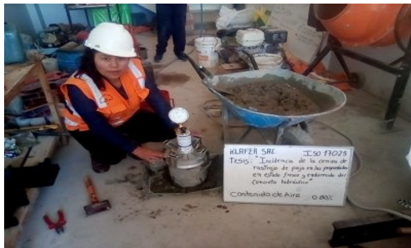
Se aprecia el ensayo de peso unitario del concreto a un 8 % sin adicionar ceniza de rastrojo de paja, a una edad de 7 días
