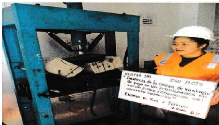
La imagen muestra el proceso de ensayo de resistencia a flexión en viga a la edad de 28 días, para la muestra patrón.
