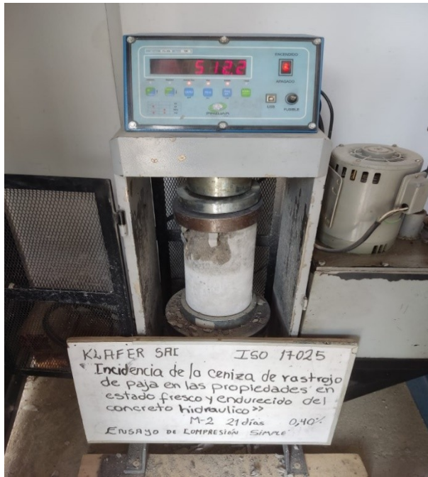
Se aprecia la rotura de probeta del ensayo a compresión simple del concreto aun 4% con adición de ceniza de rastrojo de paja, a una edad de 21 días
