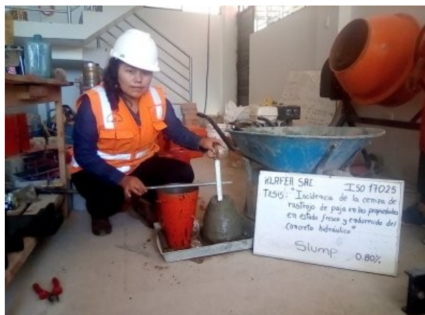
Figura 6: Ensayo de asentamiento del concreto
