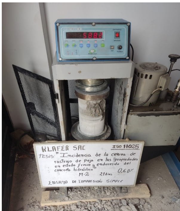
Se aprecia la rotura de probeta del ensayo a compresión simple del concreto aun 6% con adición de ceniza de rastrojo de paja, a una edad de 21 días
