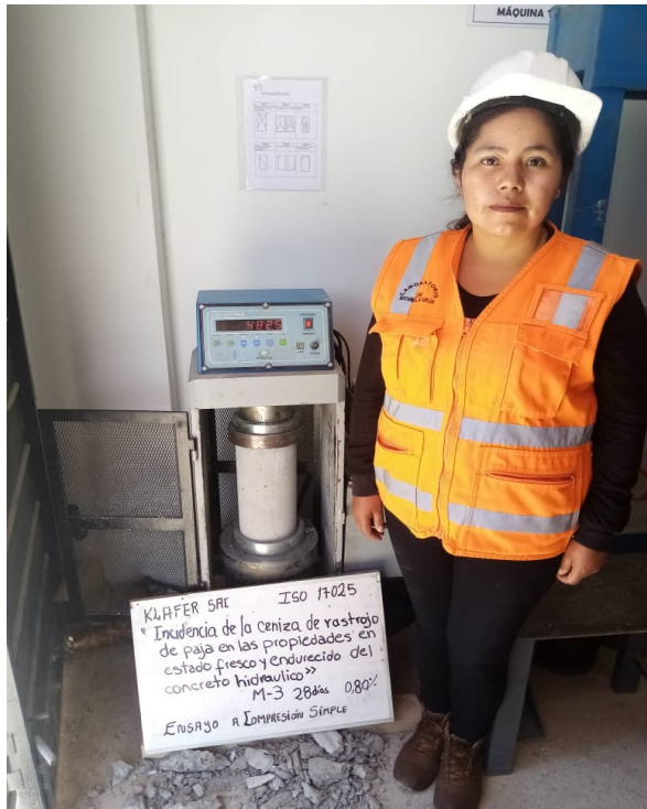
Se aprecia la rotura de probeta del ensayo a compresión simple del concreto aun 8% con adición de ceniza de rastrojo de paja, a una edad de 28 días
