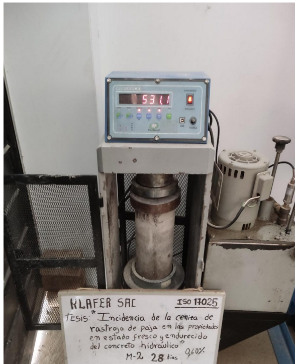
Se aprecia la rotura de probeta del ensayo a compresión simple del concreto aun 6% con adición de ceniza de rastrojo de paja, a una edad de 28 días
