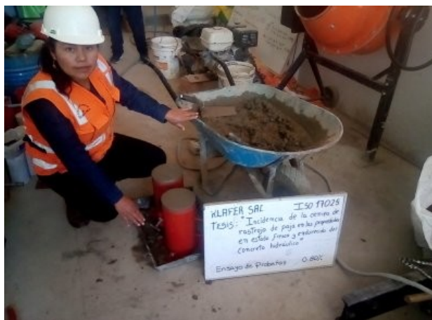
Figura 3: Elaboración del concreto para probetas
