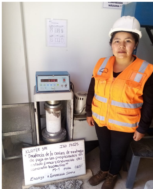
Se aprecia la rotura de probeta del ensayo a compresión simple del concreto aun 6% con adición de ceniza de rastrojo de paja, a una edad de 14 días
