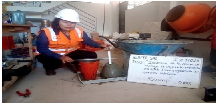
Se aprecia el ensayo de slump o asentamiento del concreto a un 8 % sin adicionar ceniza de rastrojo de paja, a una edad de 7 días
