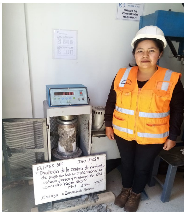
Se aprecia la rotura de probeta del ensayo a compresión simple del concreto aun 2% con adición de ceniza de rastrojo de paja, a una edad de 21 días
