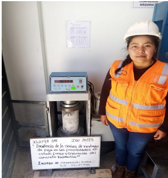
Se aprecia la rotura de probeta del ensayo a compresión simple del concreto aun 0% sin adición de ceniza de rastrojo de paja, a una edad de 21 días
