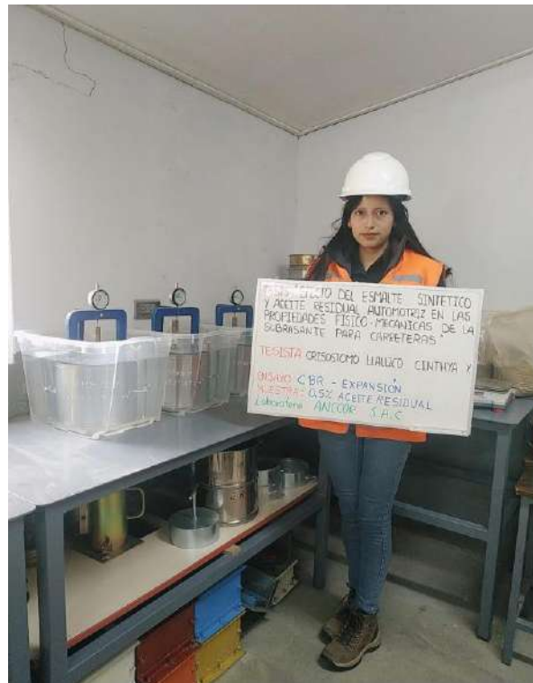
Figura 3.12. Ensayo de expansión del suelo CBR, con incorporación de ARA.
