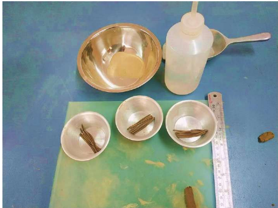
Figura 3.10. Prueba de limite plástico.
