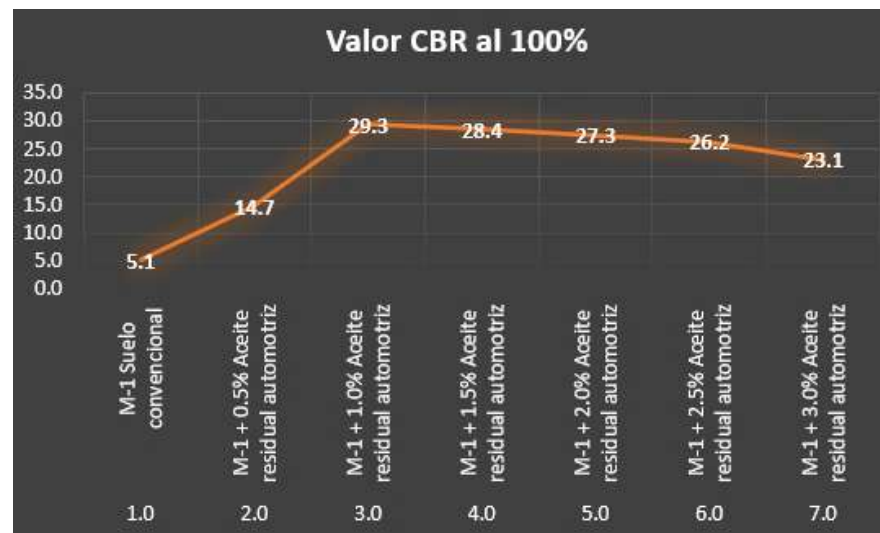
Figura 4.21. Diagrama de proyección de CBR de las muestras ensayadas.
