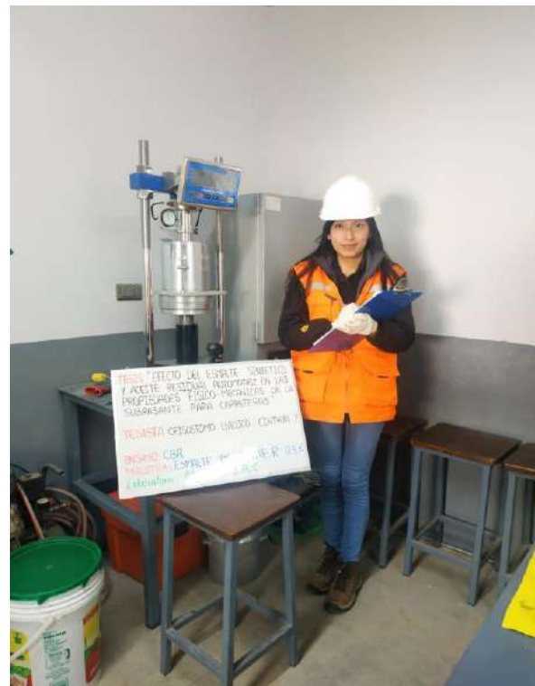
Figura 3.13. Ensayo de CBR, con incorporación de ARA.
