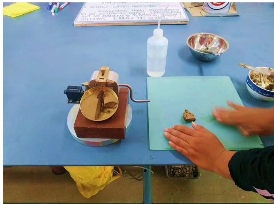
Figura 3.9. Prueba del límite líquido.
