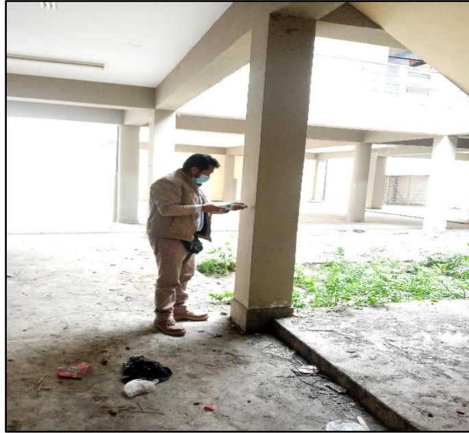
Figura 30 Ensayo de esclerometría
