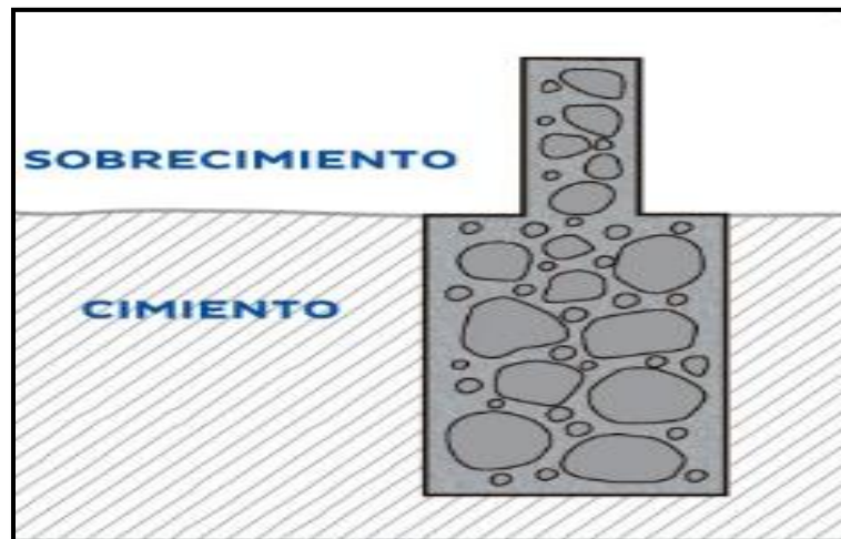
Figura 4 Sobrecimiento Tomado de: Aceros Arequipa S.A.C.
