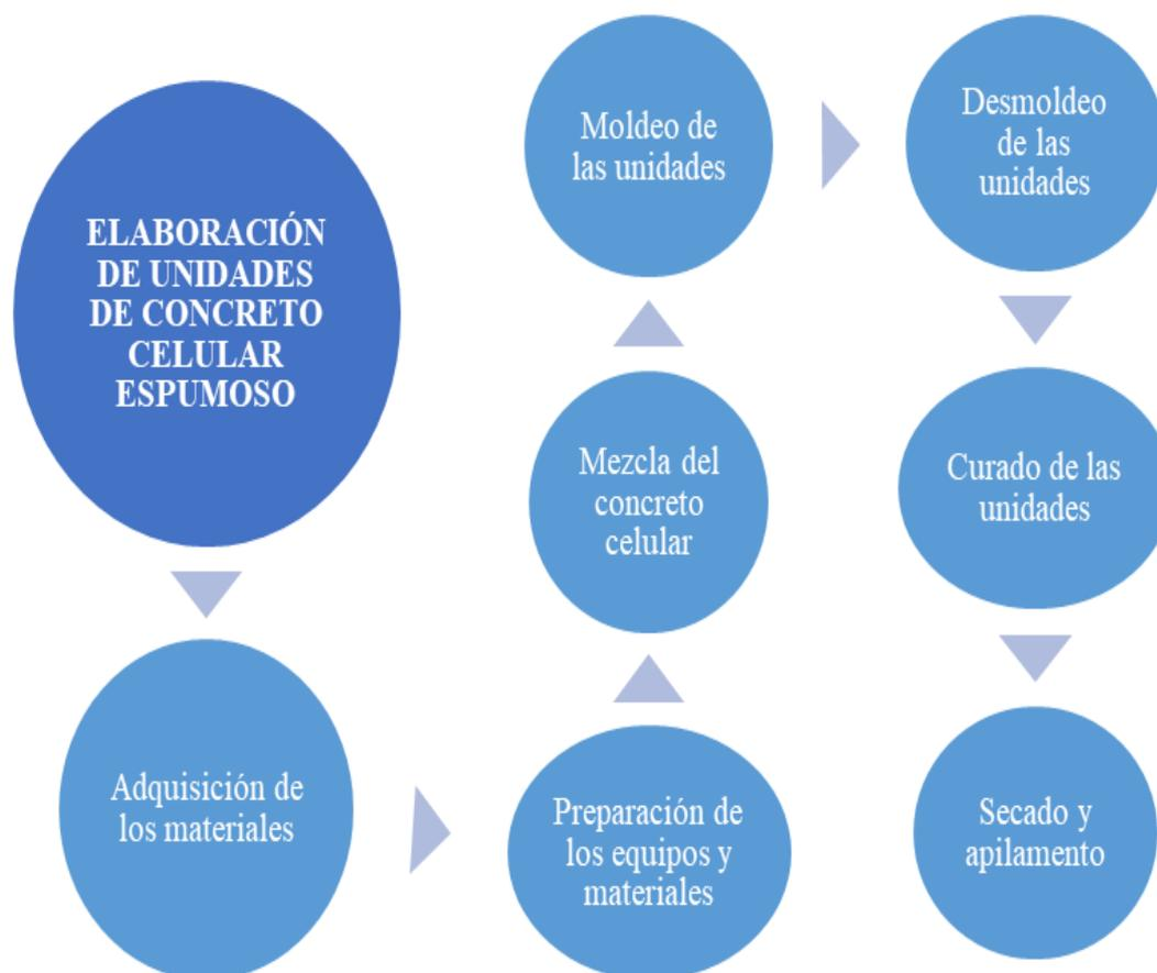
*Figura 5.15: Gráfico de secuencia del proceso de fabricación*
