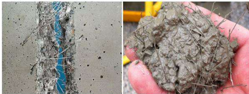
Figura 5. Fibras de acero Fiber CHO 80/60 en la mezcla del concreto
