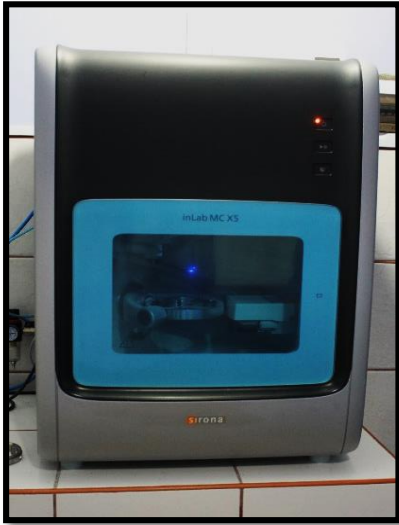
FIGURA 17 Fresado del disco de Zirconio
