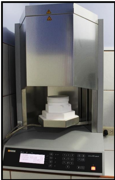
FIGURA 19 Colocación del disco en el horno de Sinterizado
