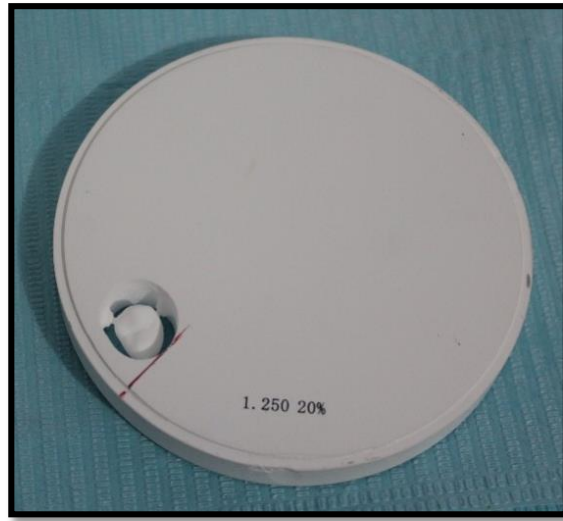
FIGURA 18 Pieza tallada pre-sinterizada.
