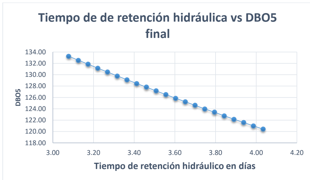
Figura 6. Tiempo de retención hidráulica vs DBO 5 final en laguna facultativa.
