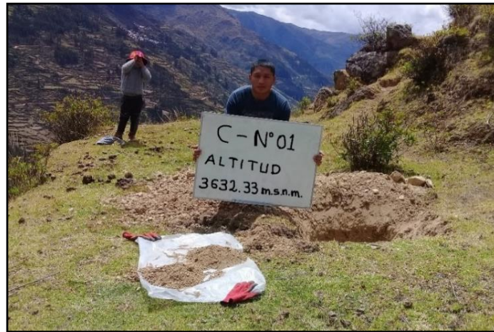
Fotografía 5. Toma de muestra de la calicata N°01.
