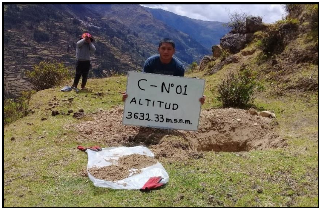
Fotografía N° 04. Toma de muestras de la calicata.
